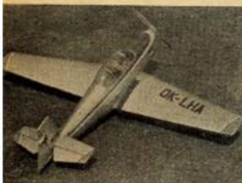
Model pro osobní (combat) konstrukce J. Kartosa z Brna. Rozpětí 900 mm, plocha 16,65 dm 2 , váha 540 g, motor MVVS 2,5 D, rychlost 95 km/h. Postavil J. Čudák, Novotného 26, Brno.
