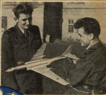
► Miniaturní volně létající polomaketa, kterou postavil Tomáš Pelíkán z KA Praha. Data: rozpětí 600 mm, délka 550 mm, celková plocha 14 dm<sup>2</sup>, profil obou křídel snížený Clark Y. Váha 180 g, motor Buš 0,5 ccm, vrtule z Novoduru Ø 160 mm, stoupání 120 mm.
