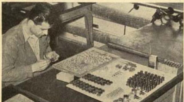
celým výrobním postupem motorek „Vltavan“. Zastihl jsem jej v diskusi s mechanikem M. Vobeřillem — jak zlepšit postup opracování zadního vlnku s rotačním šoupátkem pro motorky 2,5 cm.
