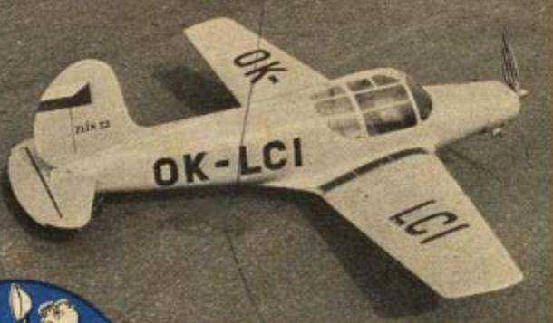
Maketa Z 22, kterou postavil J. Vylíčil z modelářského kroužku OV Svazarmu v Sumperku. Měřítko: 1:5, rozpětí 2,2 m, váha 3,25 kg, motor 14 ccm, rychlosť 35 km/hod. Model se zkouší na věži 2,5 m vysoké s ovládáním mimo kruh jako volný.
