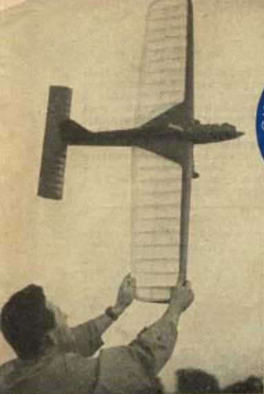
▲ Akrobatický model M. Herbera s plovoucí výškovkou, kdy se pohybuje celá vodorovná ocasní plocha.
