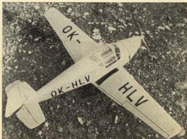
Maketa Zlin 318 Milana Šimbovců z Brezna. Je v měřítku 1:10 na motor Torpado 5 cm 3 .
