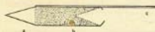
Obr. 1. Bolová raketa okolo r. 1800 (váha až 20 kg, dolet asi 2960 m): a – bolová hlava se zápalnou náplní nebo černým prachem; b – spalovací komora s raketovým palivem; c – dřevěná lišta k stabilisování letu.
