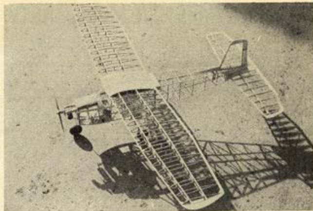
Motorový model ALFA, který jsme loni slíbili a neotiskli, vypadá v kostce takto. - Dnes už je ovšem dohotoven, zalátno a dokončuje se výkres, jenž bude během krátké doby k dispozici. Zářem jsme navrhli v redakci a prosíme čtené zájemce už jen o malou trpělivost.
