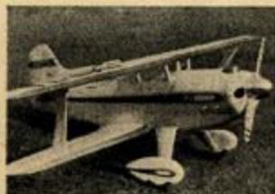
R. Metz z Kladna (II., Kocidlova 1690) si vybral jako předlohu pro svoji novou maketu úhledný farmářský sportovní „Sahlar-Special“. Model v mér. 1:4 má rozpětí 1120 mm, váží 1680 g a s motorem MVVS 5,8 létá na 20 m drážce rychlosťí 95 km/h. Má zmontované zafixené pro vzdálení otáček motoru.
