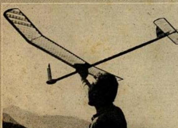
Na tradiční soutěži „Copa Stella d'Italia“ pro magnetem řízené větrony byl čtvrtý model A. Ghiotto z Trevise. Pro tuhost volně konstruktér geodetickou konstrukci, stejně jako jeho krajan Soave, vicemistr světa v A-2
