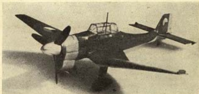
▲ Nבלהוּ dobu druhé světové války připomíná upravená maketa známého německého bojového letadla Junkers JU 87 Stuka. Konstruktor K. Bechtold z Klánovic ji opatřil čs. výsostnými znaky (hořistý stroj). S motorem NV-21 létá model rychlostí asi 60 km/h.
