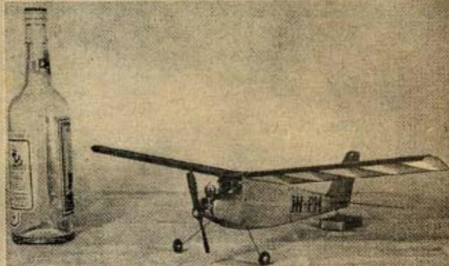
Na pohled obyčejný hornoplánik, jenž – můžete vidět – má rozpětí 200 mm, motor Cox Tee-Dee 0,16 ccm s dvoukálovnou R/C aparaturou. Je výmluvným dokladem pokroku techniky
