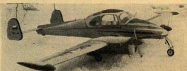
Maketa L-200 „Morava“ L. Houky (J. Hradec 67/III) má detailně vybavenou kabínou a zatahovací podvozkem, vedeným elektromotorkem 4,5 V. Měřítko 1 : 9, rozpětí 1360 mm, dva motory MVVS 2,5D, váha 1200 g, rychlosť 75 km/h na 16 m dráze
