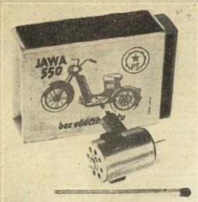
▲ Výrobek ze Šumperka zhotovil amatérský elektromotorka pro výbarvovací zařízení rádiem fízenných modelů. Váží 6,5 g a se zdrojem 2-3,6 V má 4500 ot/min.
