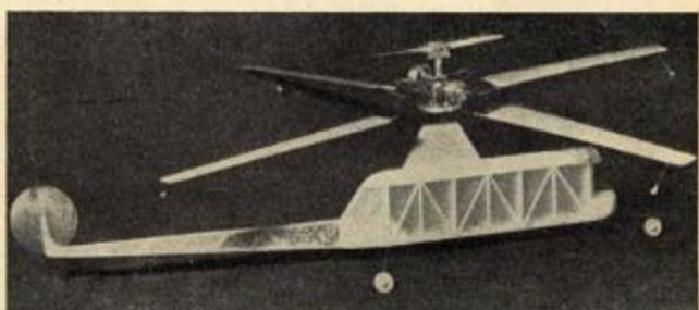
Modeláři D. Filipp a J. Stuchlík, členové ZO Svatovámu Odvětví závody V. Širokého v Trenčíně postavili — pravidelnou jako první u nás — volně létající model helikoptery, který vidíte na obrázku. Model je celobalsový, má rozpětí (průměr) rotoru 900 mm a je v něm zamontován detonační motorek Buš-Frog 1,23 cm.
