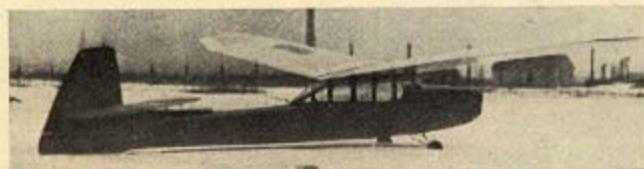
Rádiom riadený model Jana Heimricha. Niektoré dátia: Rozpätie 2400 mm, dĺžka 1650 mm, váha 2200 g. Model je celobalórový, trap šípovinovej konštrukcie. Rádiiová aparácia MVVS Brno, frekvencia 27,120 MHz, vybavovacie relé vlastnej výrobky, dvojramenná rohatka. Zdroje: Monolitický 1,5 V, anodová batéria 72,5 V, plochá batéria 4,5 V na vybavovacie relé.
