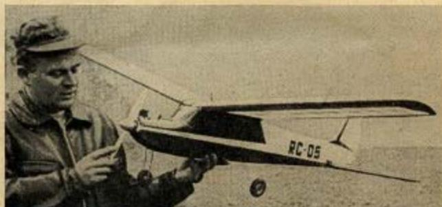
0,8 mm. Pro zpevnění je trup přes balsu potažen silonem. Tlakový drátený vozek je odnímatelný.
