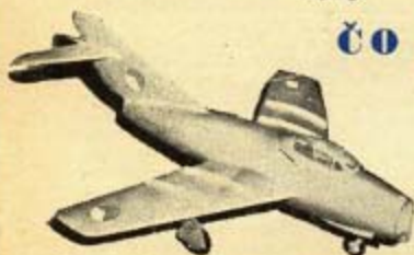
Lietajúca maketa cvičného lietadla C-11 postavil M. Chyjavec. Rozpätie 940 mm, motor AMA 10 cm 3 , teleskopický podvozok, váha 2,3 kg.
