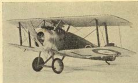
Historické stíhačky SPAD S. VII a Sopwith F. 1 „Camel“ z r. 1917, které v měřítku 1:50 zhotovil Karol Nechleba z Prahy 12. Model „Camel“ vykazuje některé drobné odchylky od skutečnosti (podvozek, hoptáž kulometů, sloužil na baldachynových vzpěr) způsobené právě nedostatkem dokumentačního materiálu.
