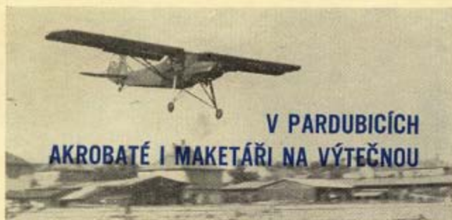
Technicky nejlépe vyřešený Čáp z. Heyera z Pardubic měl elektromotorem řízené otáčky motoru, podvozek s funkčním přerováním a funkční vztlakové klapky.
