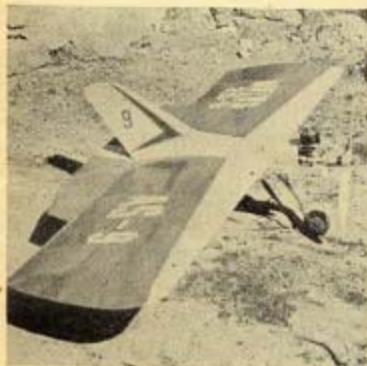
▲ Akrobatické samokřídlo V. Dvořák ze Svazarmu v Brandyse n.L. létá s motorem MVVS 2,5D rychlostí 140 km/h a je velmi obratné.
