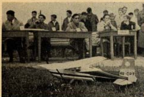
Cessna Skylane modelář Bedažonyho z Krakova měla křídlo z duranového plechu 0,2 mm, ovládací páčky motoru Vítavan 3, klapky a pozici světla
