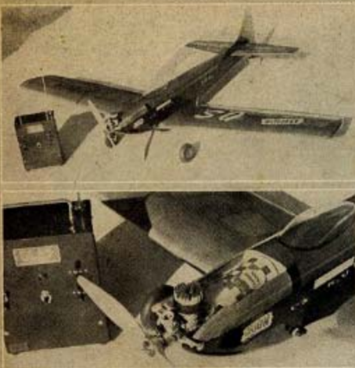
Známy model Orion (plánek v LM 1/61) postavil u nás B. Trmač z Tělnova. Celková váha modelu o rozpětí 1720 mm je 2850 g (bez paliva). Na detailu odkrytého předku je vidět ovládání motoru OS MAX III - IS (5,8 ccm) a plastická nádrž 220 ccm se sádkovým přetlakem z motoru. Osmikanálová R/C aparatura ovládá: směrovku, výškovku, křídla, otáčky motoru plynuje od 2500 do 12 000/min (s vřutí Ø 300/150 mm).
