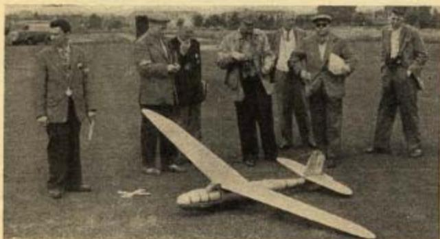
Větroň belgického modeláře Mabille. Jednokantlové flízemi, rozpětí 3 m, váha 3 kg.
