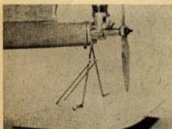
Připevnění plováku k motorové předpěci. Hlavní vzpěra je stažena mezi dvěma hliníkovými plechy o tloušťce 1,5 mm. Vytváříte si posuvného připojení pomocné vzpěry pro změnu úhlu nastavení plováku.
