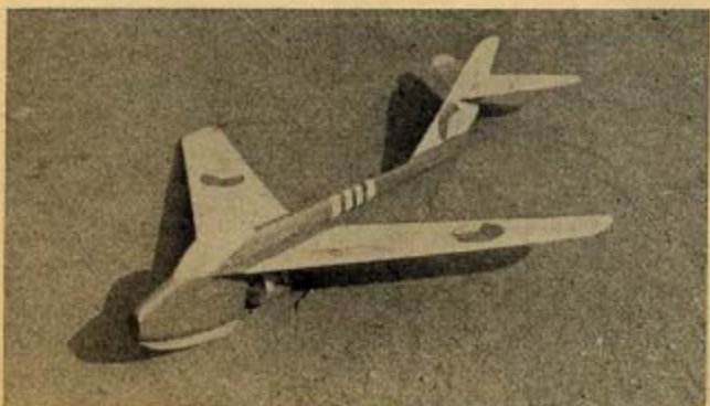
Polomaketa MIG-15 s raketovým motorkem Synjet 1 startuje vystřelováním gumou a dosahuje časy až 70 vt. při letové váze 28 g (je polobalovév). Zhotovil O. Šaffek, Václavské nám. 33, Praha 2. ▼
