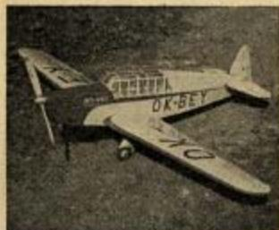
Gejčný akrobatický model konstrukce O. Krippera postavil P. Kriška, B. Bystrica (Hrubanová 11). Data: rozpětí 1000, délka 680 mm; váha 600 g; motor MVVS 2,5 D; vrtule silikonové o 200 mm
