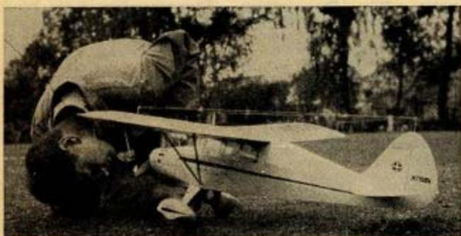
Větší maketu sportovního letadla Piper Pacer, vhodnou i pro starty na horším terénu, postavil podle LM J. Čimbura z LMK K. Žehrovice. Má rozpětí 1320 mm, váží 1186 g a s motorem Vltavan 5 létá rychlosťí 80 km/h
