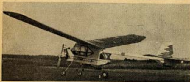
▲ Volná polomaketa konstrukce Ant. Svobody, Fügnerova 78, Kladno II. Rozpětí 1600 mm, nosná plocha 40 dm 2 , zatížení 20 g/dm 2 , motor AMA 1,8 ccm. Tříkolový podvozek umožňuje stabilnímu modelu přistávat i na méně kvalitním terénu.
