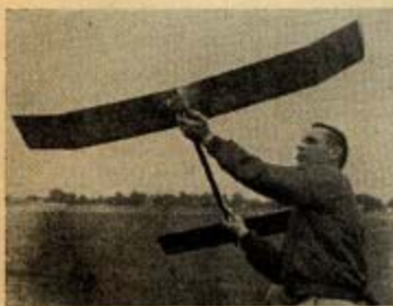
Američan Müller natáčet pětý počet vteřin a šomrlit na 12. místě! Jeho model z motorem OS MAX 15 se vyznačoval zajímavou starobou křídla - bez klasického nosníku a s celou vrchní stranou z baly.
