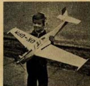
Palomaky z plochým trupem zvláštně získávají oblibu. Instruktor Faro z Děčína (Prostejov 622) si vyrábí jako predlohu Meta-Sokola. U-model o rozpětí 1055 mm je využíván z tuzeckého materiálu, vaha 640 g a s motorem MVVS 2,5 D má rychlosť přes 70 km/h.
