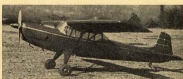
Pode podkladu v LM 5/58 zhromadil M. Havlík z Pardubic maketu sportovního letadla M. Brochet MB 110. Rozpětí 1106 mm, nosná plocha 21 dm<sup>2</sup>, váha 1050 g, motor TONO 3,5 cm<sup>3</sup>.
