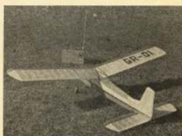
Kridlo. Hlavný nosník moria des smrekové listy 3x6 nad sebou a pomocný dve listy 3x3. Nábežná hraha je z balzy 10x10, odstavova hraha z balzy 2 mm, ktorá je zlepšená do tvary „V“. Torný poťah kridla ako aj profily sú z balzy 2 mm. Kridlo je v strede delené a spojené drahovými spojkami. Anténu prijímača o dĺžke 800 mm je v pravej poloviči kridla.
