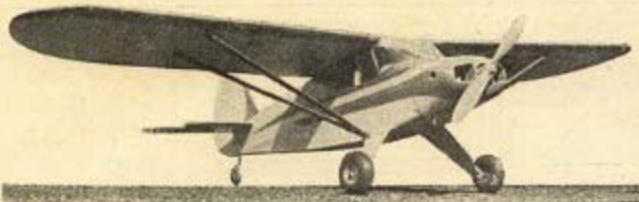
Upoutaná maketa sportovního letadla Piper Racer 125. Rozpětí 1360 mm, délka 950 mm, výška 1350 g, celková plocha 40 dm<sup>2</sup>, motor Vltava 5 cm<sup>3</sup> ležatý. Maketu modelářsky zpracoval podle podkladu v LM 6/1957 Václav Vostráb z Rakovníka.
