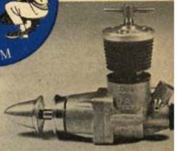
Zajímavě řešený italský motor Super-Tigre G. 31 o obsahu 1,47 cm<sup>3</sup>. Klikový hřídel je uložen ve dvojitém kuličkovém ložisku, sání klikovým hřídelem vzadu. Výkonost asi 0,16k při 16.000 ot/min.
