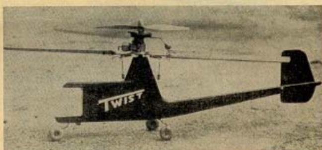
T. Weigert z Prahy-Vinohrad (Zahrádkářská 28) se pokouší vyřešit volnou létající helikoptérku. Model Twist je v potenci již pátý. Průměr rotoru je 720, délka modelu 820, výška 290 mm. Rotor je poháněn reakčním momentem motoru Bult-Albon, 1,5 cm (tzv. bivrtací motor).
