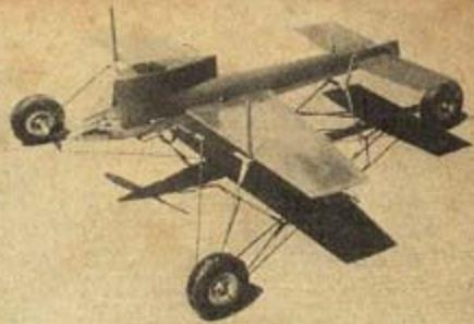
Rychlostní model s motorem 2,5 cm<sup>3</sup> podle nových pravidel konstrukce italského modeláře Padovano z Torina.
