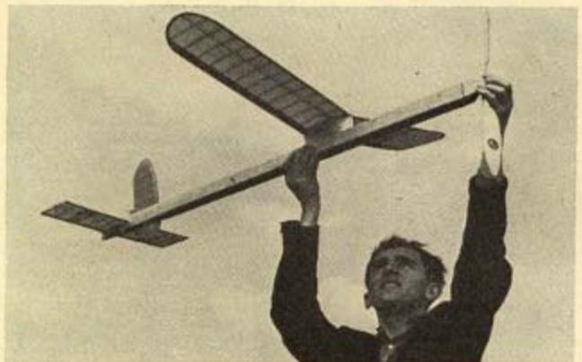
Model na gumi typu Wakefield Ing. M. Kubaly z KA Ostrava. Je pozoruhodný tím, že nad trup slepěn je ze čtyř balisových průseků dřevem bez dalších výstav.
