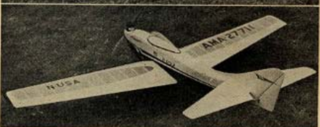
Tri pohledy na vítězný model T. Bretta. Rozpětí 1550 mm, nosná plocha 36,7 dm 2 , šířkostí \lambda = 6,55 , profil 15%, letová váha 2380 g, plošné zatížení 65 g/dm 2 , motor K&B 45 RC. Model obtočoval před MS přes 180 letů. Je představitelům současní nejběžnější koncepce R/C modelů
