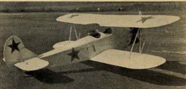
Neobyklá, ale pěkně vypadá maketa známého sovětského „kukuruzníka“ v zimním hávu. Je prací Z. Bedřicha z LMK Brno 2. Data: rozpětí 1040 mm, letová váha 600 g, motor MVVS 2,5D. Let modelu je realistický, letové vlastnosti i obratnost dobré.
