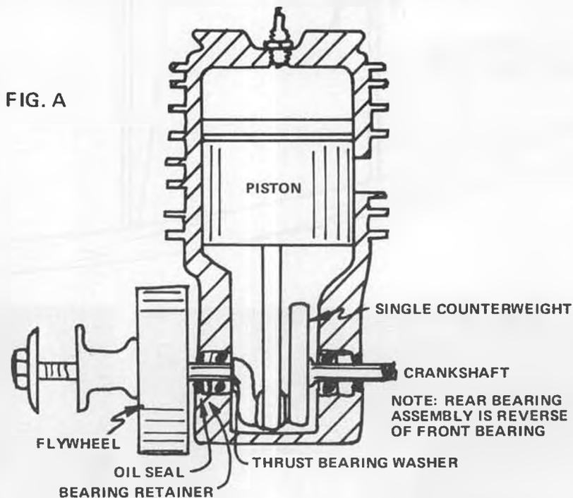
**ADVANTAGES:** SINGLE PIECE ROD AND CRANK (LONG LIFE, LIGHT WEIGHT, RESISTANT TO DAMAGE).
