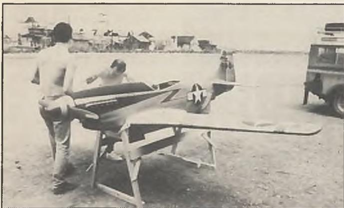
Eine der P-51D „Mustangs“ in Spielbergs Film. Das Modell ist im Maßstab 1:3 gebaut, hat eine Spannweite von 3,65 m und wiegt etwa 36 kg. Die Fluggeschwindigkeit liegt im Bereich von 50–140 km/h, die Modelle können etwa 45 Minuten in der Luft bleiben. Insgesamt sechs „Mustangs“, sechs Mitsubishi „Zero“ und einen Bomber B-29 hat Spielberg in seinem Film fliegen lassen.
