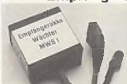
Der Empfängerakku-Wächter MWS I zeigt durch Dauerblinken der Leuchtdiode an, daß der Empfängerakku noch eine ausreichende Kapazität hat.
