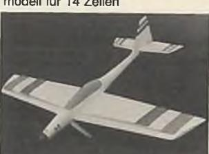
Ein Modell für die 14-Zellen-Kunstflugklasse, Spannweite 145 cm, Gewicht 2-2,5 kg, Antrieb z. B. Ge 75/20, Ke 50/11, HP 320/10
