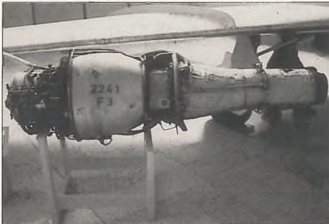
Die Marbore mit angeflanschter Schubdüse. Dieses Bild habe ich in der Flugausstellung L. + P. Junior in Hermeskeil gemacht. Ein Original steht auch in München im Deutschen Museum.
