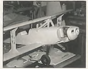
Die Duett im Rohbau. Der Rumpf ist aus ABS-Kunststoff
