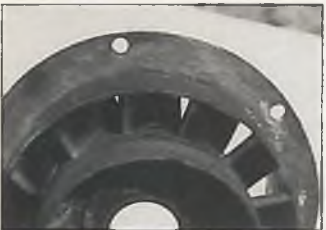
Blick von vorne in das Leitsystem, jede einzelne Schaufel hat Tragflächenprofil
