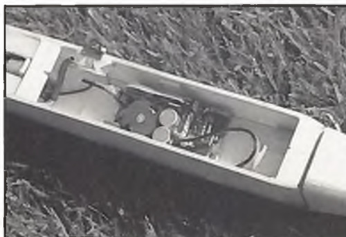
Der Universalregler in kompakter SMD-Technik pulst und regelt den Motorstrom mit 100 kHz, die 5-V-Stromversorgung der Empfangsanlage mit 52 kHz. Er mißt 52 × 26 × 15 mm und wiegt 24 g
