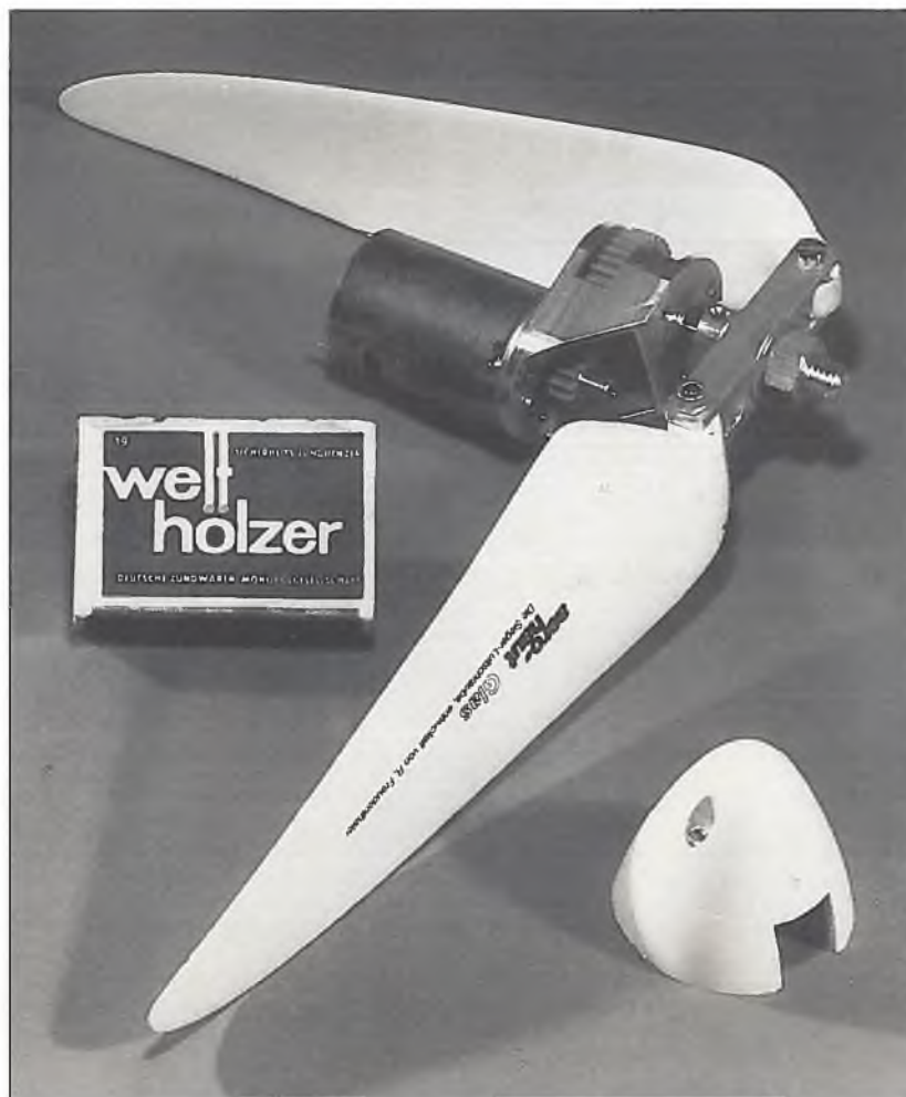
Abbildung 3: Ein RS-380 SH (Speed 400) hinter der Freudenthaler Klappflugschraube 14 x 8,5" (Getriebe auf Fräsbank gefertigt). Man kann es kaum glauben, daß dieser winzige Motor mit der riesigen, 36 cm spannenden Latte über 450 g Standschub erzeugt, und dafür nicht mal 10 A braucht! Mit einem Starrpropeller 12 x 7" lassen sich ähnlich günstige Werte erreichen. Hier ist man froh, ordentliche Lager eingebaut zu haben, denn eine 12'er Latte bringt schon einige Unruhe.
