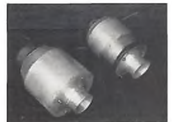
Beide Triebwerke, links die alte Version, rechts die neue (Insgesamt die 4. Düse)
