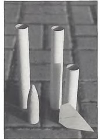
Materialien zum Bau eines Raketenmodells: Hinten Papphohre, vorne Nassenspitze aus Holz und Stabilisator
