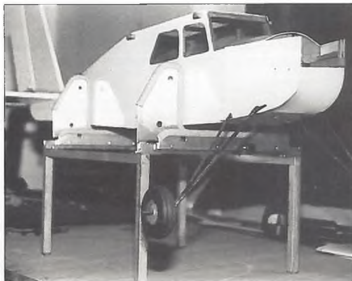
Keine Angst vor langen Beinen braucht der Montagehalter zu haben, da sich die Haltevorrichtung ca. 24 cm über der Werkbank befindet.
