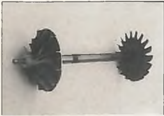
Das komplette Laufzeug mit Linksgewinde, vorne der Verdichter, hinten die Turbine mit 260 g wiegt es 40% weniger als das original Turboladerlaufzeug.
