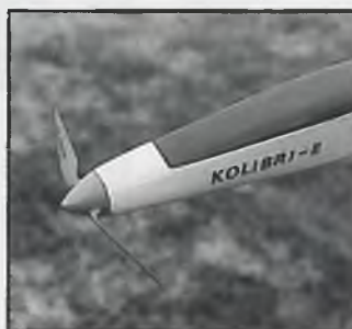
Seine lange Nase hat der „Skeeter“ auch nach dem Umbau behalten, der Spinner paßt sich dem Rumpf sauber an
