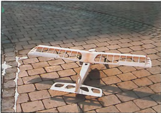
Rohbaufertig: der Bau läßt sich mit einfachen Mitteln bewerkstelligen
