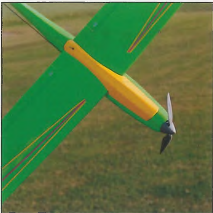
Nase weg, Spinner dran: Beim „Talon“ war der Umbau zum E-Modell wesentlich einfacher
