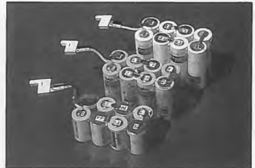
Batterien aus je 8 Zellen 500 AR (153 g), 700 AR (228 g) und 1400 AE (263 g)
