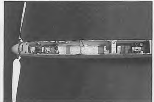
Batterien aus je 8 Zellen 500 AR (153 g), 700 AR (228 g) und 1400 AE (263 g)
