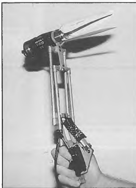
Robbes Klaptriebwerk; eine solide, verblüffend einfach ausgelegte Konstruktion mit einem Minimum an Bauteilen. Der Fußpunkt wird an der Holmbrücke im Rumpf verschraubt, das Servo fährt die gesamte Mechanik mitsamt Motor und Luftschraube ein und aus
