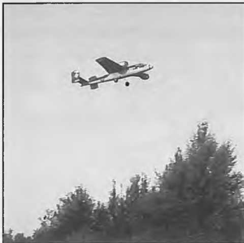
Das Midwest-Modell, vom Hersteller für einen Impeller konzipiert, hat 1280 mm Spannweite und ein Fluggewicht von knapp 5 kg. Mit der echten Turbine ist es richtig Scale motorisiert
