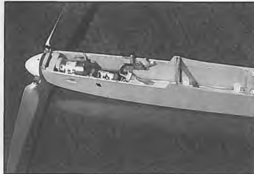
Vorn rechts im Batterieraum liegt die Leiterplatte zum Anlöten der Reglerkabel
