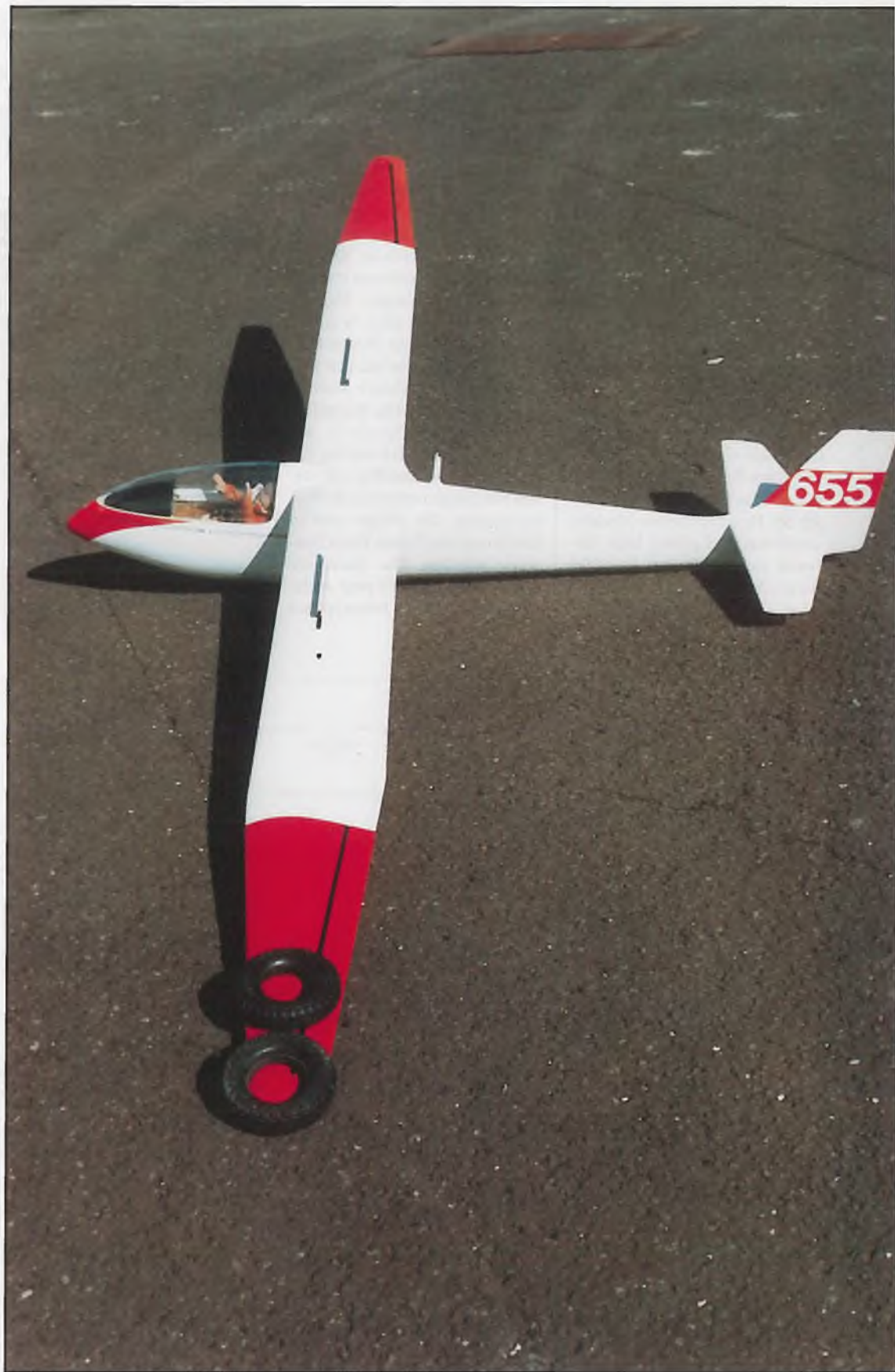
Sie 3, ein Nachfolger der Ka 6, und eines der letzten Exemplare aus der langen und erfolgreichen Ära der Segelflugzeug-Holzbauweise. Als Modellflugzeug nach wie vor aktuell und für uns auch gerade wegen seiner Bauweise interessant. Im Bild: Unser Bauplanprototyp nach dem gleichzeitig mit diesem Heft erscheinenden Plan. (Reifen zum Flügelbeschweren im Bauplan nicht enthalten)
