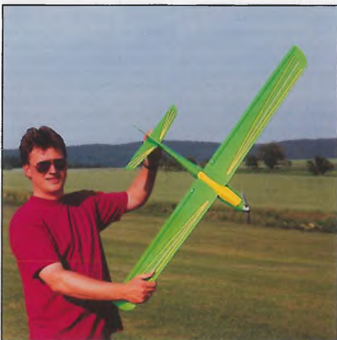
Der „Talon“ ist mit seinem geraden Flügel und den über zwei Servos angesteuerten Querrudern schon etwas anspruchsvoller, aber auch fliegerisch interessanter. Ein echter Kunstflieger in der 400er-Klasse
