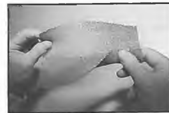
Die Wabe ist außerordentlich druckfest und leicht - sogar sphärisch - verformbar
