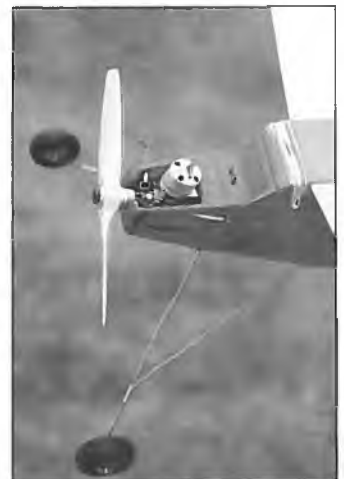
Benno Schlosser flog seinen „Mini-Brummer“ mit einem selbstentwickelten 0,25 cm 3 Dieselmotor (Fotos: Fenchel)
