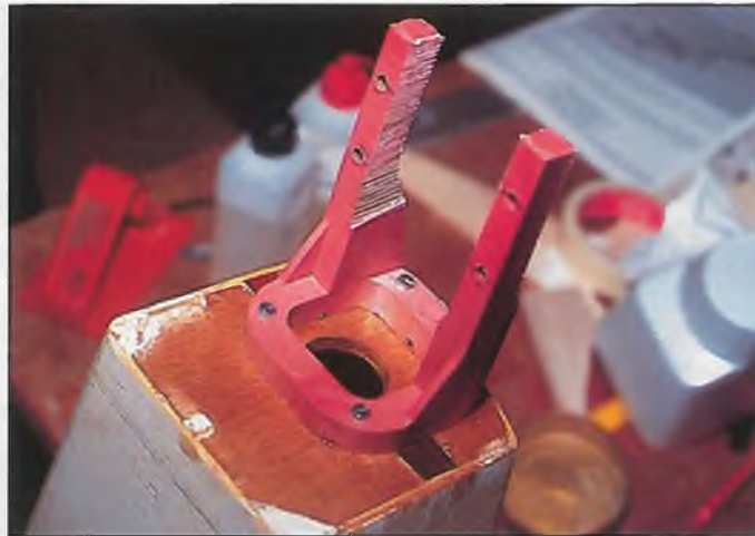
Aus optischen Gründen sollte der Anbau des Motorträgers für die hängende Motormontage vorgenommen werden
