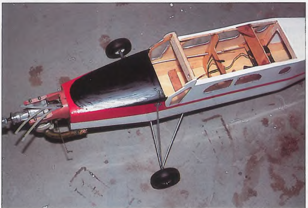
Motoreinbau, Rumpf fast fertig
