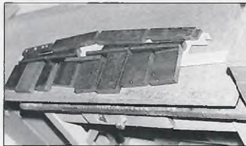
Die für den Bau benötigten Schablonen für die Rumpfseitenwände, das Seitenleitwerk und die Flügelrippen
