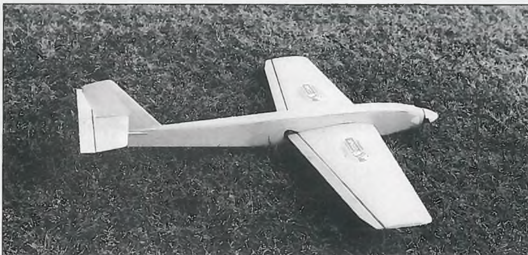
Die Kunst des Leichtbaus ist hier gefragt, um ein flottes, kunstflugtaugliches Modell zu haben. Die Mini-Schwalbe wiegt flugfertig 450 g
