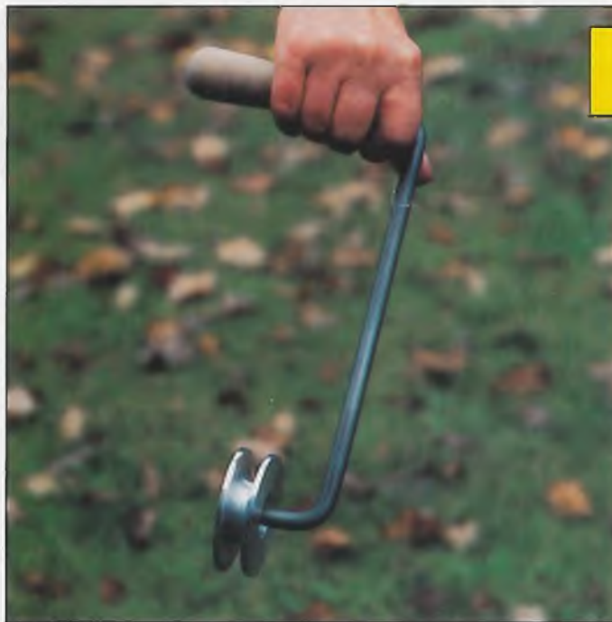
Die Umlenkrolle von M. Kroeger. Die Abwinkelung der Griffstange wird nach Benutzerwunsch vorgenommen
