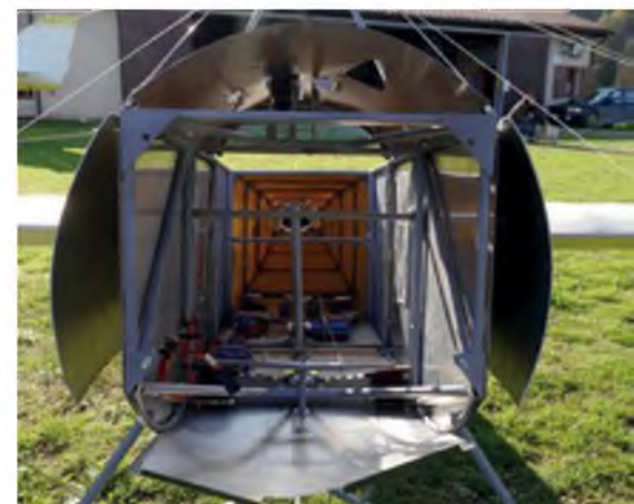
Da alle Antriebskomponenten am Kopfsant montiert sind, ist die Demontage in wenigen Minuten möglich.
