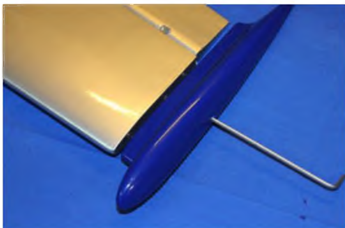
Die Wirbelkeulen werden über kurze CFK-Stifte außen an die Flächen gesteckt und mit je einer M3-Inbusschraube befestigt.
