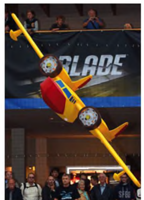
Die Seegans mit 2,7 m Spannweite wiegt nur 1,1 kg. Ein 3s-LiPo mit 1.300mAh reicht für spektakuläre 5 Minuten Showzeit. Die Kraft kommt von zwei T-Rex 250 Antrieben.
