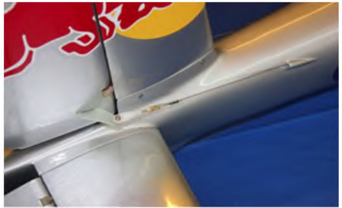
Das Seitenruder ist per Seilzug angelenkt, das zugehörige Servo sitzt vorne im Rumpf.
