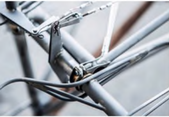
Der Rohrholm läuft in Messing-Gleitlagern, die wiederum in zwei Halbschalen liegen. Durch Öffnen der Halbschalen ist die Höhenflosse abnehmbar.
