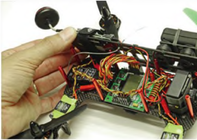
Erst nach ordentlicher Verlegung aller Kabel sollte man die obere CFK-Platte befestigen.
