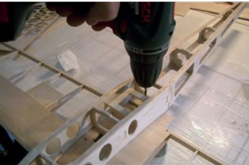
Das Vorbohren der hinteren Flügelbefestigung erfolgt im ausgerichteten Zustand.
