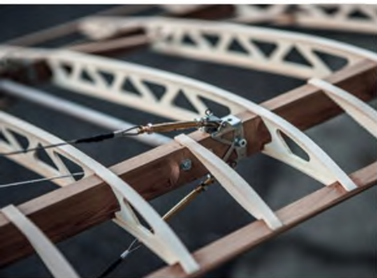
Die Rippen sind dreiteilig aufgebaut, da sie von beiden Holmen unterbrochen werden. Im Bereich der Verspannungslager sind die Holme nicht zum Doppel T-Profil ausgefräst.
