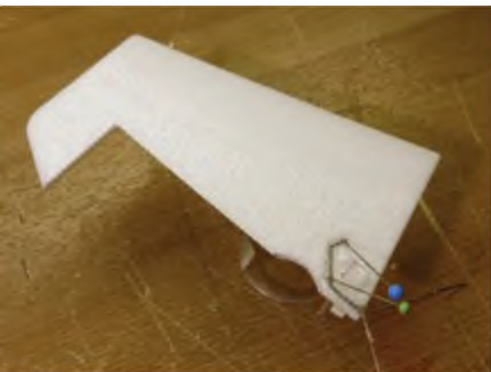
Der Fahrwerksdraht für das Spornrad wird nach Plan gebogen und mit Epoxy am Seitenruder befestigt.
