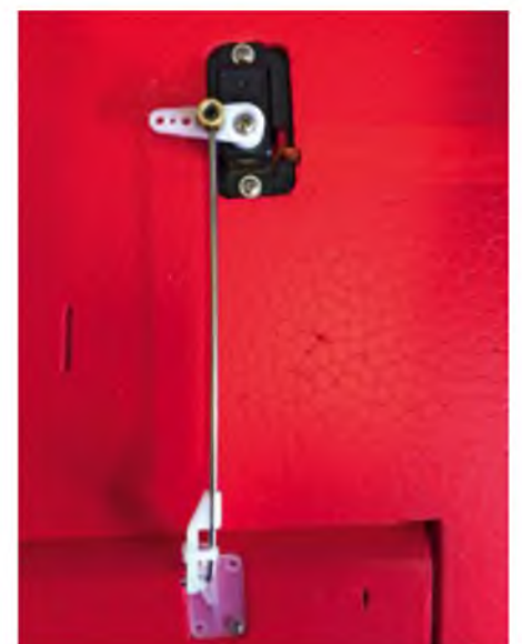
Für das exakte Fliegen des F3A-Programms wurden die Anlenkungen an den Servos von ganz außen nach ganz innen gesetzt.
