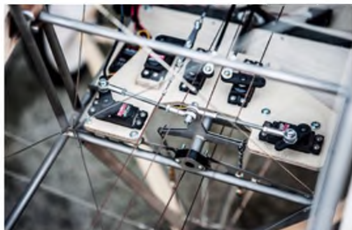
Zwei leistungsfähige Servos steuern die Flächenverwindung.
