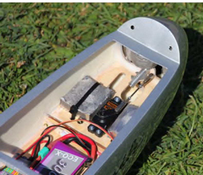
▲ So werden die Klappen angelenkt. Gut zu sehen ist auch der stehende Einbau der Servos.
