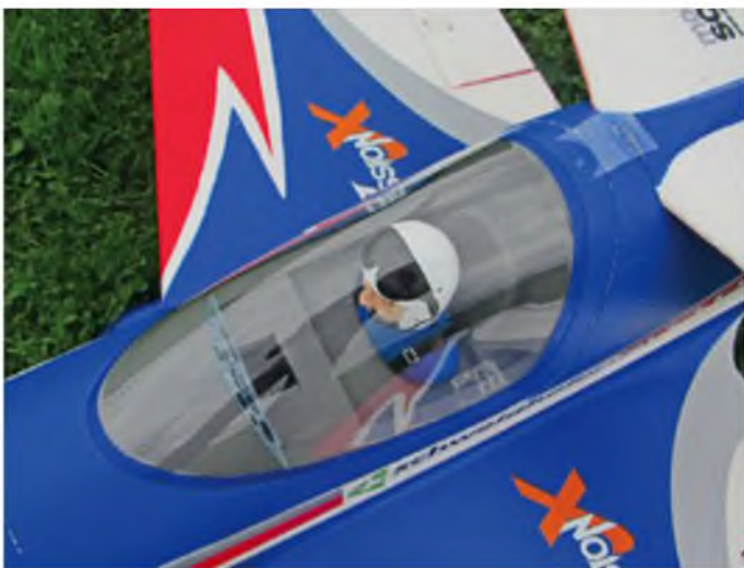
Die Kabinenhaube ist fix und fertig und wird mit Magneten sicher am Rumpf gehalten. Zum Öffnen dient der doppelte Tesastreifen, er ist auch schon angebracht.
