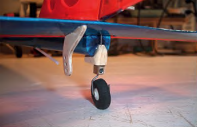
Das Heckfahrwerk ist angelenkt – der Torsionsdraht ist unter dem Ruder mit Klebeband fixiert.
