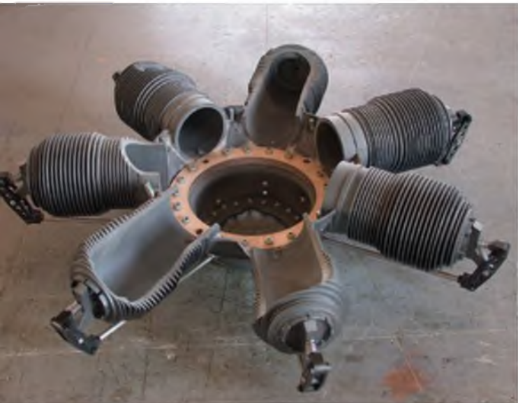
Die Attrappe des Oberursel-Umlaufmotors ist aus gefrästen bzw. tiefgezogenen PVC-Teilen aufgebaut und mit Metallic-Lack authentisch lackiert.
