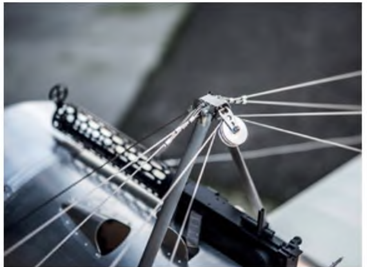
Der Spannturm kann zum Transport demontiert werden – die hinteren Seile laufen über eine Umlenkrolle.
