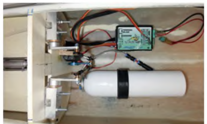
Durch entsprechende Positionierung der einzelnen Komponenten kann häufig der vorgegebene Schwerpunkt ohne Zugabe von Ballast erreicht werden.
