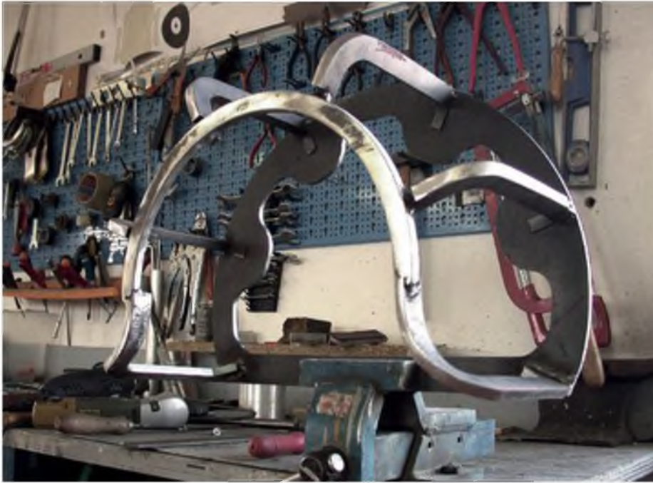
Die massive Helling zum Bearbeiten der Alu-Motorverkleidung.
