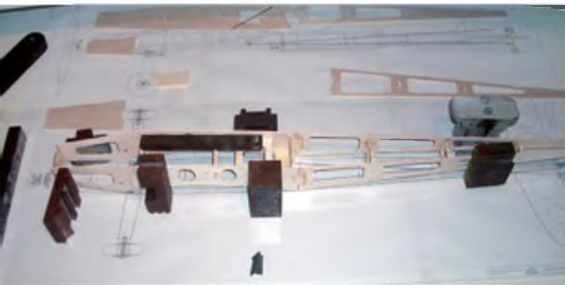
Alle Spanten sind mit den Rumpfteile ausgerichtet und verklebt.
