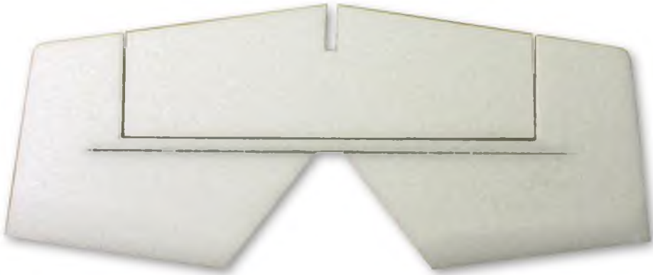
Das Höhenleitwerk im Rohbau. Der CFK-Flachstab sorgt für die nötige Stabilität.
