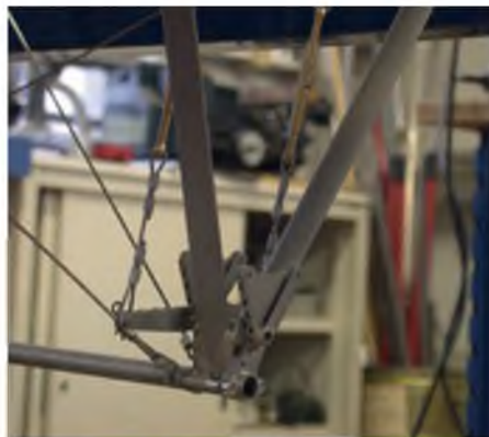
Der Umlenkhebel der Verwindungsanlenkung ist an den hinteren Fahrwerkstreben gelagert.
