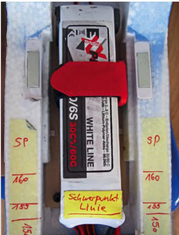
Der Schwerpunktbereich von 150-160 mm wurde ausgewogen und angezeichnet. Das Erfliiegen des richtigen Werts nimmt einige Flüge in Anspruch.
