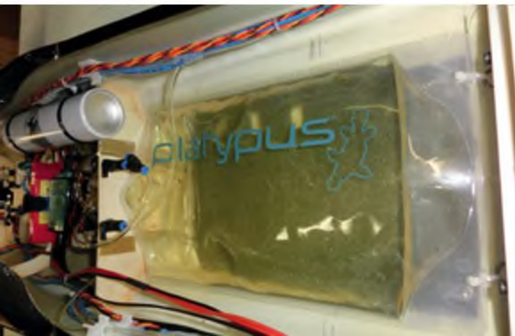
Der Platypus-Tank wird mit dem Schraubverschluss am vorderen Spant und hinten mit Kabelbindern befestigt.
