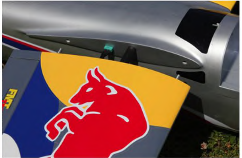
Die Fläche wird mit einem massiven CFK-Verbinder an den Rumpf gesteckt und mit zwei Gewindestiften verschraubt, die Passung ist sehr gut.
