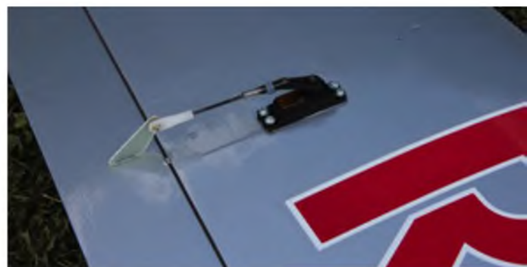
▲ So werden die Klappen angelenkt. Gut zu sehen ist auch der stehende Einbau der Servos.
