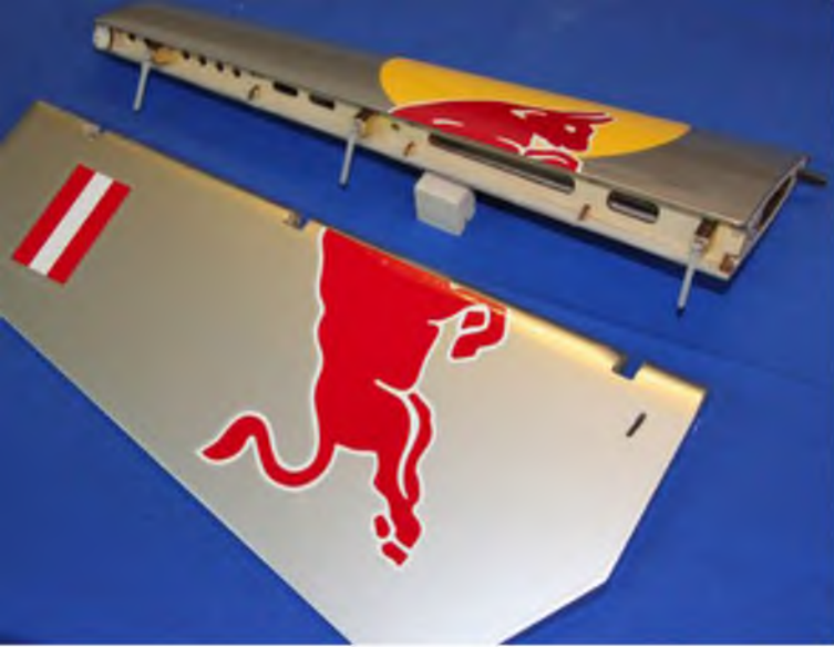
Hier beim Seitenruder erkennt man sehr schön die Hohlkehlenlagerung der Ruder. Für die Aufnahme der Stiftscharniere sind die Fläche sowie das Ruder perfekt vorbereitet.
