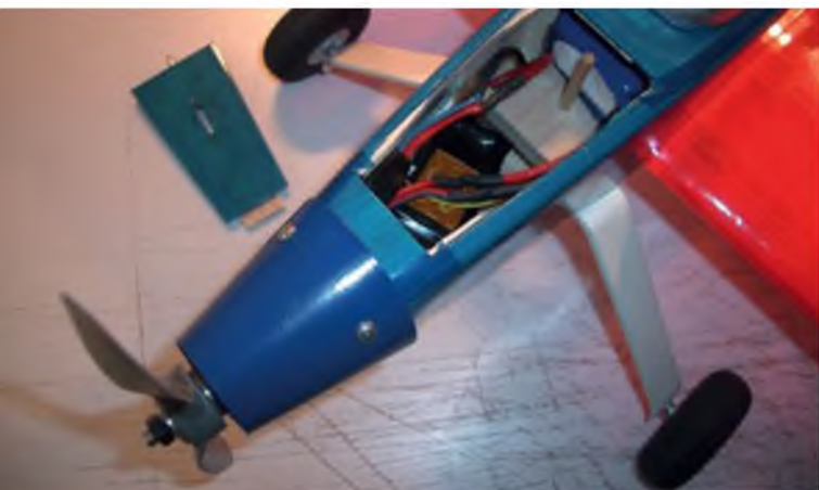
Der Regler bekommt seinen Platz direkt hinter dem Motorspant.
