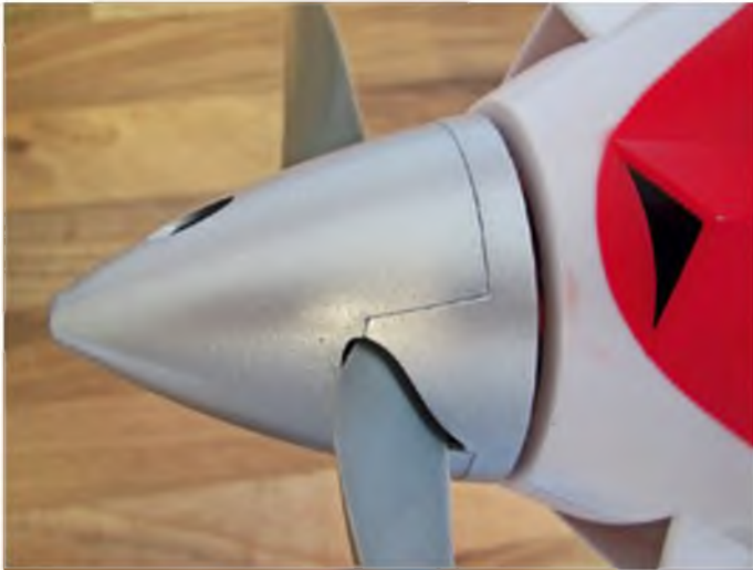
Ein tolles Detail: Der Kunststoffspinner umschließt den Propeller perfekt.
