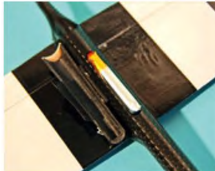
Langloch mit Deckel: der Akkuschaft für den 1s-Nanotech-LiPo mit 300 mAh.
