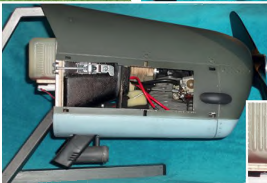
Die Motorhaube für den Reihenmotor wie auch der kurzen Rumpfübergang der MS-505-Version sind seitlich zu öffnen und geben so den Zugang zum Schnellverschluss frei
