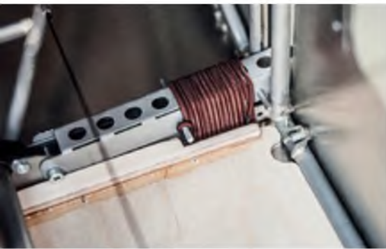
Die vorbildgetreue Federung des Hauptfahrwerkes erfolgt mit Gummibändern.
