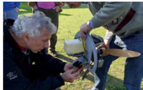
Gerd Reinsch bei der Abstellung des Problems zwischen Gas-Schubstange und Servo.
