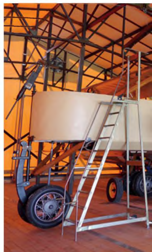
Der Spannturm kann zum Transport demontiert werden – die hinteren Seile laufen über eine Umlenkrolle.
