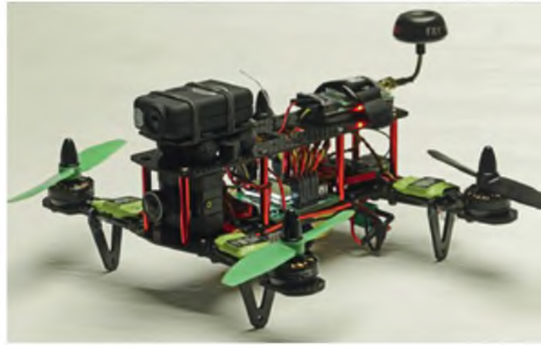
Geschafft. Der flugfertige kleine Flitzer ist mit FPV- und Videokamera (Mobius) ausgestattet.
