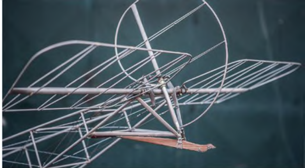
Das Leitwerk ist komplett aus Edelstahlrohren aufgebaut.
