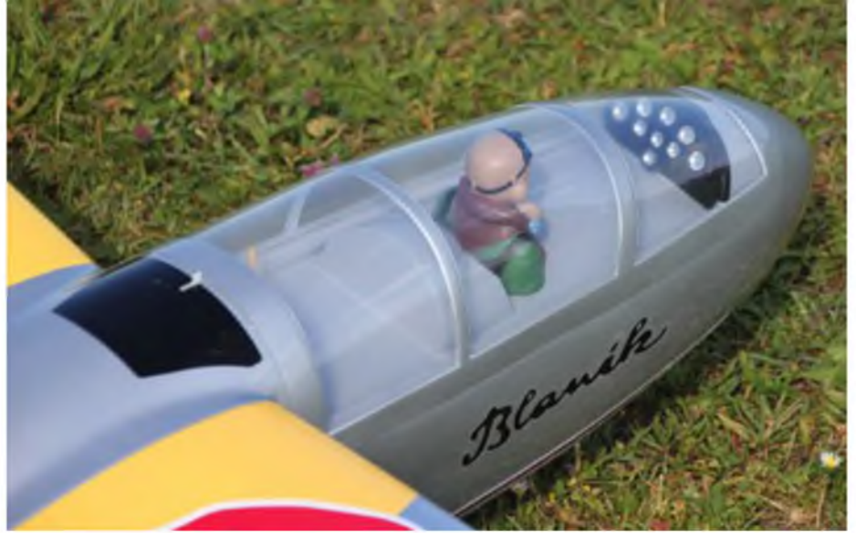
Der Ausbau der Kabine ist schlicht gehalten, Pilotenfigur und Instrumentenpilz liegen dem Baukasten bei. Die Verglasung muss noch passend zugeschnitten und verklebt werden.
