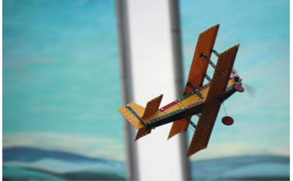
Auch Lutz Näkel wählte ein originelles Vorbild. Sein Modell im Märklin-Blechbaukasten-Look mit 64 cm Spannweite besteht aus 1-mm-Depron.
