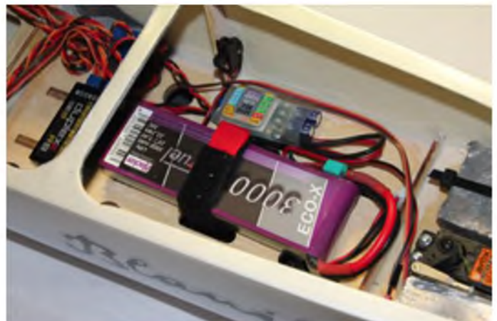
So findet der Empfängerakku seinen Platz, er wird von Klettband an seinem Platz gehalten.
