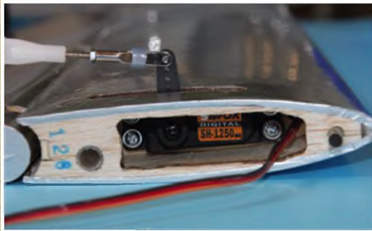
Das Höhenruderservo sitzt in der Dämpfungsfäche und steuert das Ruder direkt und spielfrei an.
