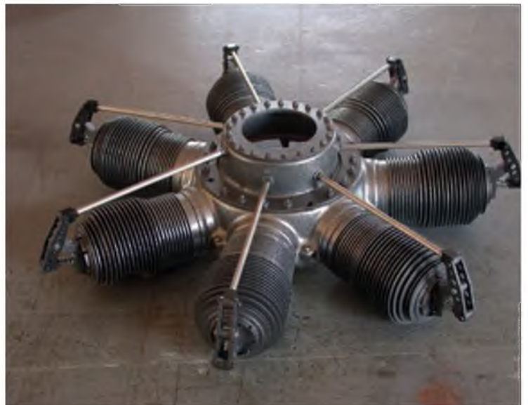
Die Attrappe des Oberursel-Umlaufmotors ist aus gefrästen bzw. tiefgezogenen PVC-Teilen aufgebaut und mit Metallic-Lack authentisch lackiert.
