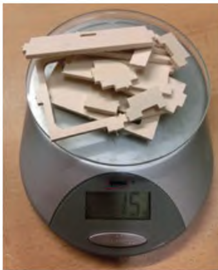
Die serienmäßig mitgelieferten Servorahmen aus Buche wurden gegen leichtere aus Pappel ersetzt.
