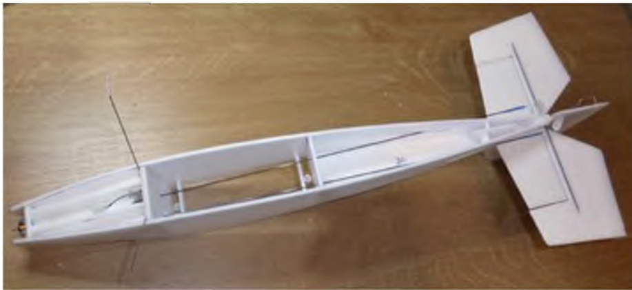
Hier sind die Ruderblätter bereits befestigt und die Anlenkdrähte eingezogen.
