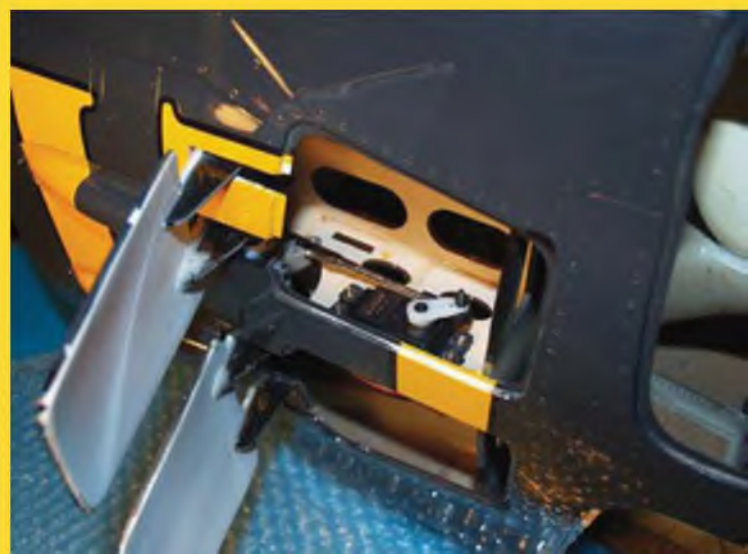
Die Speedbrakeanlenkung erfolgt über eine gemeinsame Achse. Für deren Lagerung und den Servomontageplatz werden noch einige Holzteile im Rumpfboden positioniert und verklebt.
