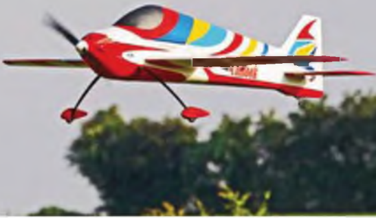
Im Anflug: der obere Flügel des Doppeldeckers hat eine leicht negative V-Form.
