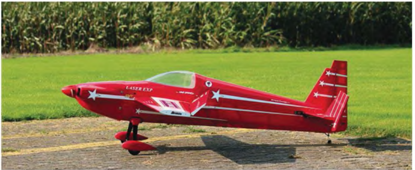
„Alles was geht“ – die großen 3D-Ruderausschläge ermöglichen der Laser extreme Flugfiguren.
