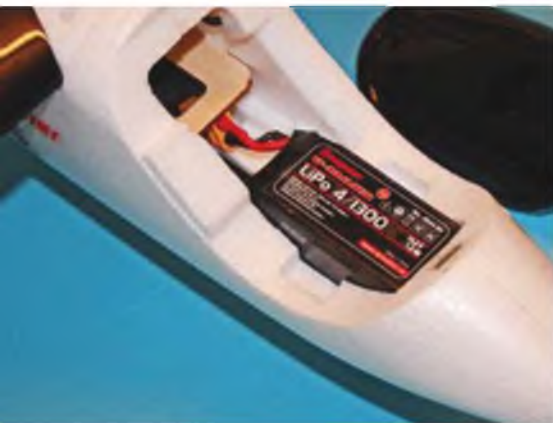
Der Akku findet in einem Fach vorne im Rumpf Platz, die Kabinenhaube aus tiefgezogenem Kunststoff mit Schaum-Innenteil wird von Magneten gehalten.
