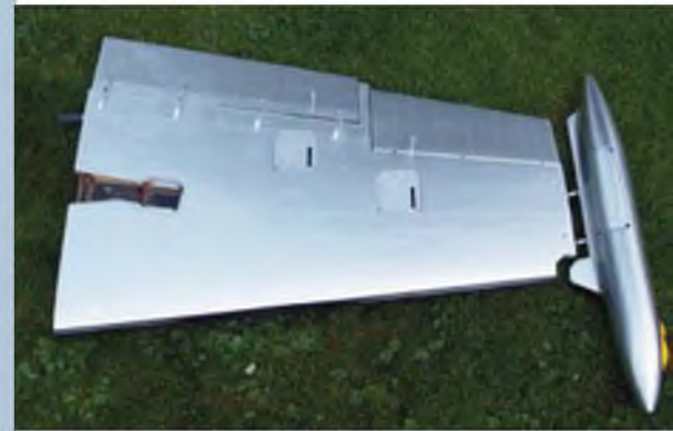
Die Tragfläche im Lieferzustand: Fahrwerk und Servomontage sind vorbereitet, die Klappen und Ruder befestigt und die Ruderhörner eingeklebt. Die Tiptanks sind abnehmbar.
