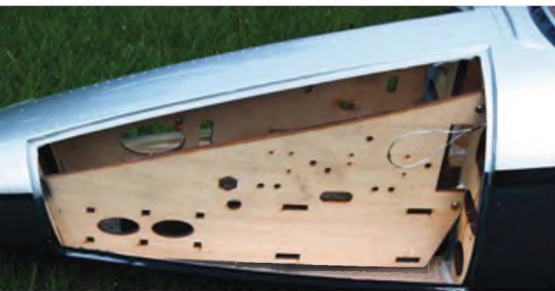
Die Speedbrakes passen mit leichter Nacharbeit gut in die Rumpfanformung.
