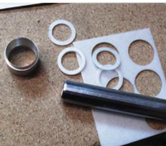
Extrem leichte Räder können aus Depron (Reifen) und Balsa (Felgen) gebaut werden.
