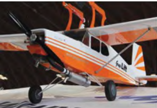
Der Grupp-Lift ist ein echter Klassiker, robust aufgebaut und mit gutmütigen Flugeigenschaften, auch ein Huckepack-Aufsatz ist erhältlich. In der Grundversion steuert man ihn nur über Höhen- und Seitenrudder. 2.200 mm Spannweite, ab 5 kg Gewicht, Motorempfehlung: ab 10 cm 3 Verbrenner oder elektrisch.
