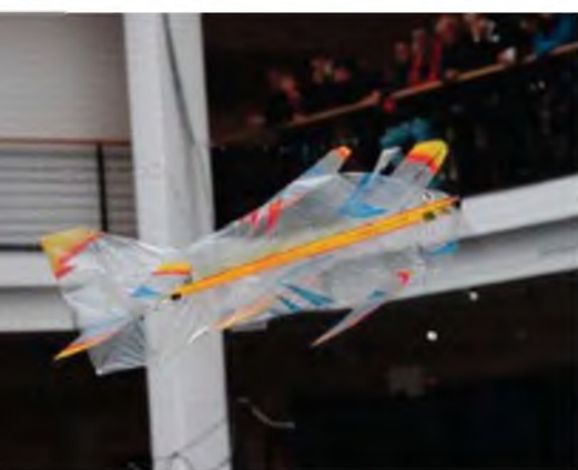
Extrem leicht sind die F3P-Modelle von Chris Tittel und Kevin Kirz, die nur noch aus dünnen CFK-Stäben und Mylarfolie aufgebaut sind. Sie wiegen unter 40 g.
