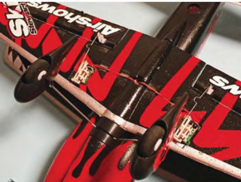
Das Fahrwerk wird am Rumpf in eine Kunststoffaufnahme geschoben.
