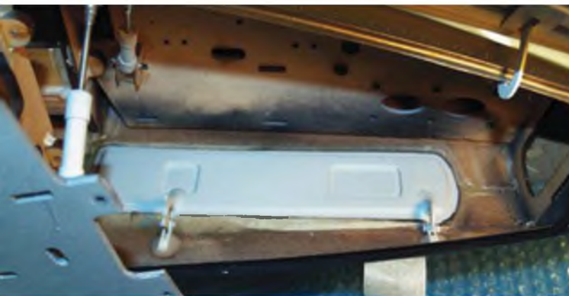
Die Speedbrakeanlenkung erfolgt über eine gemeinsame Achse. Für deren Lagerung und den Servomontageplatz werden noch einige Holzteile im Rumpfboden positioniert und verklebt.
