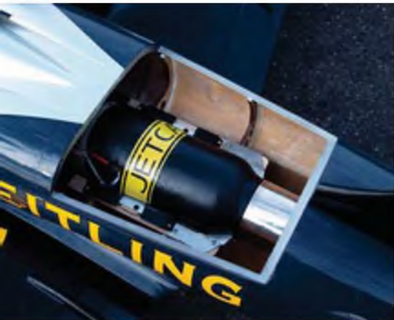
So passen Duct und Triebwerk gut zusammen.
