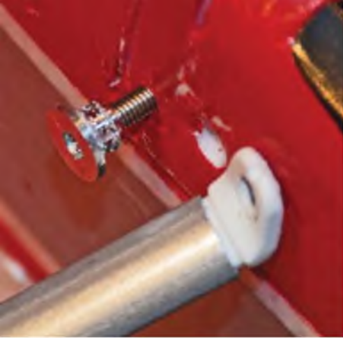
Ein M3-Stehbolzen mit Mutter ersetzt bei mir die Schraube für die Tragflächenstrebe am Rumpf.
