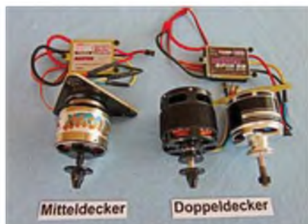
Die Antriebe der Modelle. Im Doppeldecker wurde zum Ende der Testphase von Dualsky auf Plettenberg umgebaut.
