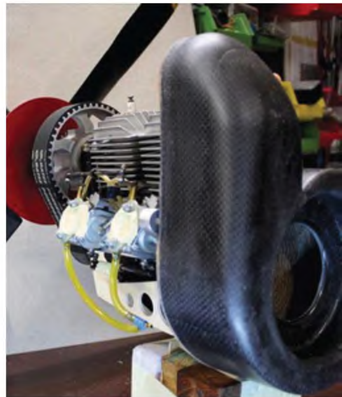
Ralfs 2-Zylinder-2-Takt-Reihenmotor hat 116 cm 3 , treibt einen 4-Blatt-Prop 31x29 mit 3.300 1/min an und wird über ein Radial-Gebläse gekühlt. Die 5-fach gelagerte Kurbelwelle entstand im Eigenbau, die Zylinder und Kolben vom 58er MVVS.
