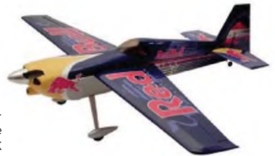
Edge 540 , Spannweite 1,2 m, Gewicht 1,25 kg, Länge 1,07 m.
