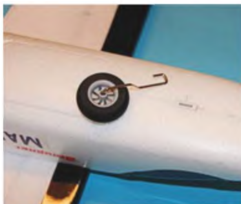
Das beiliegende Fahrwerk wird einfach in passgenaue Halterungen gesteckt und lässt sich so mit wenigen Handgriffen montieren.
