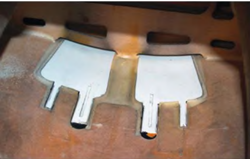
Die Speedbrakes passen mit leichter Nacharbeit gut in die Rumpfanformung.
