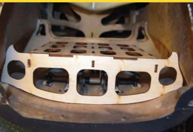
Die Speedbrakeanlenkung erfolgt über eine gemeinsame Achse. Für deren Lagerung und den Servomontageplatz werden noch einige Holzteile im Rumpfboden positioniert und verklebt.
