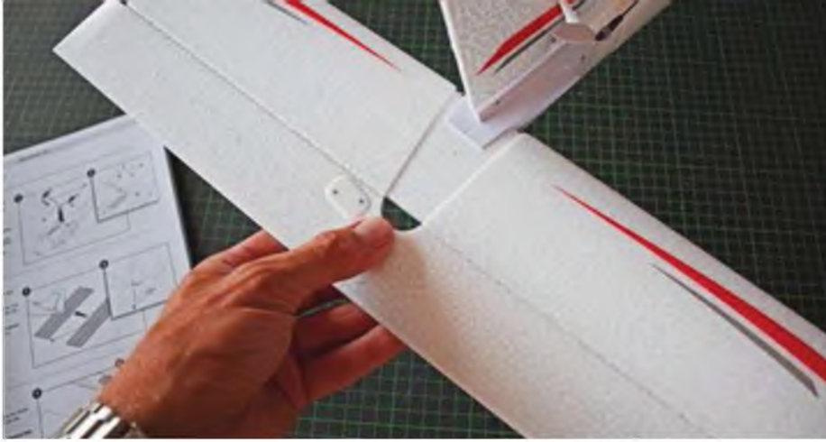
Auch das geht ganz schnell: Das Höhenruder wird einfach gesteckt und mit Klebestreifen gesichert.
