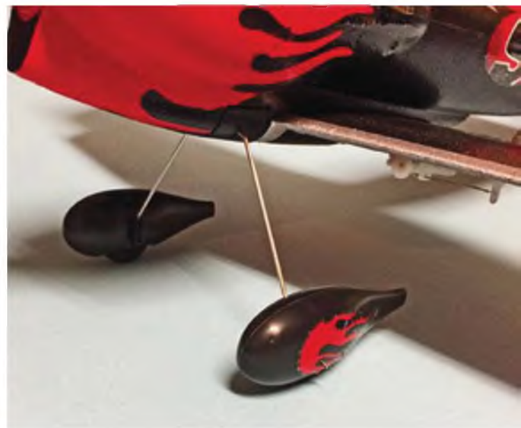
Die Radschuhe bestehen aus dünnem Kunststoff und sind somit sehr beständig.
