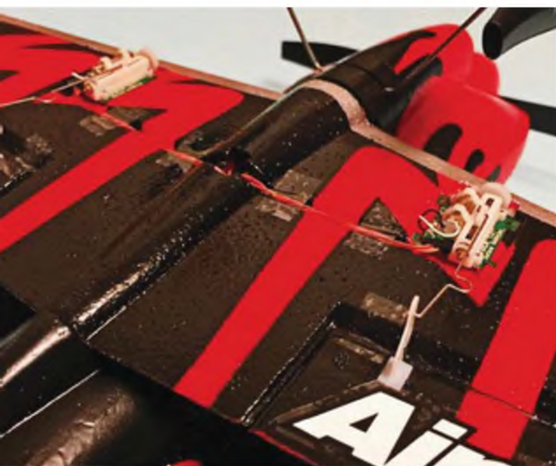
Die beiden Querruderservos sitzen unmittelbar vor dem Ruder in der Tragfläche und steuern somit direkt an.
