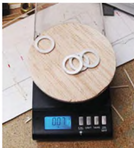
Extrem leichte Räder können aus Depron (Reifen) und Balsa (Felgen) gebaut werden.
