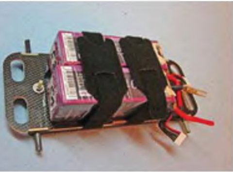
Der LiPo-Träger musste im Doppeldecker um 20 cm nach hinten versetzt werden.
