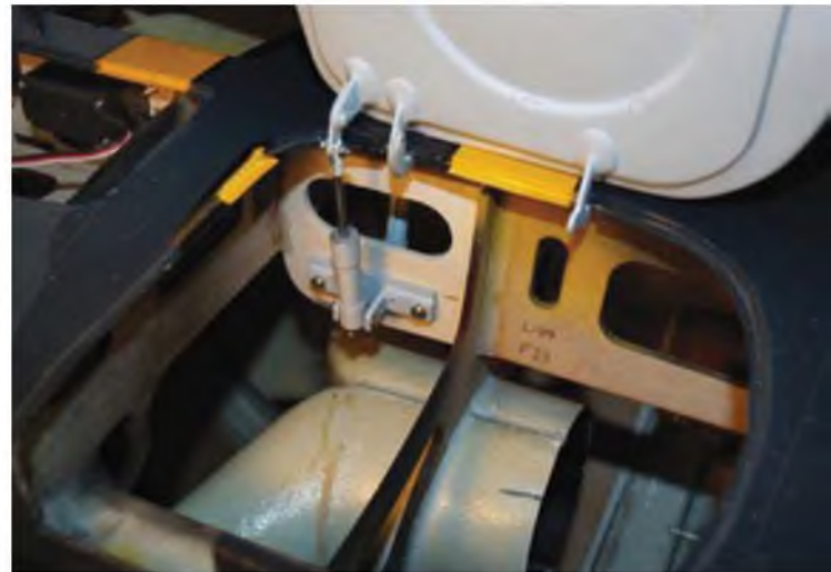
Die Hauptfahrwerksklappen in geöffneter Position. Man erkennt gut die Position des Pneumatikzylinders und das zusätzliche vordere Brettchen.
