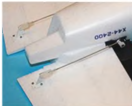
Die X44 kommt zur Steuerung im Flugzeugmodus mit nur zwei Servos aus, welche die Ruder als Tailerons ansteuern. Die Servos sind direkt im Heck verbaut und arbeiten über kurze Schubstangen.
