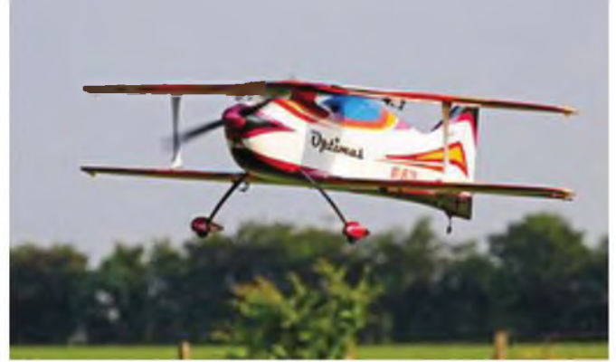
Im Anflug: der obere Flügel des Doppeldeckers hat eine leicht negative V-Form.
