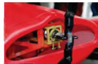
Tom Schunk stößt mit seiner gewaltigen, 3 m spannenden Extra wirklich an die Grenzen der Halle. Ganz neu ist das komplett selbst entwickelte Verstellpropellersystem inklusive Schubvektorsteuerung.
