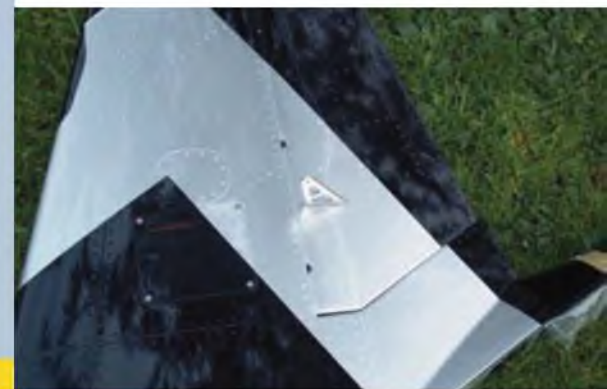
Die Seitenrudernanlenkung folgt funktionellen Ansprüchen – das Servo sitzt auf einem Deckel in der Dämpfungsfläche.
