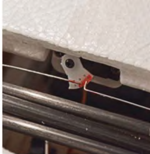
Die Landeklappen-Anlenkung habe ich steckbar umgestaltet.
