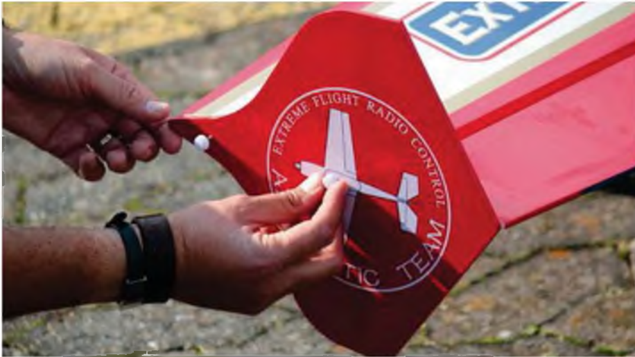
Dank Rändelschrauben sind die SFGs auch ohne Werkzeug schnell befestigt.
