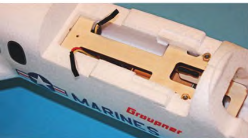
Das beiliegende Fahrwerk wird einfach in passgenaue Halterungen gesteckt und lässt sich so mit wenigen Handgriffen montieren.
