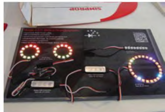
Bei Simprop erstrahlte das neue Magic-LED-Beleuchtungssystem , das mit vielen möglichen Systemkomponenten individuell kombinierbar, klein und leicht aufgebaut ist und sich damit für alle Arten von Helis und Flächenmodellen empfiehlt. 300 verschiedene Lichteffekte sind programmierbar. Kontakt: www.simprop.de , Tel.: 05247 60410.
