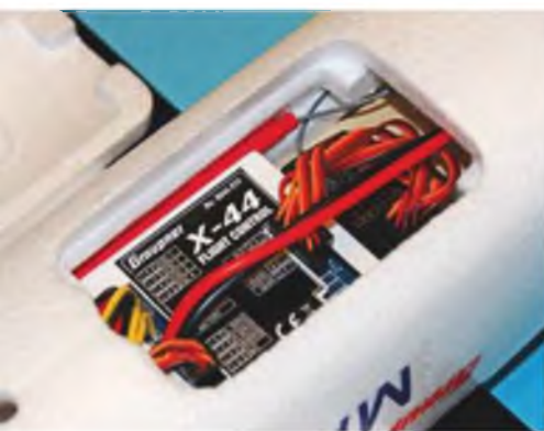
Auf der Unterseite des Modells gibt es einen Wartungsdeckel, unter dem sich die Flugsteuerungsplatine sowie der 2,4-GHz-Empfänger befinden.
