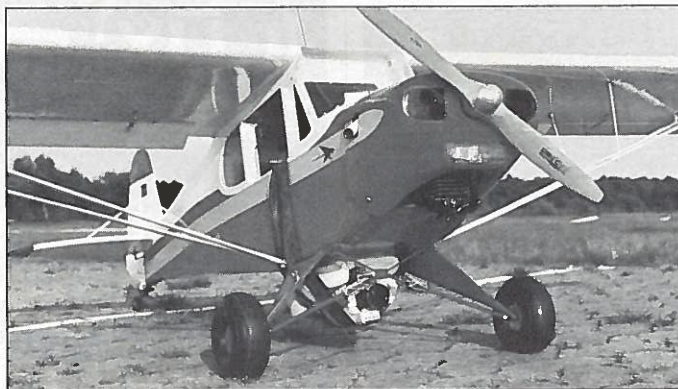
Sehr viel effektvoller sind Aufnahmen, die nach vorn, Richtung Propeller gemacht werden. Da man jedoch nicht durch die Kabinenverglasung filmen kann (Verzerrung), bietet sich das Fahrwerksgestell zur Befestigung der Kamera an
