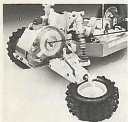
geschmiertes, gekapseltes Getriebe und Vari Lok-Differential
