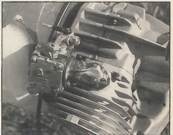
Mit Kupferfittings läßt sich die Lage des Vergasers am Motor variieren und verschiedenen Motorhauben anpassen
