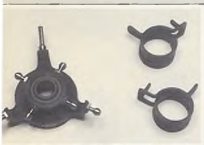
Einen guten Eindruck macht die Taumelscheibe von MW, hier die 120-Grad-Ausführung. Rechts die Spannklemmen für den Teflonschlauch.
