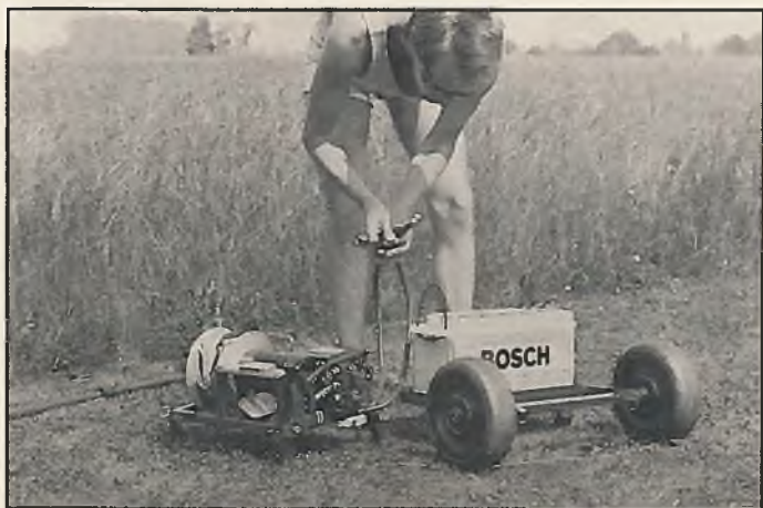
Der Aufbau geht schnell und einfach: Transportwagen aushängen, die beiden Bodennägel in die Erde drücken, Seil auslegen, Batterie anklammern – fertig.
