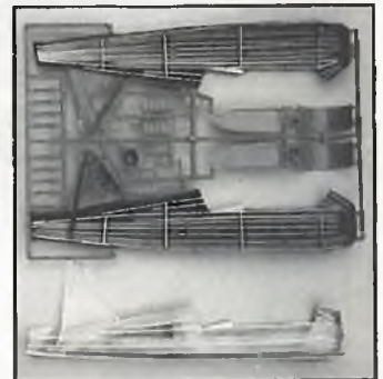
Die Baustadien: Oben ist eine Rumpfhälfte aus Papier, mit Balsaleistenverstärkung, in der Plastikform entstanden. In der Mitte dann die Rumpfhälfte nach dem Entformen, unten ein fertiger Rumpf
