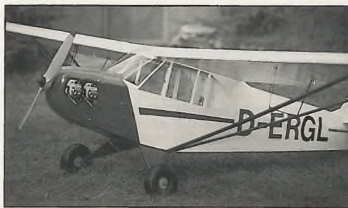
Eine kurze Schnauze, die viel (Motor-)Gewicht braucht, ein großer Flügel, der die Flächenbelastung dennoch niedrig hält: Eine Piper ist das ideale Modell für den „Pegasus“, ein Triebwerk, das auch eine Scale-Motorisierung dieses Flugzeugtyps möglich macht
