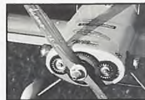
Der Getriebe-Motor, der mit der großen Asano-Luftschraube rd. 22 kp Standschub entwickelt
