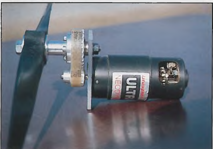
Gewöhnungsbedürftig ist die Anordnung mit dem Stehbolzen. Man soll kaum glauben das hier 2,5 KW übertragen werden können.
