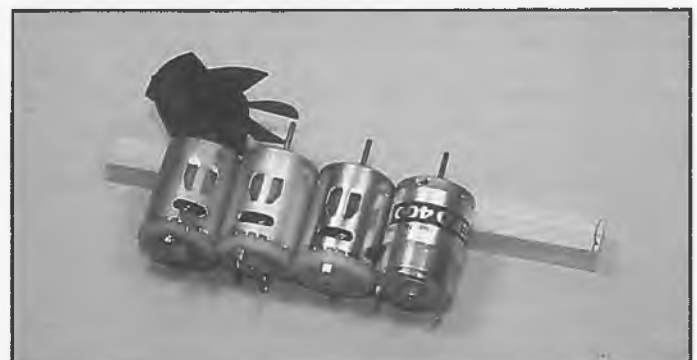
Wie sich die Bilder gleichen! Von links: zwei Recycling-Treiblinge, dann ein Mabuchi 380 und ganz außen der Speed 400
