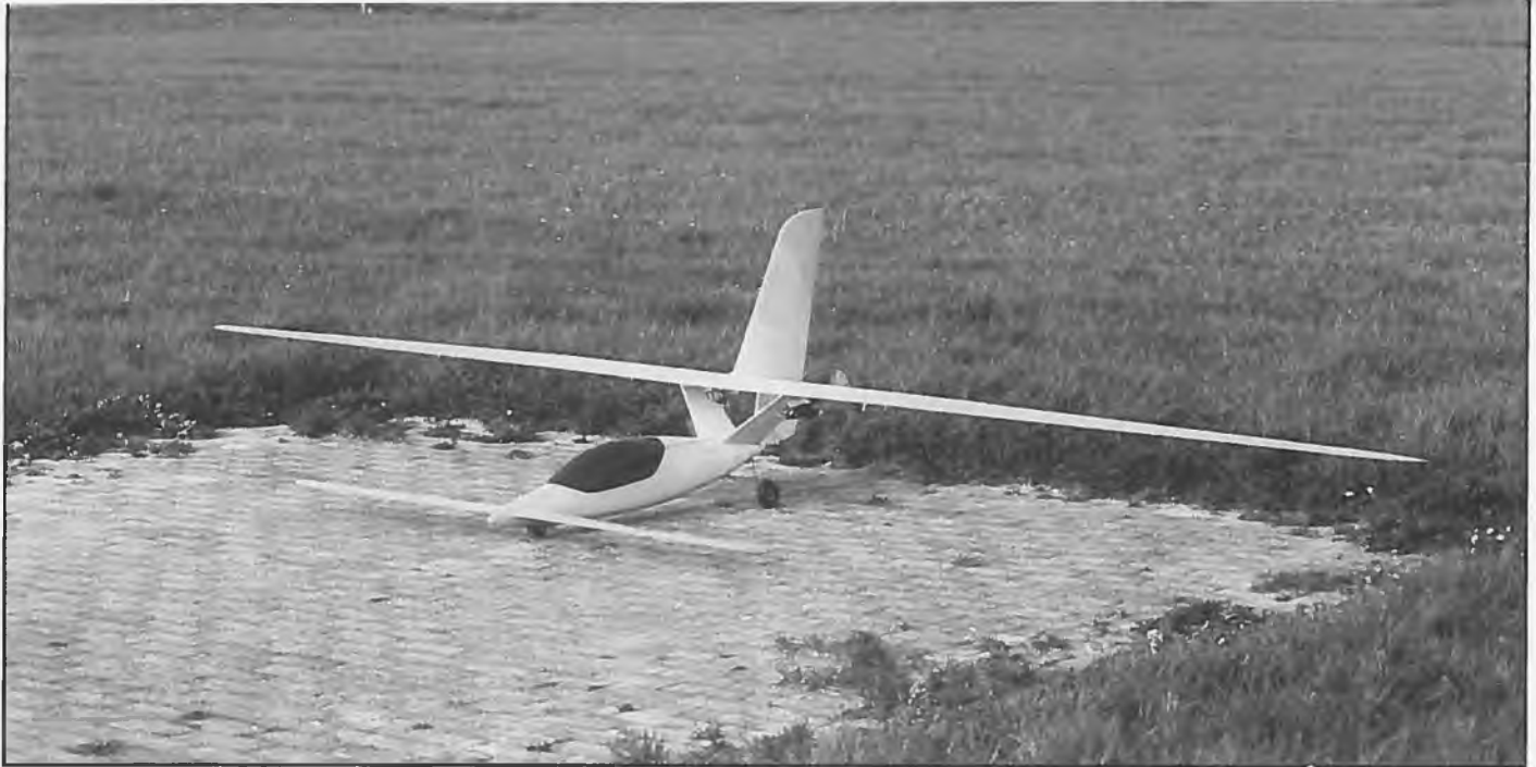
Ein durch und durch originelles Modell, unsere Bauplan-2-Mot-Ente mit Elektroantrieb, hochgesetztem Hauptflügel und über 4 Metern Spannweite
