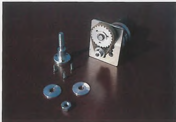
Durch die Abnehmbarkeit der Propellernabe kann das Getriebe leicht für verschiedene Anwendungszwecke geändert werden.
