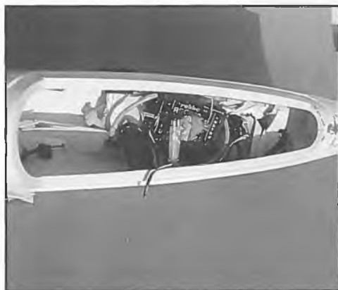
Die Überbleibsel aus einem Absturz, bei dem sich nach einem Looping das Höhenruder (T-Leitwerk) aus der Kunststoffarretierung verabschiedete und das Modell nichts eiligeres zu tun hatte, als sich ungespitzt in den (weichen) Ackerboden zu graben
