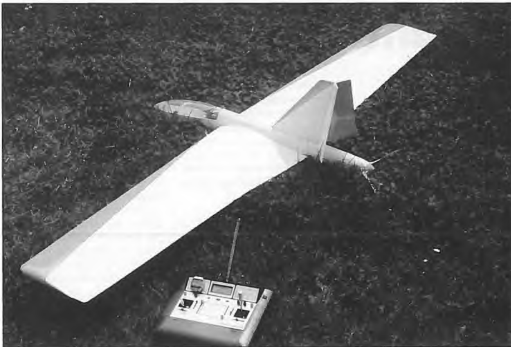
Der „Mini-Tucan“ von Topp fliegt mit Getriebeanmotor und Spreizleitwerk (kein Ruder, sondern Spreizklappe als Luftbremse)
