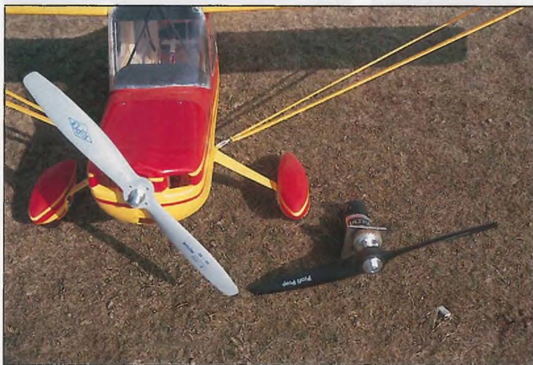
Gewöhnungsbedürftig ist die Anordnung mit dem Stehbolzen. Man soll kaum glauben das hier 2,5 KW übertragen werden können.
