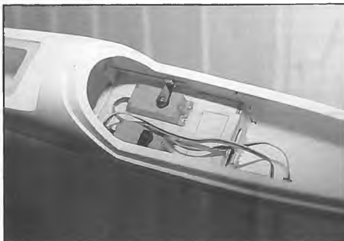
Eine derartige Einbauanordnung von Servos (Empfänger und Regler kämen noch davor) bringt früher oder später mächtigen Verdruß
