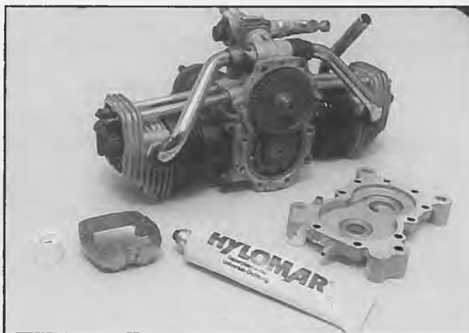
In Zweifelsfällen genügt es oft, einen Gehäusedeckel zu öffnen, um den Grad der Verharzungen oder der befürchteten Korrosion abschätzen zu können
