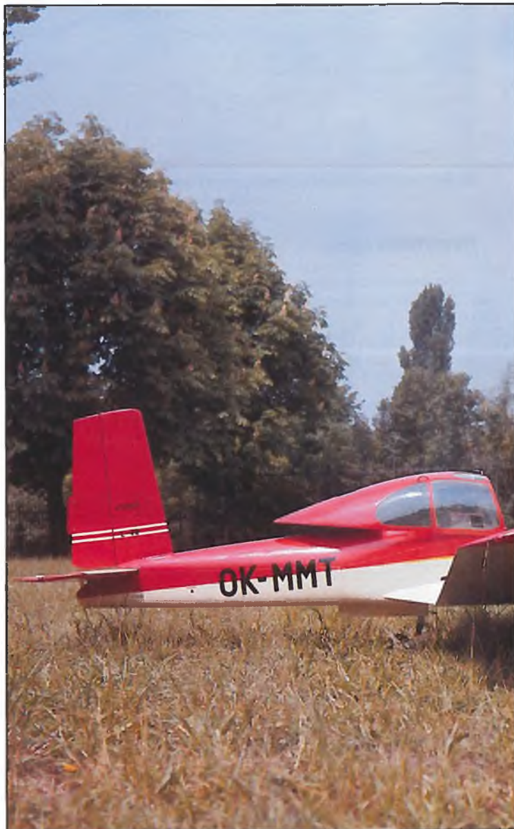
Haube auf, einsteigen! Die Kabinenhaube ist vielleicht das arbeitsintensivste Teil des Modells: Mit Einzelscheiben aus Plexiglas, die zwischen zwei GfK-Schalen eingeklebt werden, das Ganze dann auf dem Rumpf vorbildgetreu beweglich
