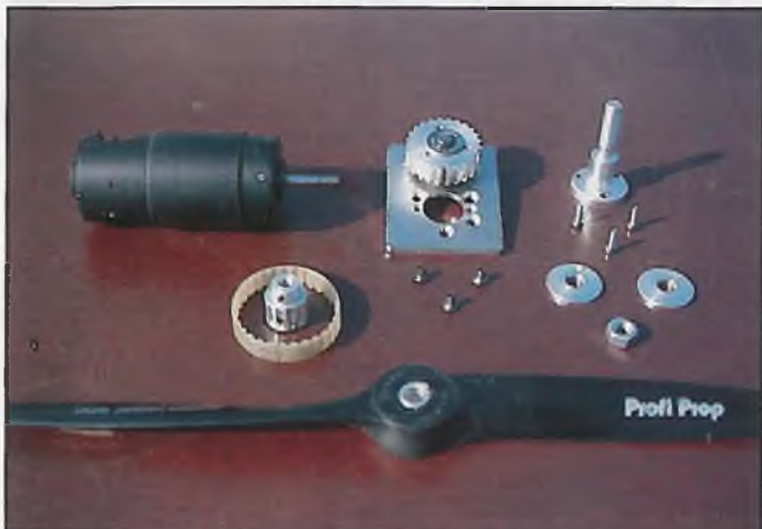
Zerlegt in seine Einzelteile: Dank der einfachen Verschraubung ist der Benutzer in der Lage zur Not auch auf dem Flugplatz ein Teil auszutauschen.
