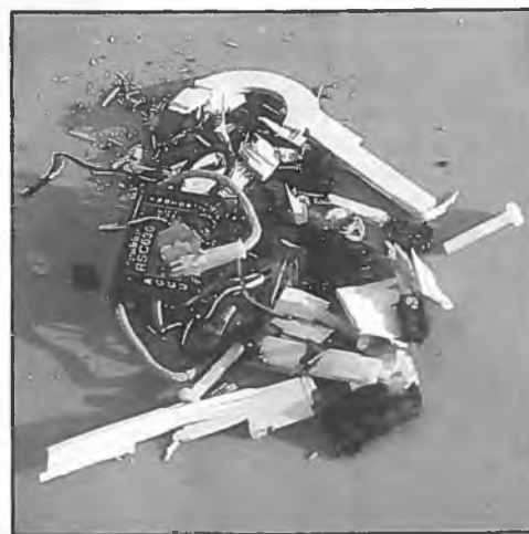
Eine derartige Einbauanordnung von Servos (Empfänger und Regler kämen noch davor) bringt früher oder später mächtigen Verdruß
