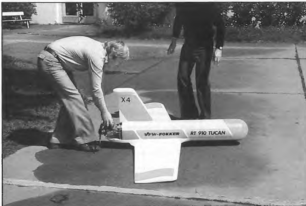
In der Drohnenentwicklung hat man schon vielfach auf das Nurflügelkonzept zurückgegriffen, so auch bei dem „Brett“ von VFW: Das Tucan-Modell wird von einem Benzinmotor in Druckanordnung angetrieben
