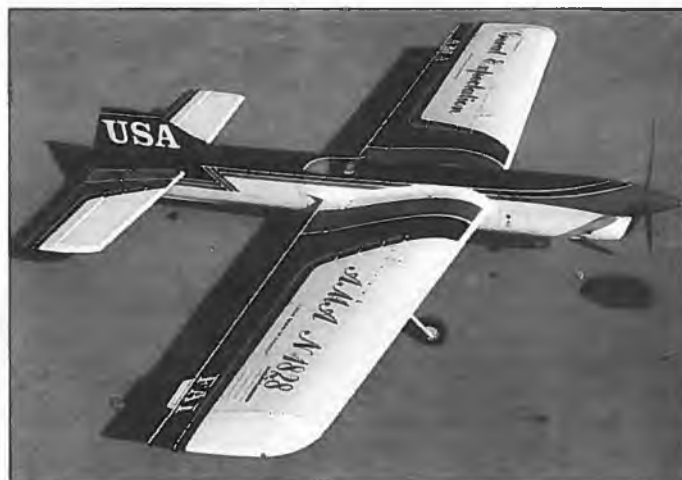
Das wohl eleganteste Flugzeug dieser WM: Ted Fancher, USA, hat ein Auge für harmonische Linienführung und gelungenes Design. Motor OS 46 VF mit Resonanzrohr, Dreiblatt-Kohlepropeller
