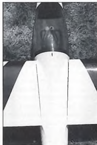
Die Wurzelrippen waren nicht genau genug gearbeitet, dadurch entstand links und rechts ein Spalt zwischen Rumpf und Fläche
