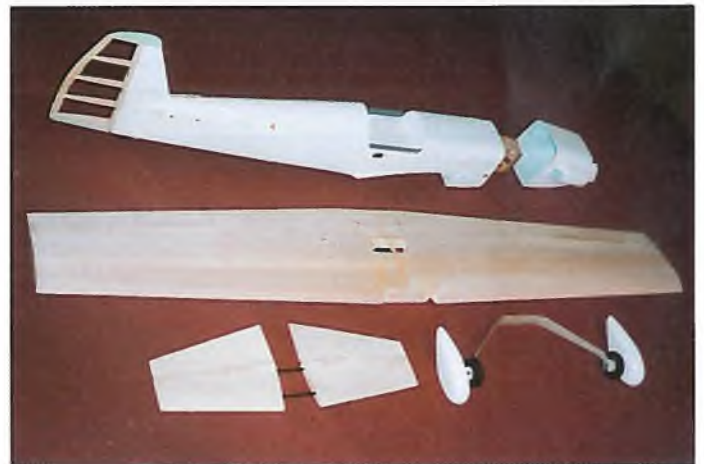
Die „elektrische CAP“: Rumpf als GFK-Fertigteile, SBS-Flügel. Ein Modell, das schnell fertiggestellt werden kann und trotzdem ein für den E-Antrieb notwendiges niedriges Gewicht bei hoher Festigkeit aufweist
