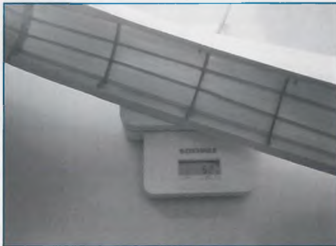
52 g zeigt die Waage für eine Rumpfhälfte
