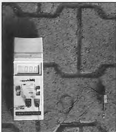
Strommessung: Ein hochbelastbarer Widerstand (0,01Ω oder besser 0,001Ω) wird direkt, ohne lange Leitungen, in den Stromkreis geschaltet
