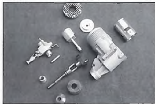
Dieser russische Zweitakter hatte vorne gar ein offenes Lager (!) - hier bot sich also der Austausch direkt an
