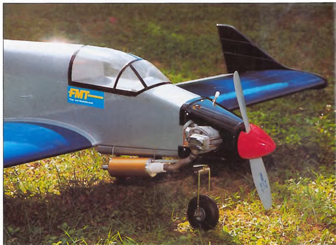
Motor- und Schalldämpfereinbau.
