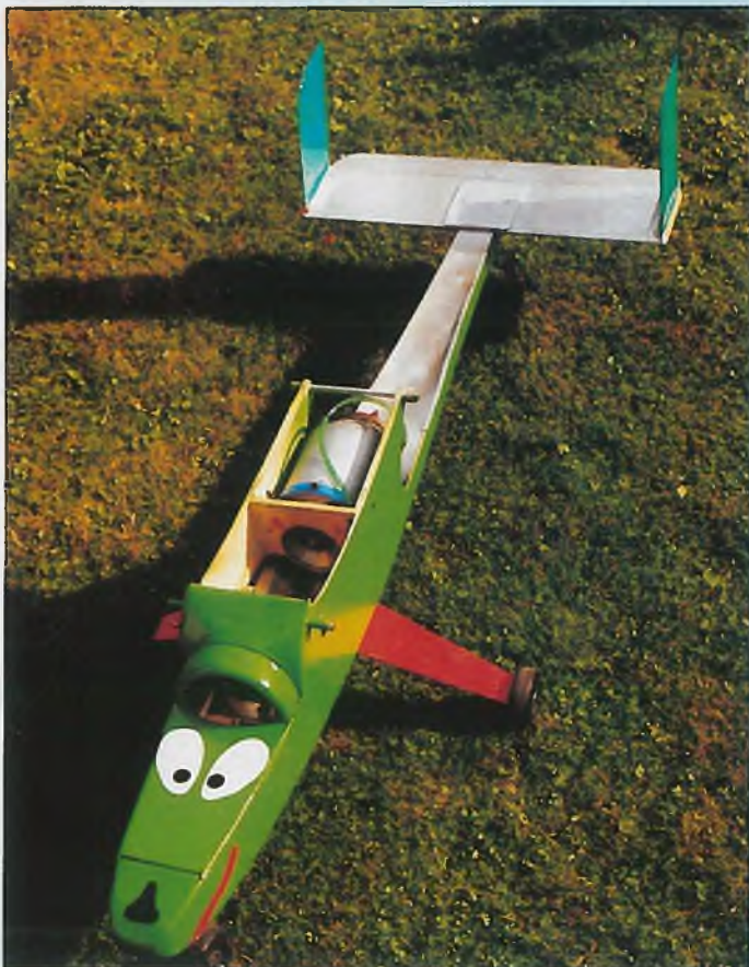
Die eigene Microturbine in ihrer letzten Ausführung. Das Triebwerk wiegt 1150 g und erreicht einen Schub von 45 Newton. Kraftstoff: Kerosin Typ Jet A1
