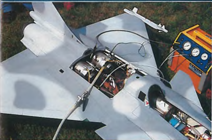
Jet-Technologie: Zweisporiges Scale-Modell. Der schweizer Pilot Franz Walti baute eine 2,35 lange Dassault Rafale B01 mit zwei JPX T-240 für die letzten Weltmeisterschaften. Hier wird der große technische Aufwand deutlich, um ein solches Projekt erfolgreich durchzuführen: Zwei Propanantanks nebeneinander in der Nase, zweifache Öl-, Luft- und Kraftstoffanschlüsse im Motorraum. Dieses 15 kg-Modell hatte eine Menge „Dampf“ und ist mit etwa 280 km/h recht schnell unterwegs
