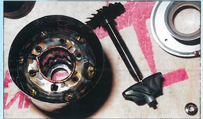
▲ Blick auf das Innenleben des Triebwerkes. Der Kraftstoff wird mittels sechs feiner Kanülen in die Brennkammer eingespritzt
