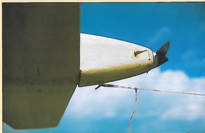
Ein nachträglich im Rumpfvorderteil angebrachter Haken erlaubt sichere Starts am Gummiseil. Ebenfalls erkennbar: Verbesserter Kühllufteinlaß.
