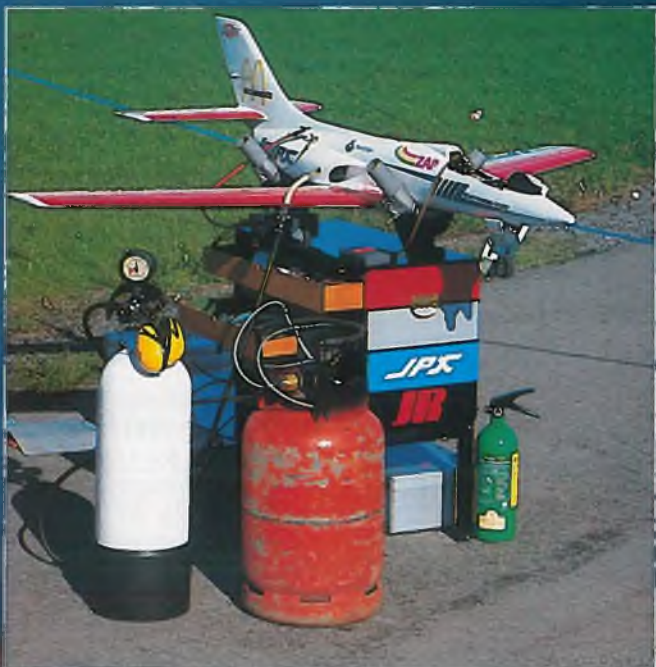
Jet-Technologie: Zweisporiges Scale-Modell. Der schweizer Pilot Franz Walti baute eine 2,35 lange Dassault Rafale B01 mit zwei JPX T-240 für die letzten Weltmeisterschaften. Hier wird der große technische Aufwand deutlich, um ein solches Projekt erfolgreich durchzuführen: Zwei Propanantanks nebeneinander in der Nase, zweifache Öl-, Luft- und Kraftstoffanschlüsse im Motorraum. Dieses 15 kg-Modell hatte eine Menge „Dampf“ und ist mit etwa 280 km/h recht schnell unterwegs
