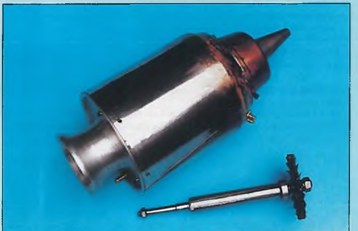
Die eigene Microturbine in ihrer letzten Ausführung. Das Triebwerk wiegt 1150 g und erreicht einen Schub von 45 Newton. Kraftstoff: Kerosin Typ Jet A1
