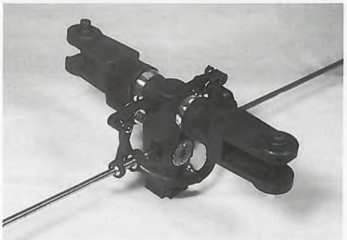
▲ Eine gelungene Mischung aus Futura- und Moskito-Komponenten ist der Rotorkopf. Die beiden Alu-Bundscheiben am Zentralstück dürften sicherlich zum Markenzeichen des Super Sport werden
