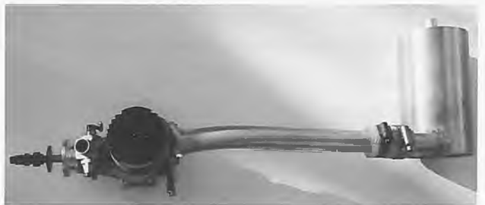
▲ Die Beispiele verdeutlichen in etwa den Raumbedarf der Anlage bei Verwendung eines handelsüblichen Krümmers und in unterschiedliche Stellungen gedrehten Dämpfers
