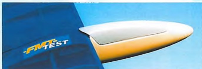
Der einzige Unterschied von Segler und E-Version ist die abgeschnittene Rumpfspitze. Alle anderen Teile sind kompatibel.
