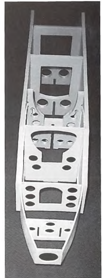
Der Rumpf: Roofmate- und Sperrholz als Baustoff
