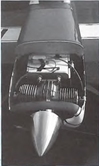
Gute Zugänglichkeit zum 3W-120 samt Zündanlage und Akku durch ein abnehmbares Oberteil der Motorhaube
