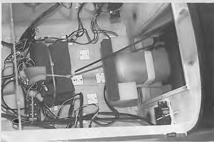
Zunächst sieht es hier nach einer gewissen Unordnung aus, doch die wichtigsten Grundsätze werden eingehalten: Fixieren der Kabel durch Halteschellen, um Vibrationsbrüche zu vermeiden. Markieren und Beschriften der einzelnen Leitungen. Bündelung parallel verlaufender Kabel
