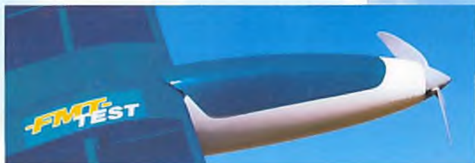
Der einzige Unterschied von Segler und E-Version ist die abgeschnittene Rumpfspitze. Alle anderen Teile sind kompatibel.
