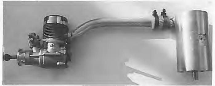
▲ Die Beispiele verdeutlichen in etwa den Raumbedarf der Anlage bei Verwendung eines handelsüblichen Krümmers und in unterschiedliche Stellungen gedrehten Dämpfers
