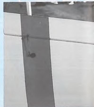
Anlenkung des Höhenruders über zwei Servos
