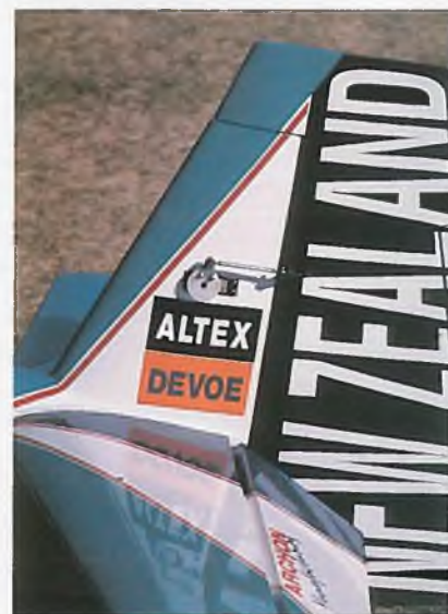
Gut zu sehen eines der beiden Leitwerk-Servos. Vorrang hatte die Zweckmäßigkeit.
