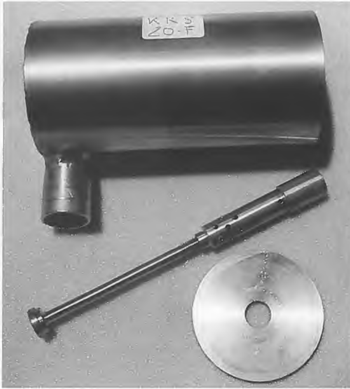
◀ Einzelteile: Rohr, Rückplatte und die alles zusammenhaltende Durchgangsschraube mit der kleinen, zweiten Dämpferkammer
