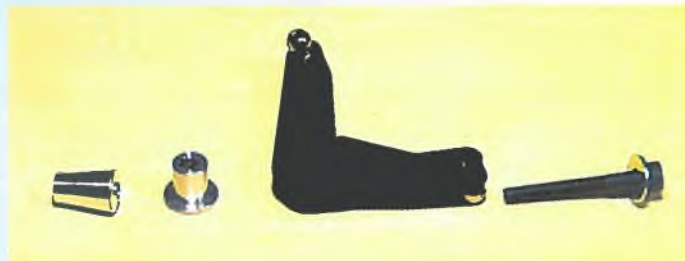
Die Gleitlagerung des Umlenkhebels ist recht aufwendig, bedarf aber noch der Feinabstimmung. Ist von Robbe bereits zugesichert
