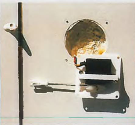
Die im Test erwähnte Servobefestigung á la Servolock – eine saubere Sache, und was das Schönste ist, sie liegen dem Baukasten bei.
