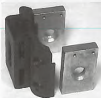
▲ Eine gelungene Mischung aus Futura- und Moskito-Komponenten ist der Rotorkopf. Die beiden Alu-Bundscheiben am Zentralstück dürften sicherlich zum Markenzeichen des Super Sport werden
