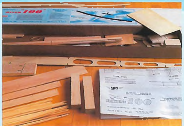
Der Baukasten enthält viel Holz zum Sägen und Feilen, aber auch Fertigteile in guter Stanzqualität. Alles ist übersichtlich in Baugruppen mit Schlüsselpositionen geordnet
