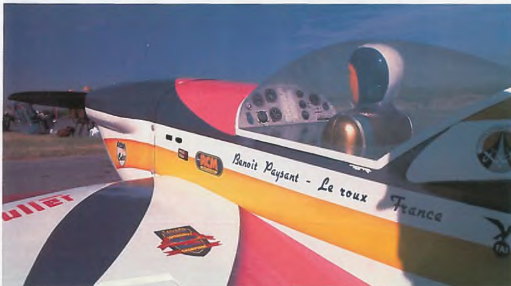
Im „Tournament“ müssen die Modelle auch im Cockpit realistisch sein: Also Pilot und Instrumentenpaneel dürfen nicht fehlen. Aus Gewichtsgründen werden sie jedoch einfach gehalten
