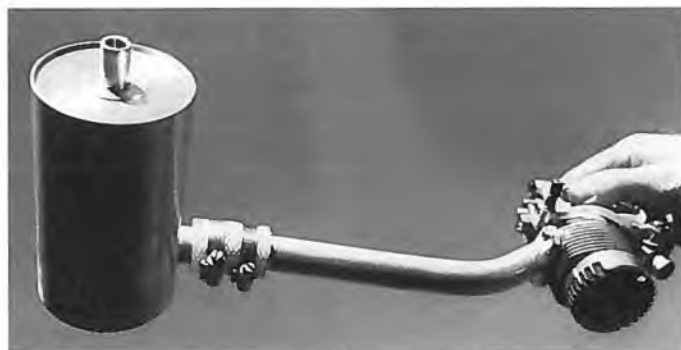
Resonanzschalldämpfer-Anlagen moderner Hochleistungsweitakter sind verhältnismäßig große Gebilde. Mit dem Habsburg-Rohr wird eine kompakte Lösung angeboten. Aber der seitliche Dämpfereinlaß ist noch nicht optimal und lange Krümmer braucht man selbstverständlich auch
