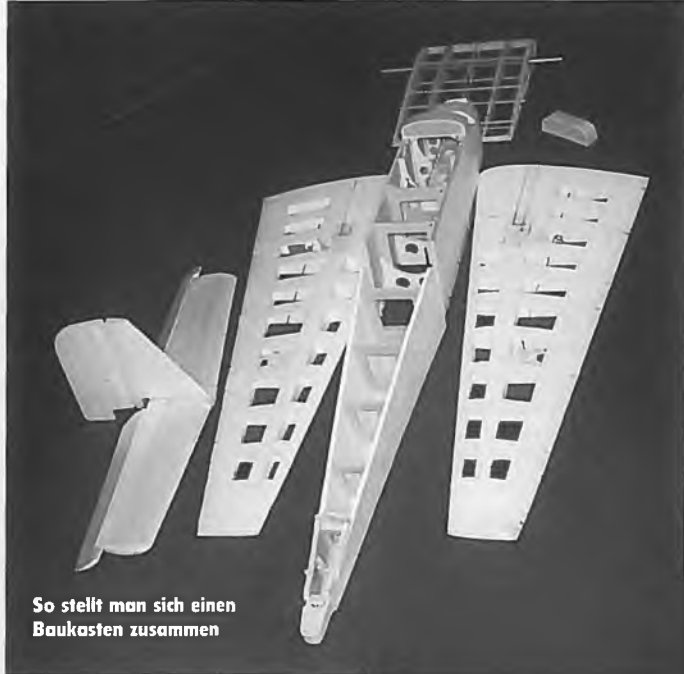
Der Flügel: Mittelstück in Rippenbauweise, Außenteile beklant Styropor in SBS-Bauweise
