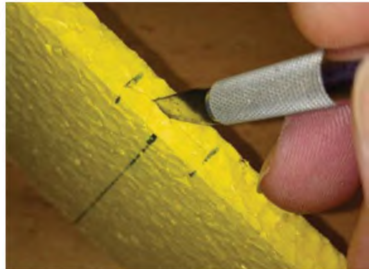
Die Vliesscharniere werden mit dünnflüssigem Sekundenkleber in die Ruderflächen eingeklebt. Vorher schneidet man mit einem scharfen Messer einen passenden Schlitz in das EPP.
