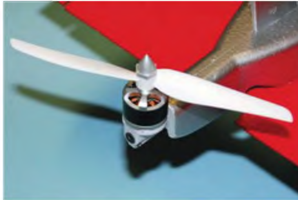
Der Motor im Heck dient nur als Hubtriebwerk und ist im Reiseflug ausgeschaltet. Zum Gieren um die Hochachse wird er im Schwebeflug seitlich geschwenkt...
