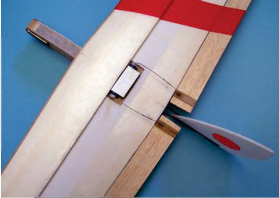
Hier ist der Flügel komplettiert mit Querruder und Schubstangen. Der Rumpf ist mit Tape verschlossen.
