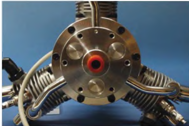
Die Rückseite des Ansauggehäuses zeigt Erleichterungsbohrungen. Im Zentrum der thermisch entkoppelte Stutzen für den Vergaser.
