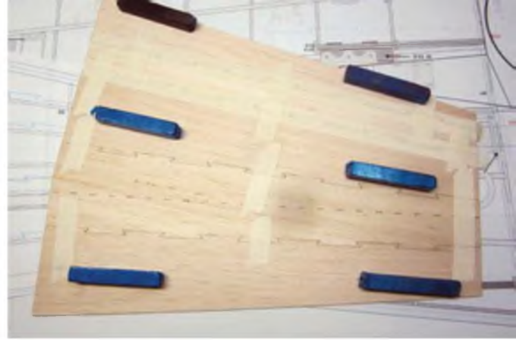
Die Beplanungsfelder werden aus mehreren Elementen zusammengesetzt.
