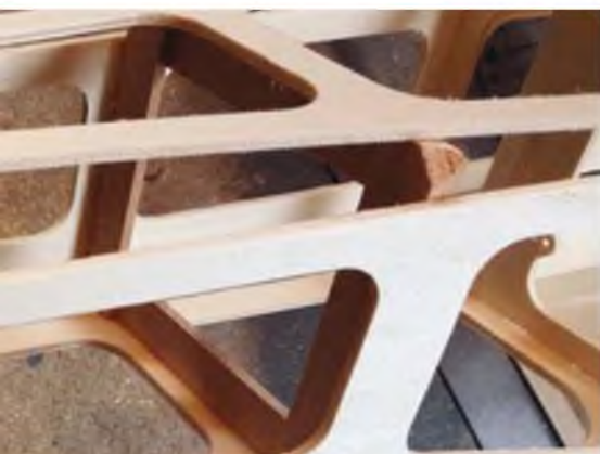
Zwei Hilfspannen werden aus 2- bis 3-mm-Balsaresten gebaut und im Rumpferüst positioniert.
