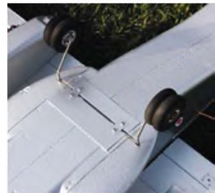
Das Fahrwerk ist sehr robust ausgeführt, so dass auch dynamische Starts und Landungen auf Rasen kein Problem darstellen.
