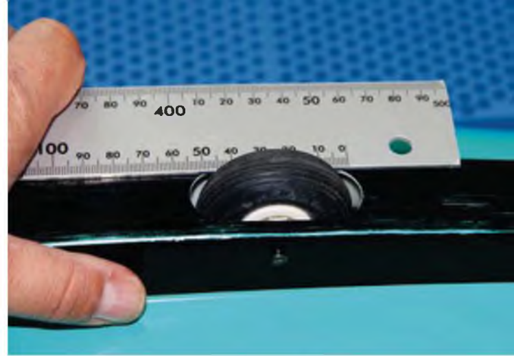
Das kleine Stützrad sollte auf unebenen Grasplätzen mindestens 50 mm Durchmesser haben – am Lackabrieb der Kufenkante ist zu erahnen, wie gut der Rumpf im Gras dennoch bremsst.
