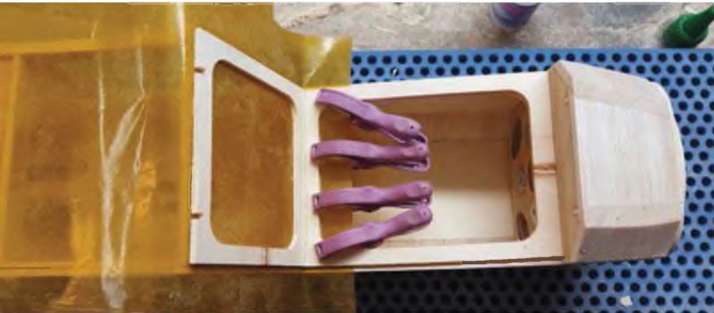
▲ ▼ Die Kabinenhaube wird passgenau auf dem Rumpf aufgebaut – nicht vergessen: beim Kleben Folie zum Trennen unterlegen.
