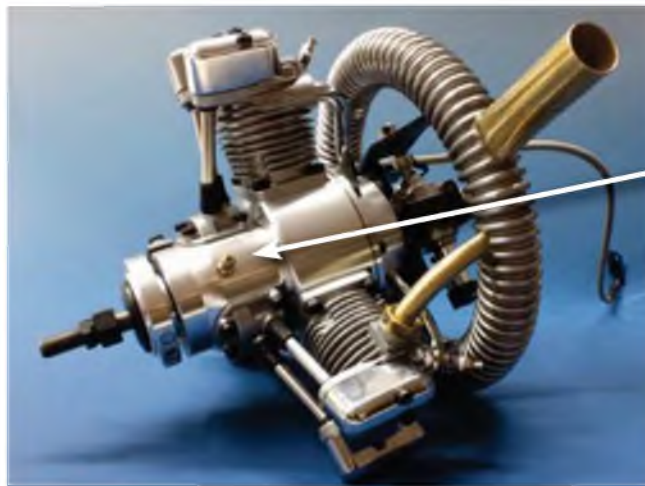
Die Kurbelgehäuseentlüftung hat eine sehr kleine Bohrung, wird sie etwas erweitert, kann der Saito die heißen Leckgase besser abführen.
