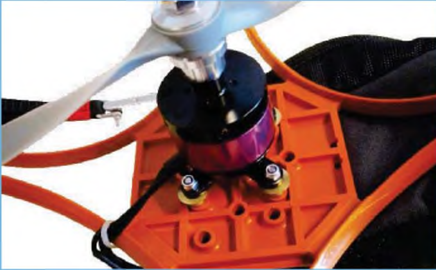
Als Antrieb ist im Rucksack-Set ein Hacker A30-285-Motor und ein Hacker-X-40-Regler enthalten.
