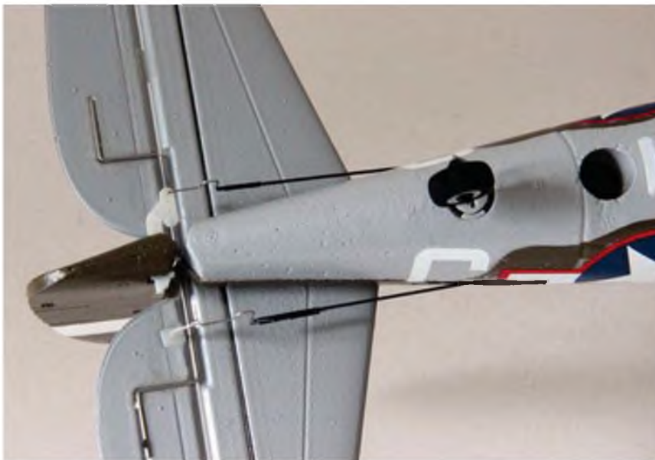
Auch Höhen- und Seitenleitwerk sind schon komplett fertig angelenkt. Das Sponrad ist sogar lenkbar und kann ebenso abclipst werden.
