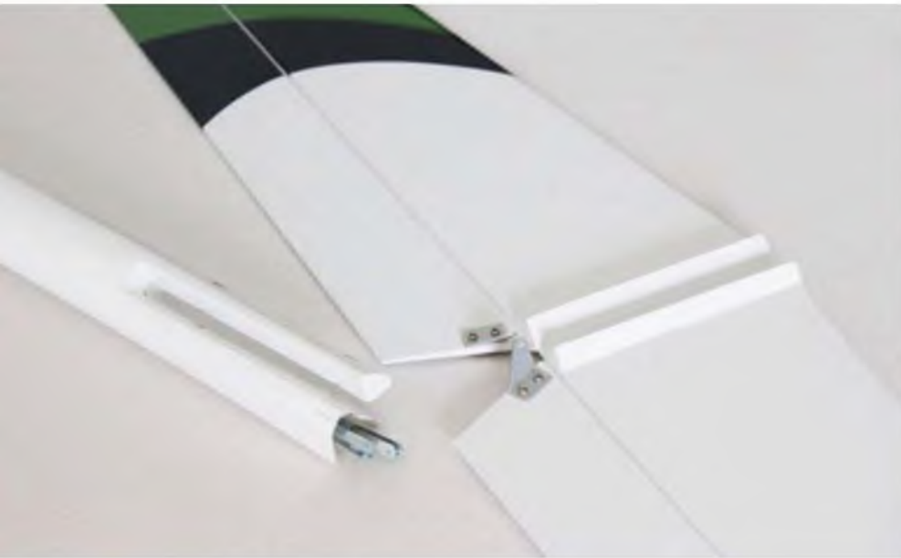
Die V-Leitwerkshälften sind durch Bügelfolie verbunden und werden mit den Dreiecksaufleimern hinten in den Rumpf eingeschoben und durch Schrauben geklemmt.
