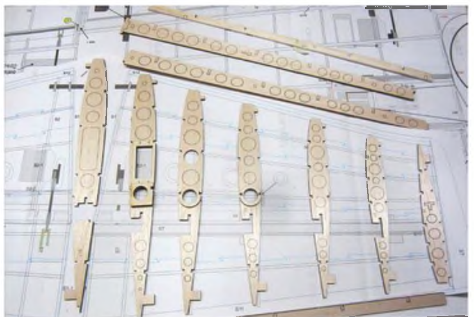
Die Laserteile sind von guter Qualität und äußerst passgenau – hier die ersten Teile für ein Höhenleitwerk.
