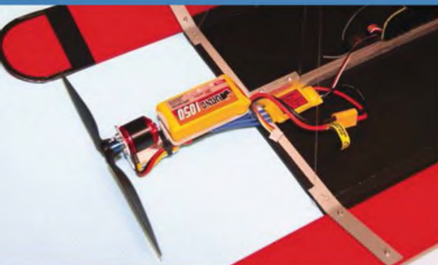
Der Motor wird mit dem beiliegenden Montagewinkel auf dem ebenfalls fertig vorbereiteten Träger verschraubt. Direkt dahinter sitzt der mit Klettband fixierte Akku.
