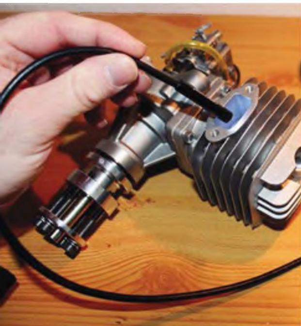
Hier ist die Endoskop-Kamera im Einsatz zur Kontrolle der Kolbenoberfläche und des Brennraumes.
