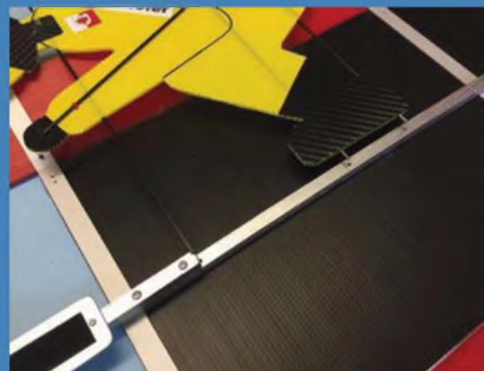
Den Skifahrer befestigt man mit Hilfe von drei CFK-Stäben am mittleren Rahmenteil. Die Rundstäbe versteifen gleichzeitig auch die Figur.
