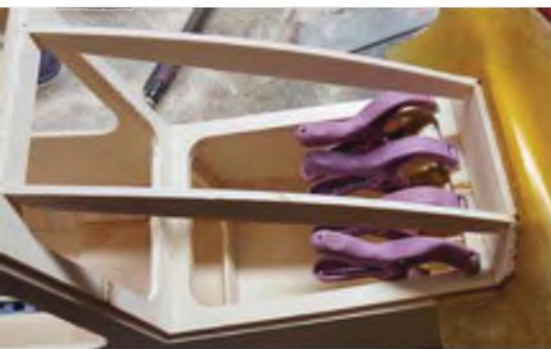
▲ ▼ Die Kabinenhaube wird passgenau auf dem Rumpf aufgebaut – nicht vergessen: beim Kleben Folie zum Trennen unterlegen.
