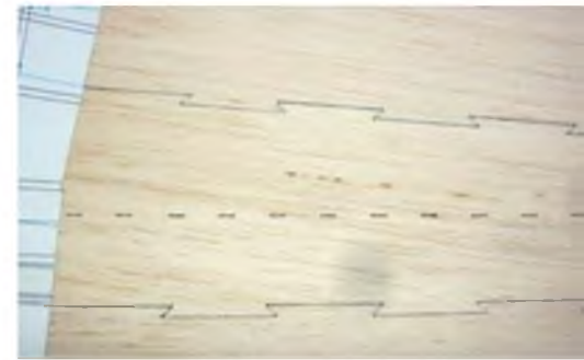
Die Beplanungsfelder werden aus mehreren Elementen zusammengesetzt.
