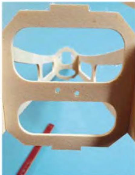
Die Bowdenzüge für Höhen- und Seitenruder laufen über Kreuz – die Spanten S7 und S9 müssen entsprechend ihrer Vorder- und Rückseite richtig eingesetzt werden.
