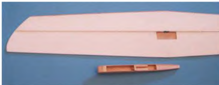
Auf diesem Bild ist der Flügel fertig geschaped. Unten liegt der verklebte, von oben offene Rumpf. Man beachte den Kabelkanal.
