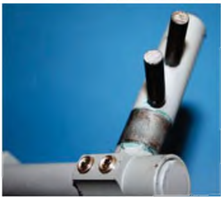
Seitliche Last verträgt das Fahrwerk nicht so gut – die Schwachstelle der ersten Serie wurde bei Robart mittlerweile erkannt und durch die Verwendung von gehärteten Stahlstiften beseitigt.
