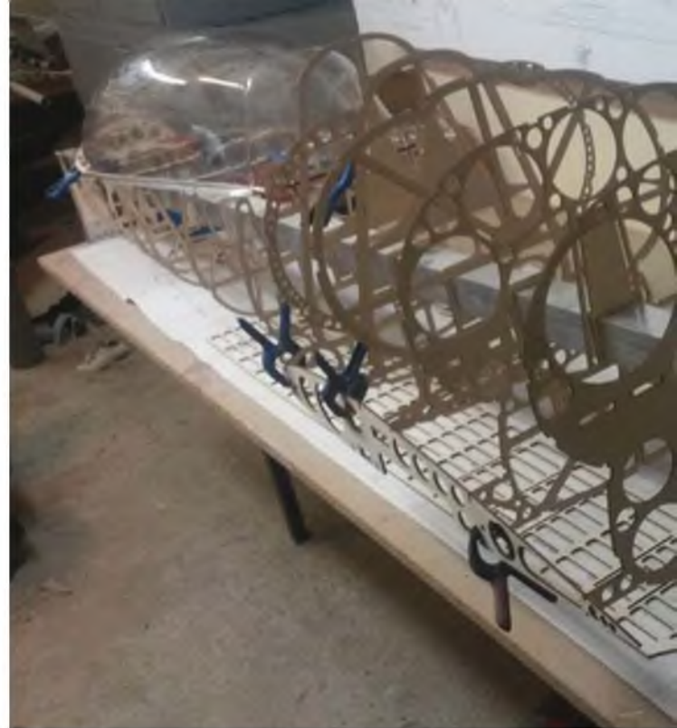
Im zweiten Schritt werden die Spanten in der richtigen Reihenfolge auf ein Alu-Vierkant aufgefädelt.
