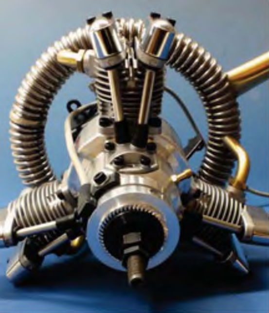
Mit dem Ringdämpfer von Gerhard Hielscher ist der Antrieb eine kompakte Einheit.
