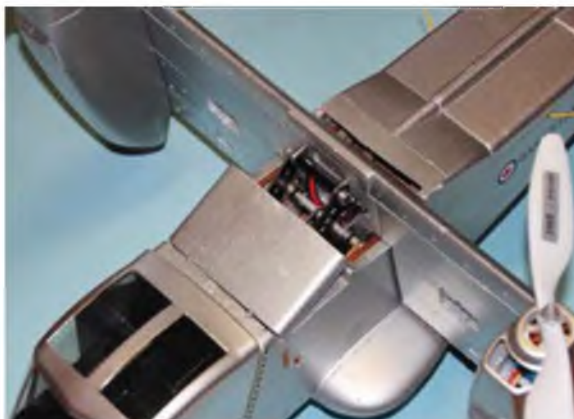
Die Tragfläche ist mit der Mechanik fest am Rumpf verschraubt und nicht abnehmbar – was dank der kompakten Abmessungen des Modells jedoch kein Problem darstellt.
