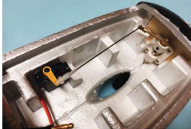
Das Bugrad kann auf Wunsch angelenkt werden, wofür noch ein zusätzliches 9-g-Servo nötig ist. Beim Serienmodell sind passende Anlenkungsteile enthalten, beim Testmodell war das noch nicht der Fall.
