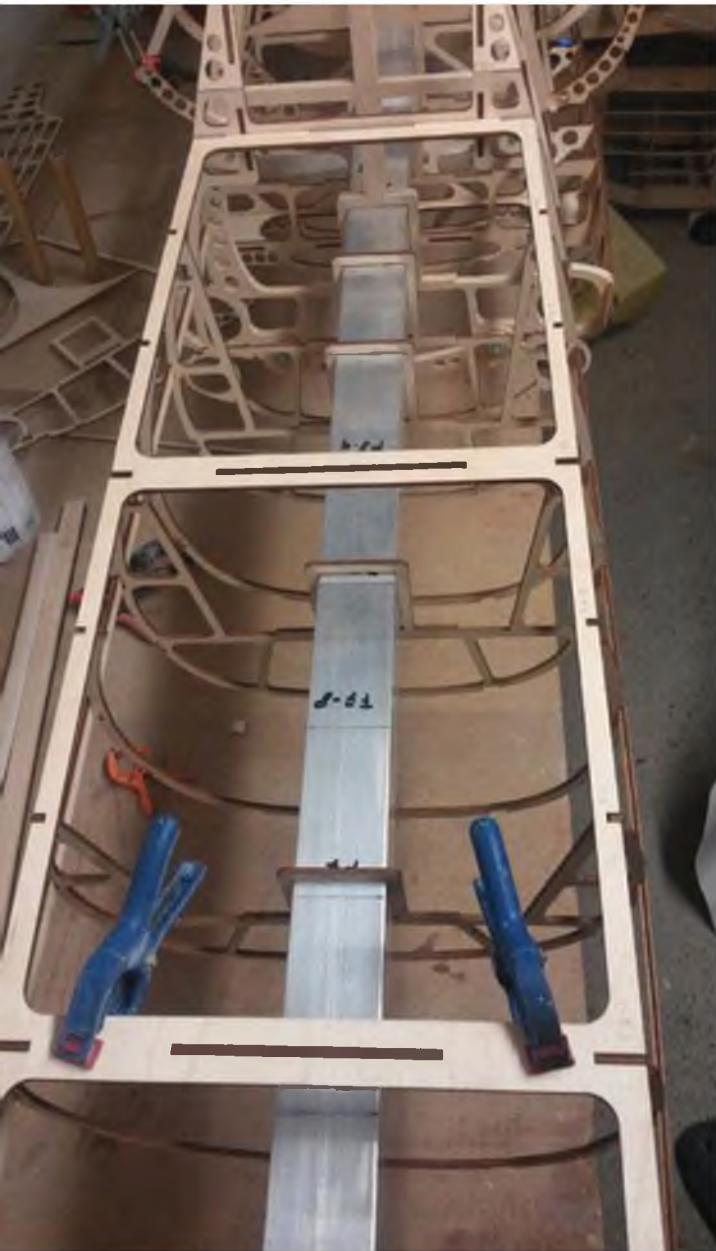
Durch zahlreiche Verzapfungen – hier im Bereich der Kabinenhautenauflege – werden die Spanten zueinander ausgerichtet.
