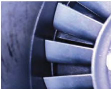
Beispielbilder: Die Inspektion des Turbinenrades kann erfolgen, ohne das Triebwerk ausbauen zu müssen. Schlauch- und Kabeldurchführungen können ebenso einer Sichtprüfung unterzogen werden wie die Qualität von Verklebungen.
