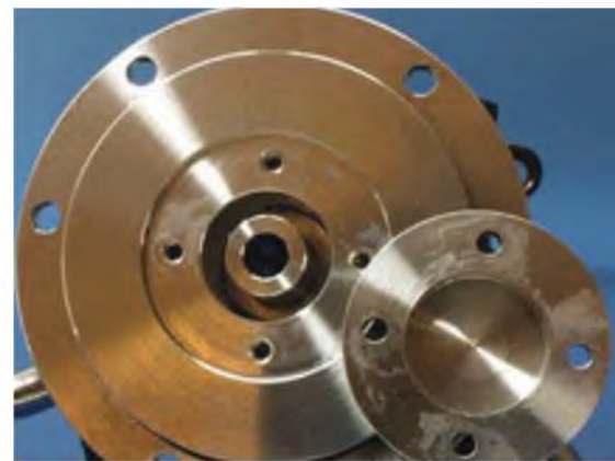
Das Ansauggehäuse mit zentralem Frischgas-eintritt, Volumenkörper zur Verwirbelung und symmetrischen Saugrohren.
