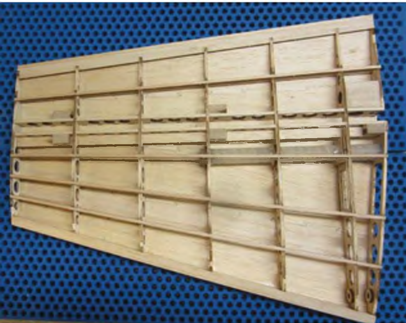
Eine Höhenleitwerkshälfte vor dem Aufbringen der Beplankung.
