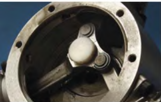
Sichere Sache: Das Hauptpleuel wird formschlüssig durch einen PTFE-Pilz auf dem Kurbelzapfen gehalten, hier kann sich nichts lösen.
