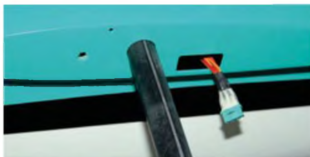
Der 20-mm-CFK-Steckungsstab wurde für ein bequemeres Aufrüsten längs mit einer Abluft-Nut versehen.
