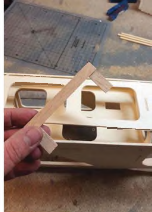
Auch zwischen Spant 4 und 5 wird ein selbstgefertigter Balsahalbspan eingesetzt.
