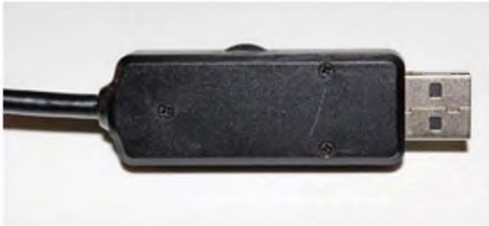
Mit dem Regler am USB-Stecker kann die Helligkeit der Beleuchtung stufenlos eingestellt und auch komplett abgeschaltet werden.
