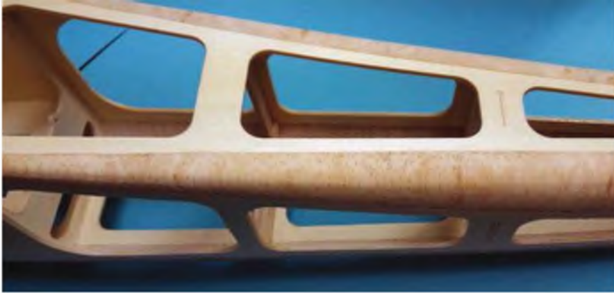
Nach dem Schliff sollte das Ergebnis so aussehen – hier das Rumpfhinterteil.
