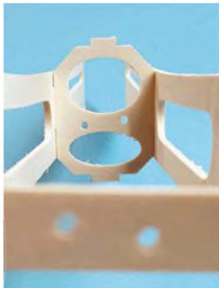
Die Bowdenzüge für Höhen- und Seitenruder laufen über Kreuz – die Spanten S7 und S9 müssen entsprechend ihrer Vorder- und Rückseite richtig eingesetzt werden.
