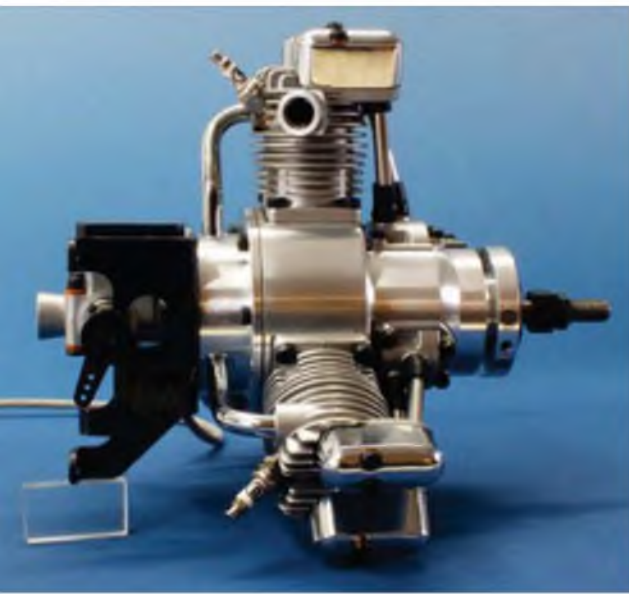
Von den Anschraubblasen bis zur Propellerebene misst das Triebwerk 130 mm.
