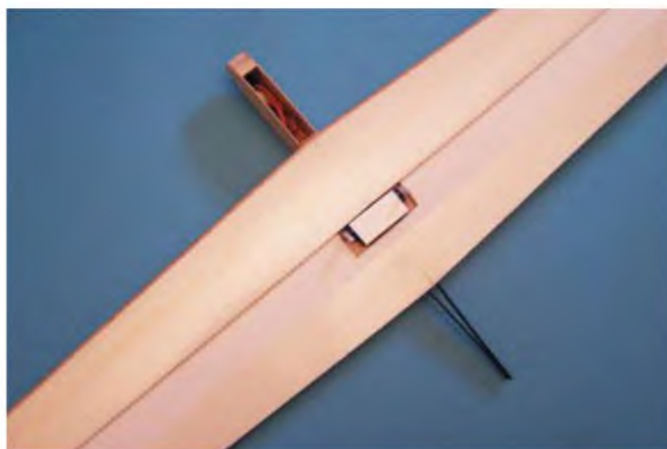
Der fast fertige Flügel von oben. Die Servos sind mit 5-Minuten-Epoxid aufgeklebt. Vorher werden sie mit Tape umwickelt, damit sie im Schadensfall ausgetauscht werden können.
