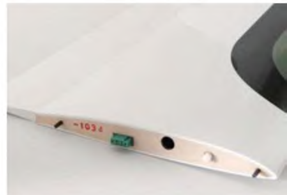
Der Hersteller hat beim PNP-Modell sogar den kompletten Flächenanschluss mit Multiplexstecker, Multilock-Flächensicherung, CFK-Arretierungsstiften und 10-mm-CFK-Verbinder fertiggestellt.
