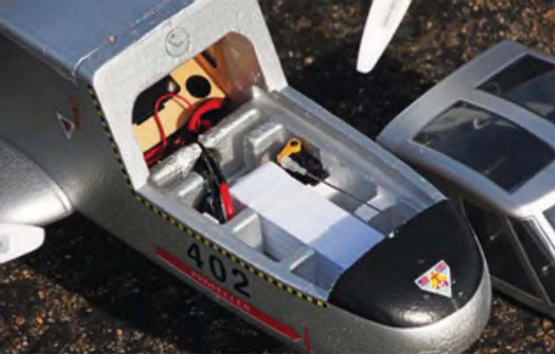
Der Akku findet im geräumigen Rumpf gut Platz, eine zusätzliche Sicherung ist nicht erforderlich.
