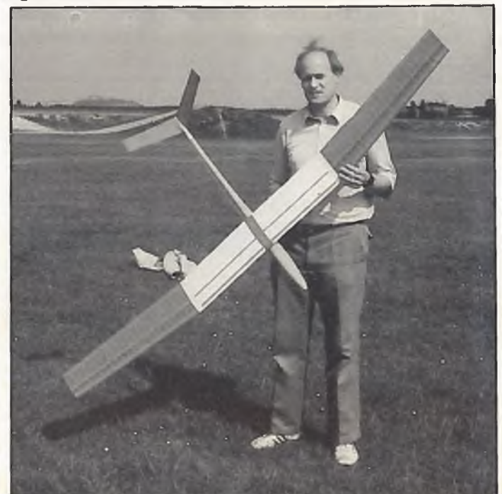
Abb. 1a: Der V-Leitwerksegler des Autors mit unbefriedigenden Flugeigenschaften.
