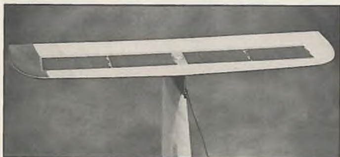
Sehr aufwendig und perfekt: Einlamierte Solarzellen im Höhenleitwerk des F3E-Modells von F. Weißgerber
