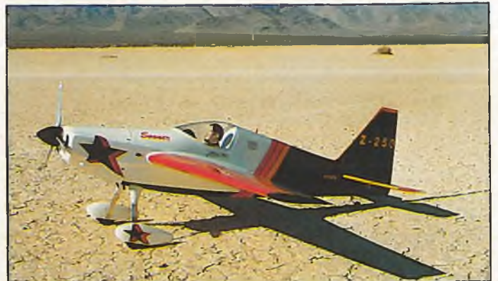
Bei der Wigens Z-250 handelt es sich um eine Konstruktion, der die bekannten „Stephens Acro“ und „Laser“ zugrunde liegen. Die Änderung betrifft nur den Rumpf. Sehr schön, originell und auch aufwendig die Lackierung. Die Sterne sind z. T. vierfarbig mit Trennlinien
