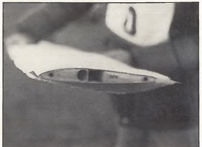
Bild links: Das ist nicht die Speed-Version, sondern der Rumpf mit dem Holm ohne aufgesteckte Flächen
