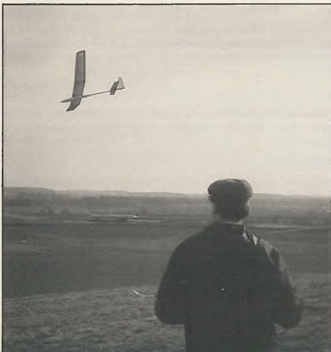
Abb. 1b: Der gleiche Segler nach Umrüstung auf Normalleitwerk. Die Flugstabilität wurde dadurch erheblich verbessert. ▼
