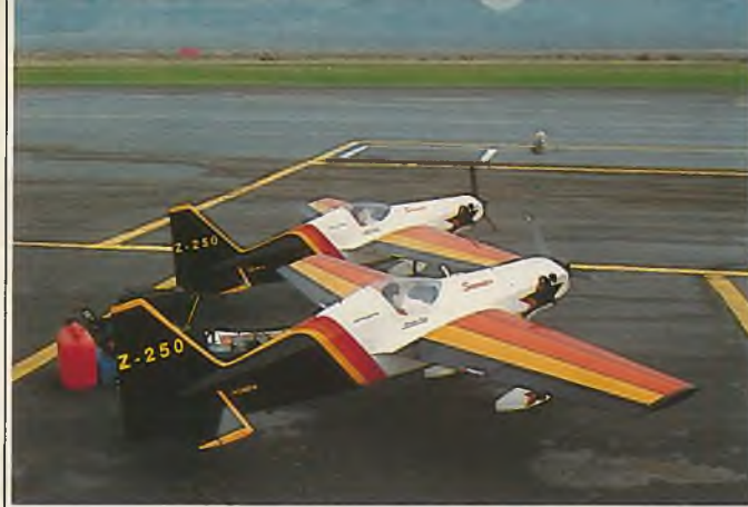
Die beiden Wigen auf der Piste. Spannweite der Flugzeuge 2,32 m, Fluggewicht 9 kg. Da Prototypen immer etwas schwerer ausfallen, ist bei Nachbauten ein niedrigeres Gewicht erzielbar
