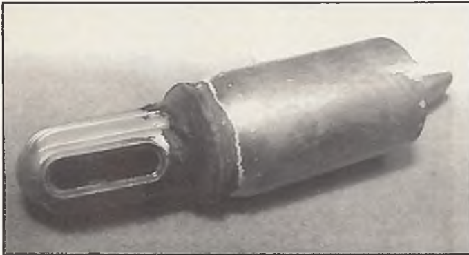
Beim Verkleben mit der Silikon-Kunstharzmasse auf üppigen Materialauftrag achten
