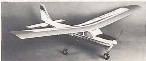
ALPHA II – das Anfängermodell DM 139,50 Spannweite 1,48 m; Motor ab 3,5 cm 3 ; gutmütige Flugeigenschaften; für Anfänger und erholsames Fliegen; GfK-Rumpf und beplankte Styroportragflächen; preiswerter Schnellbaukasten mit Alu-Motorträger, lenkbarem Bugfahrwerk, usw.
