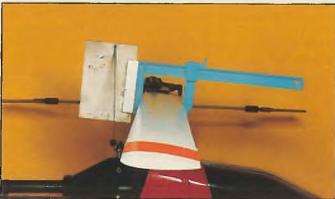
Die Einstellzwinge im Gebrauch. Der Einstellwinkel ist nahezu stufenlos ablesbar (siehe nächste Seite).
