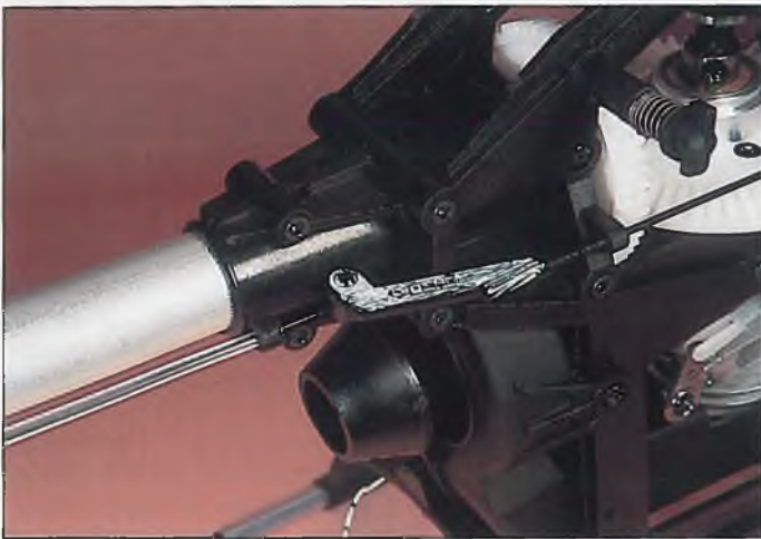
Die ominöse Umlenkung des Hecksteuerdrahtes, hier weiß eingeführt zur besseren Erkennbarkeit, ...
