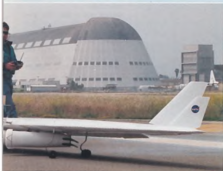
Experimental-Jet: Die NASA betreibt Modellflug, mit einem ganz exotischen Fluggerät, einem Nurflügel, der zur Widerstandsminderung „gepeilt fliegt“ – er wird schräg zur Flugrichtung gestellt. Bericht in der Jet-Kolumne, Seite 26
