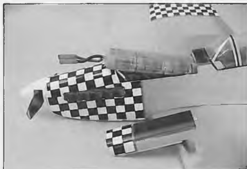
Der Antriebsakku ist über den Rumpflügeldeckel bestens zugänglich
