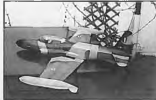
Lockheed T-33 Spannweite: 1300 mm, Lnge: 1040 mm Fluggewicht: 1190 g, Profil: gerade Unterseite RC-Funktionen: Seite, Hhe, Quer, Blattzahl: 1 Fertigteile: Kabinenhaube Best.-Nr.: MT/JB 0908, Preis: 35,- DM
