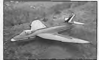
Hawker Hunter Spannweite: 1110 mm, Lnge: 1190 mm Fluggewicht: 1450 g, Profil: Halbsymmetrisch RC-Funktionen: Seite, Hhe, Quer, Blattzahl: 1 Fertigteile: Kabinenhaube Best.-Nr.: MT/JB 0912, Preis: 40,- DM
