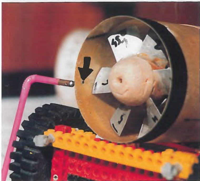
Mit dem Pfeil markiert: Die Meßbohrung für den Manometeranschluß
