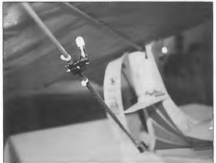
Für die Lämpchen am Gestänge sind Fassungen montiert. Dort, wo es aus Transportgründen notwendig ist, haben die Kabel Steckverbindungen
