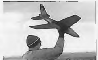
Alpha-Jet Spannweite: 1030 mm, Lnge: 880 mm Fluggewicht: 890 g, Profil: Vollsymmetrisch RC-Funktionen: Seite, Hhe, Quer, Blattzahl: 1 Best.-Nr.: MT/JB 0915, Preis: 35,- DM
