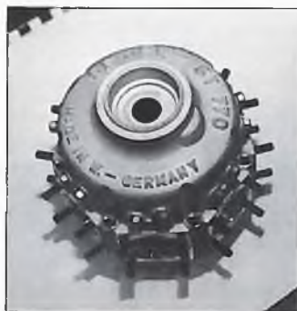
Viertakt-Ausnahme: Sternmotoren saugen das Kraftstoffgemisch meist durch das Kurbelgehäuse an - verminderte Korrosionsgefahr
