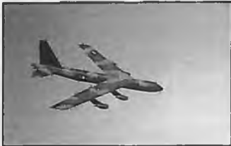
B-52 Stratofortress Spannweite: 1700 mm, Lnge: 1370 mm Fluggewicht: 1390 g, Profil: vollsymmetrisch RC-Funktionen: Seite, Hhe, Quer Blattzahl: 1, Fertigteile: Styrokern Best.-Nr.: MT/JB 0900, Preis: 45,- DM
