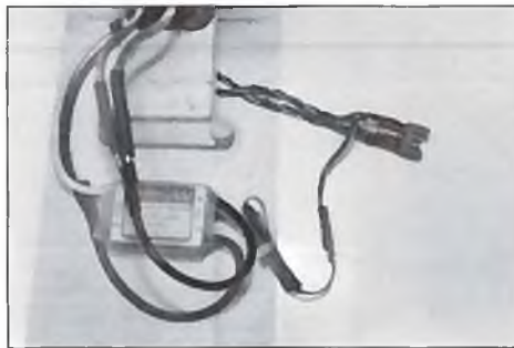
Tragfläche und Akku sind miteinander verbunden. Deshalb sollten nur möglichst wenig Steckverbindungen gelöst werden müssen. Ich konnte sie auf eine reduzieren.
