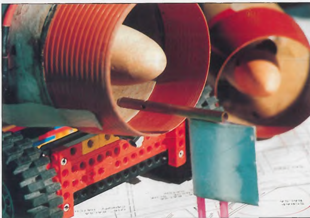
Das Lego-Wügelchen mit aufgeschnalltem Impeller; das U-Manometer mißt den Druck vor dem Impellerrotor
