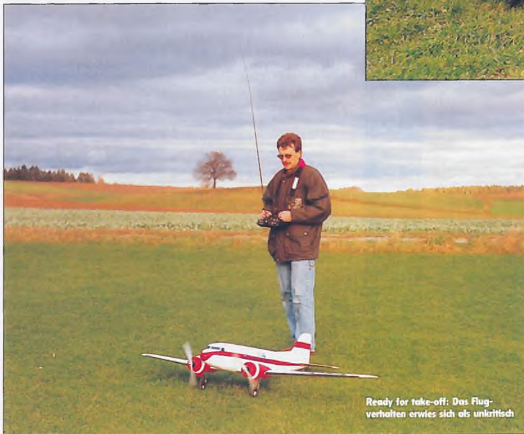
„Schau mit in die Augen Kleines“ - das Fahrwerk wurde beim Testmodell als Fertigteil vom Hersteller zugekauft und läßt sich nicht einziehen.
