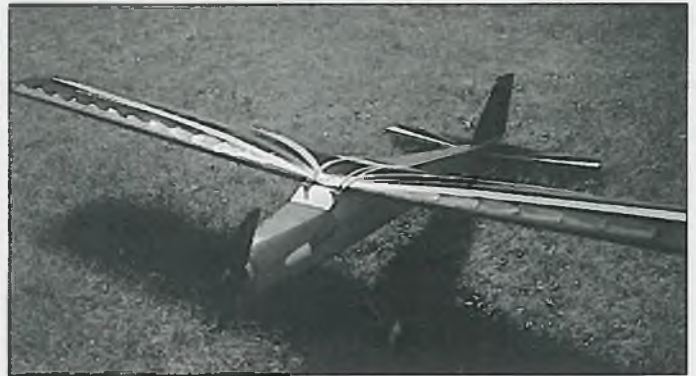
Der Esprit in der Slim-Line-Version: Ein 8x4-Zoll-Propeller mit Graupnerpräzisionsspinner sorgt für Vorschub. In der Standardversion sind Flugzeiten von 7 Minuten möglich.
