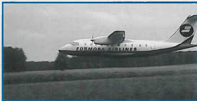
Helmut Wenzel vom TMFC e. V. baute und flog diese gewaltige DO 328 mit der Bemalung der Formosa Airlines. Auch hier dürfen die Daten nicht fehlen. Spannweite: 324 cm, Länge: 325 cm, Gewicht: 12,5 kg (trotz Styropor-Bauweise) Antrieb: 2 x Plektenberg 3500/8 und 2 x 29 Zellen 1700 mAh. Das Modell wird von einem Dolly gestartet
