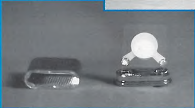
Das Synthesizer-Modul für die FC 28 V3 ist nur unwesentlich größer als das normale, hat aber vollen Zugang zur Sendersoftware
