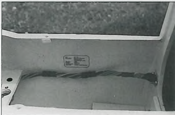
LO 100 „Fly by wire“. Unterhalb des Typenschildes liegt der Kabelbaum für die Ansteuerung der drei Servos im rechten Flügel. Ein neunpoliger „Sub-D“ Stecker sorgt zusammen mit ausreichend dimensionierten Leitungsquerschnitten für eine sichere elektrische Verbindung der Flächenservos mit dem Empfänger.
