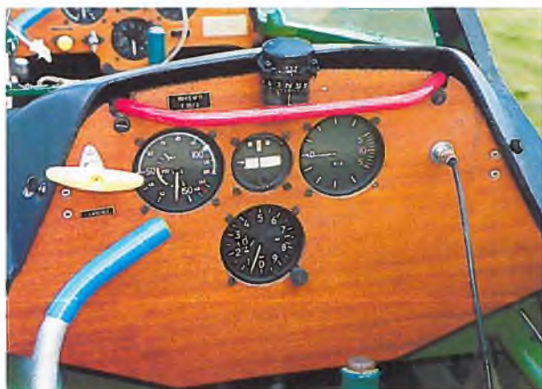
▲ Breguet 904 – hinteres Instrumentenbrett.
