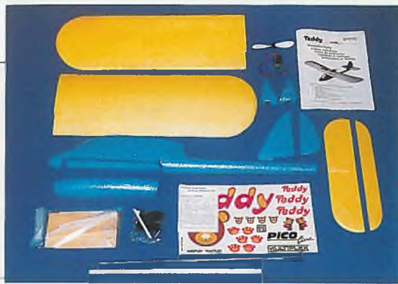
Der Bausatzinhalt. Hier fehlen nur noch Akku, Regler und RC-Anlage.
