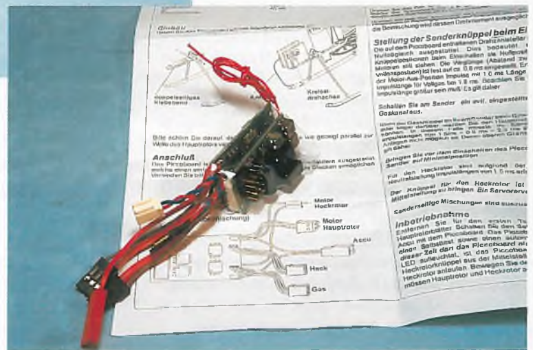
▲ Das neue Piccolo-Board hat die Platinenbestückung jetzt nach außen, sodass die Steckerzuordnung frei gewählt werden kann.
