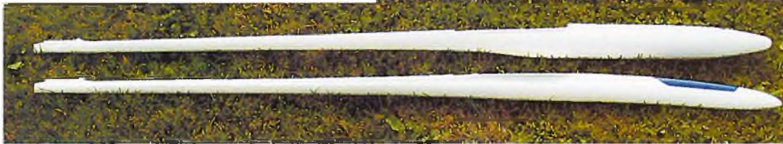
◀ Die beiden Rümpfe in voller Länge; hinter der Tragflächenauflage gibt es keine Unterschiede.
