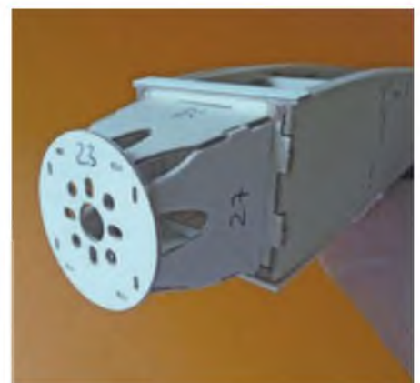
An der Nase sitzt ein solider Motorträger, der kleine Außenläufermotoren aufnimmt.
