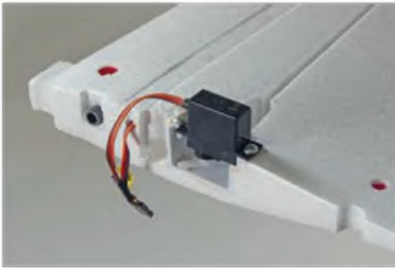
Ein zentrales Servo steuert die beiden Störklappen an. Dazu muss bei der Flächenmontage das Gestänge eingehängt werden.
