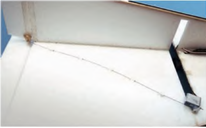
Foto 4: Die Anlenkung des Seitenleitwerks. Die Schubstange aus 0,6-mm-Stahldraht wird in Alu- oder Kunststoffrohren mit 1-mm-Innendurchmesser geführt.
