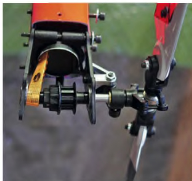
Das Einfädeln des Heckriemens ist eine knifflige Geschichte, aber es geht.
