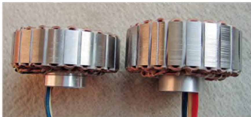
Zwei Statoren, die sich nur in ihrer Höhe bzw. der daraus resultierenden Magnetfeldlänge unterscheiden.
