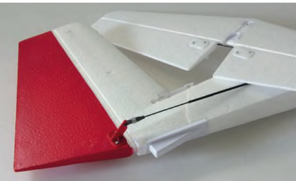
Die Minimalmontage am Heck: Das Höhenleitwerk wird eingeschoben, mit einer Schraube fixiert und der Gabelkopf eingehängt.
