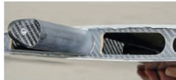
Die Flächensteckung erfolgt über ein CFK-Rohr. Im Flügel sind CFK-Holme eingelassen. Die Flächen werden mit nur einer Schraube befestigt.
