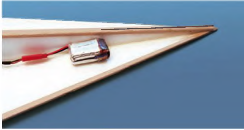
Foto 5: Der 2s 350-mAh-Akkupack wird einfach mit Klettband an der Rumpfspitze befestigt.
