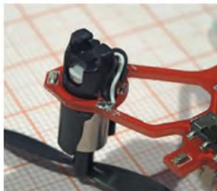
Hier sieht man, dass die beiden Auslegerarme auch der Stromzufuhr zu den Motoren dienen.
