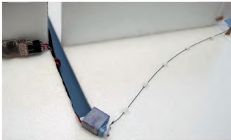
Foto 7: Die Anlenkung des Höhenruders erfolgt nach dem gleichen Prinzip wie die des Seitenruders.
