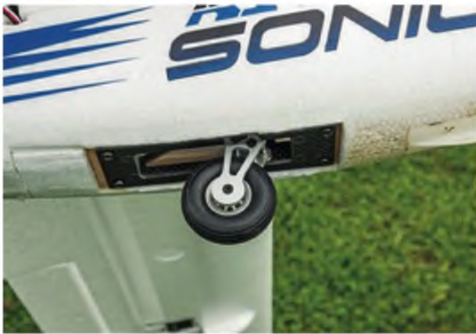
Das kleine elektrische Einziehfahrwerk von Lindinger (#94928, 69,90 €) passt sehr gut in den Rumpfausschnitt. Hinten musste mit etwas Schaum aufgefüllt werden.
