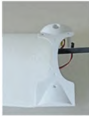
Die Flächenteile werden über ein Carbonrohr und ein Kunststoff-Mittelstück zusammengehalten und mit drei Schrauben auf dem Rumpf montiert.
