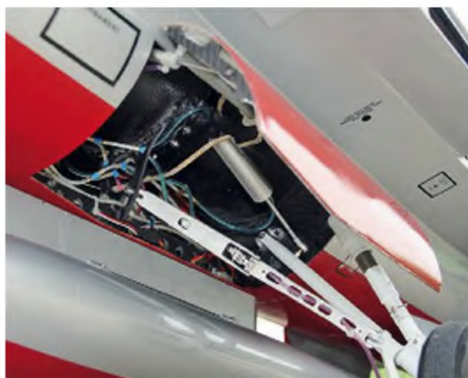
Bei abgenommener Rumpfspitze sind die Akkus zugänglich. Dahinter befindet sich die Ventilsteuerung für die Fahrwerke. Der auf den Akkus liegende Kompressor fliegt natürlich nicht mit!
