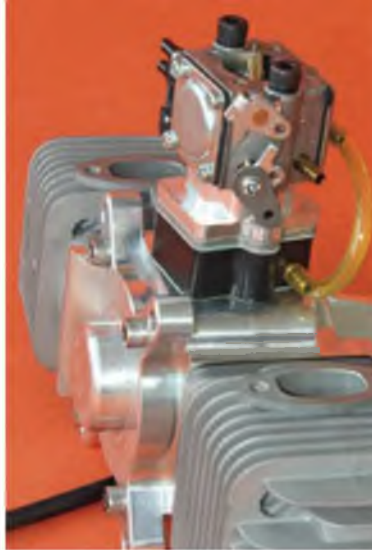
Der Vergaser ist ein Walbro-Original. Die Gehäuserückseite ist mit vier Anschraubblaschen versehen.
