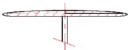
Skizze 2: Die Zeichnung zeigt den Flügelquerschnitt des Dart nach dem Verschleifen.
