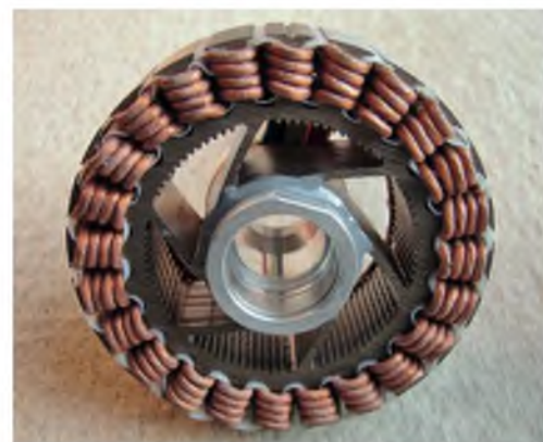
Hier nur der Stator mit den ringförmig angeordneten 24 Elektromagnetspulen des 8-Winders.
