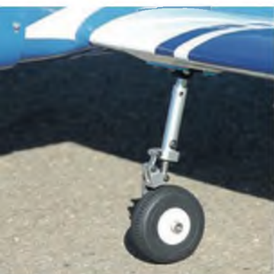
Für die Mechanik ist der Flügel etwas aufgedickt. Die gefederten Alu-Beine sind von sehr guter Qualität.
