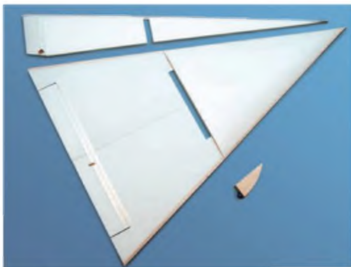
Foto 2: Flügel und Rumpf sind fertig, man sieht die Randverstärkungen und Aussparungen für die Luftschraube. Auch die Aufdoppelung ist zu erkennen.
