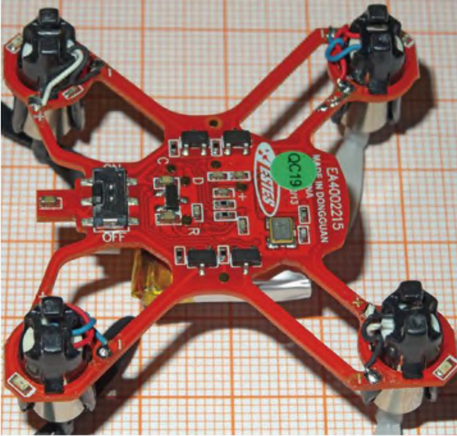
Die Elektronikplatine ist zugleich tragendes Bauteil, an ihr sind auch die Motoren befestigt.
