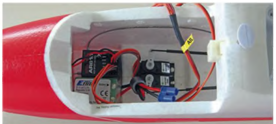
Fertigmodell: Bei der BNF-Variante sind – zusätzlich zu den Seiten- und Höhenruderservos – sogar der Spektrum-AR610-Empfänger und ein Spannungswandler für den 2s-LiPo-Empfängerkaku an Bord.
