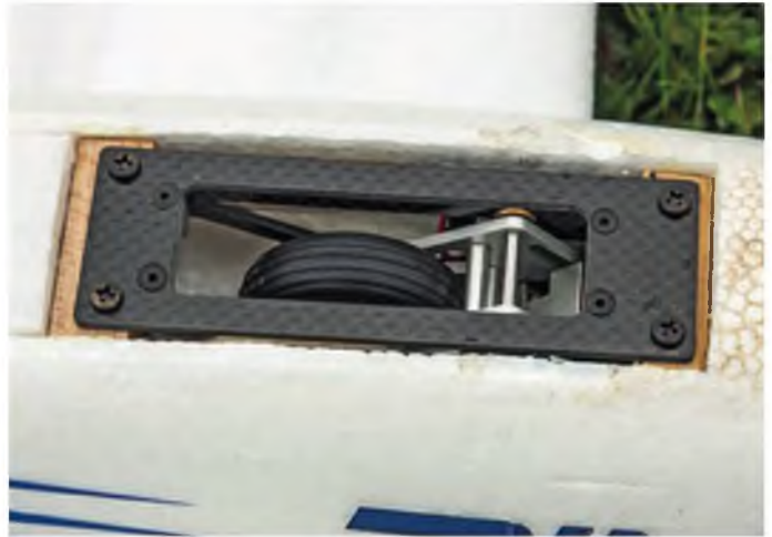
Nur die beiden Holzleisten sind eingeklebt. So kann das Fahrwerk jederzeit abgeschraubt werden.
