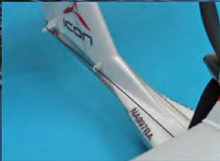
Der schmale Heckausleger der A5 ist der Grund, warum die Anlenkungen außen geführt werden. Funktioniert perfekt.
