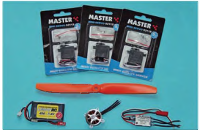
Die Qualität der Combo-Zubehörteile kann sich sehen lassen. Für den Indoor-Einsatz sind allerdings leichtere Servos und ein 2s 350-mAh-Akku empfehlenswert.
