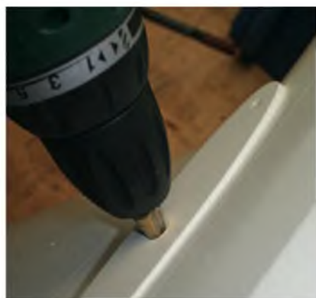
Die Bohrungen zur Aufnahme des Steckrohres für das Höhenleitwerk wurden mit einem Schälbohrer angebracht. Dies ermöglicht wirklich runde Löcher mit exaktem Durchmesser und sauberen Rändern.
