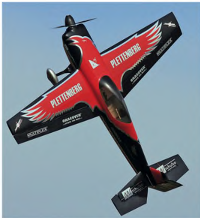
Die Raven war mit der Schubvektorsteuerung ausgerüstet – das ist nur mit einem E-Antrieb möglich.
