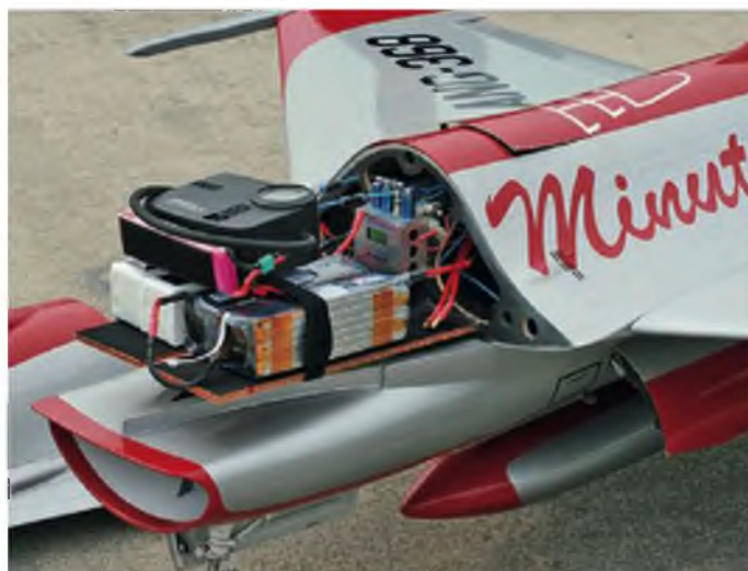
Bei abgenommener Rumpfspitze sind die Akkus zugänglich. Dahinter befindet sich die Ventilsteuerung für die Fahrwerke. Der auf den Akkus liegende Kompressor fliegt natürlich nicht mit!
