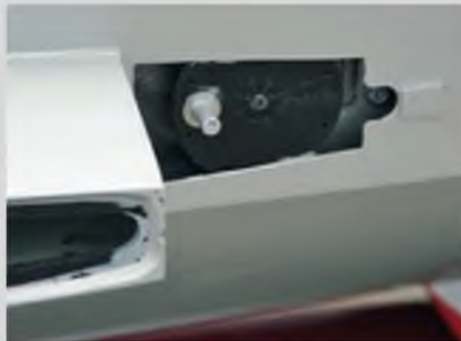
Über einen Stift wird die Klappe bei der Flächenmontage mit dem Servo verbunden.
