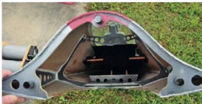
Der Blick in die abnehmbare Rumpfspitze zeigt die Sandwichbauweise. Die Spanten bestehen ebenfalls aus CFK-Sandwichmaterial.
