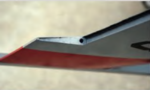
Am Randbogen greift die Klappe in eine Buchse ein.
