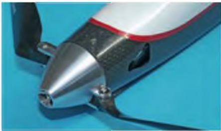
Ein 38-mm-Spinner, hier von Staufenbiel, ermöglicht eine perfekte Rumpfspitze.
