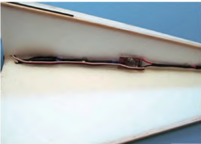
Foto 6: Der 10-A-Regler ist seitlich am Rumpf befestigt. Aus optischen Gründen kann man diesen Bereich mit einem Stück Depron verkleiden.
