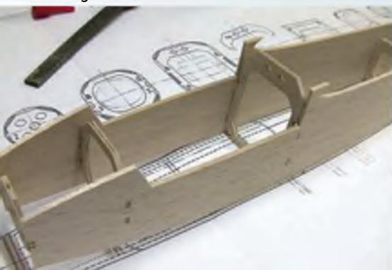
Aufbau des Kastenrumpfes, hier mit Hilfe gefräster Bauteile
