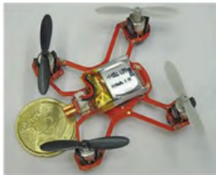
Der Flugakku ist nur angesteckt und nicht festgelötet. So kann er bei Bedarf einfach und schnell gewechselt werden.
