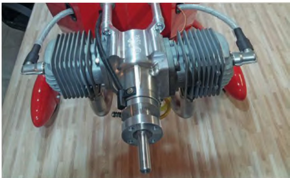
Die Breite des DLA 64 beträgt 215 mm – mit Kerzenstecker 270 mm.
