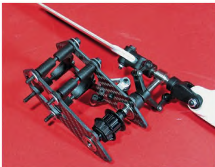
Das Heckgetriebe wird lose verschraubt und dann über das Heckrohr und anschließend in den Heckvierkant geschoben.
