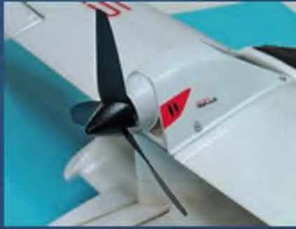
In Kombination mit dem Dreiblattpropeller sorgt der Brushless-Motor für viel Schub.
