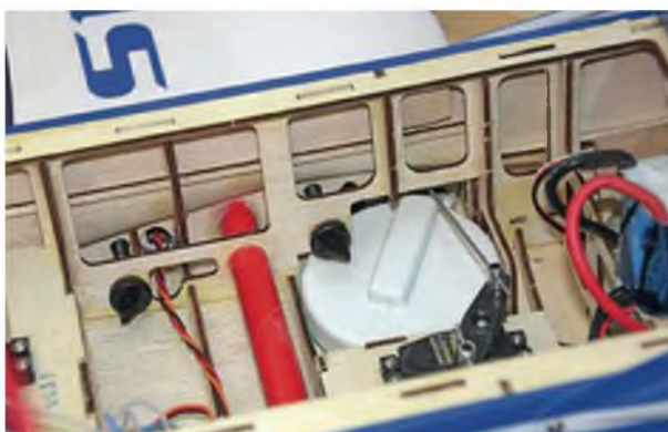
Die Flächen werden mit je zwei gut erreichbaren Kunststoff-Schrauben gesichert.
