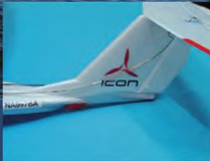
Die Höhenruderanlenkung ist im Bogen am Seitenleitwerk entlang geführt. Auch das funktioniert einwandfrei.
