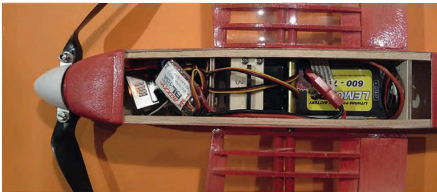
So sieht der komplett ausgerüstete Rumpf der E-Gurke aus. Gesteuert wird das Modell wie gehabt über eine Flächenverwindung.
