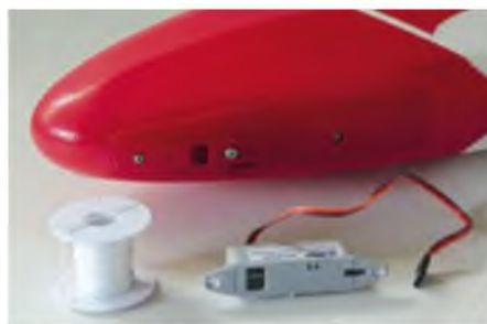
Exakt vorbereitet für den F-Schlepp: Die optionale servolose Schleppkupplung (Best.Nr. EFLA405) ist in kürzester Zeit eingebaut.
