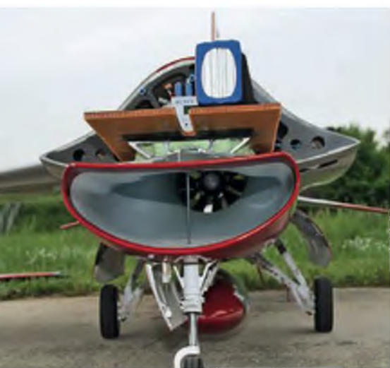
Die Luftführung ist sauber bis zum Impeller gestaltet.
