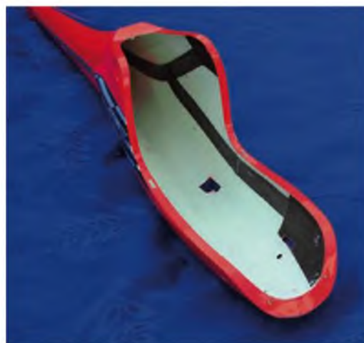
Der Rumpf wird in Deutschland gefertigt und ist an beanspruchten Stellen mit CFK-Band verstärkt.
