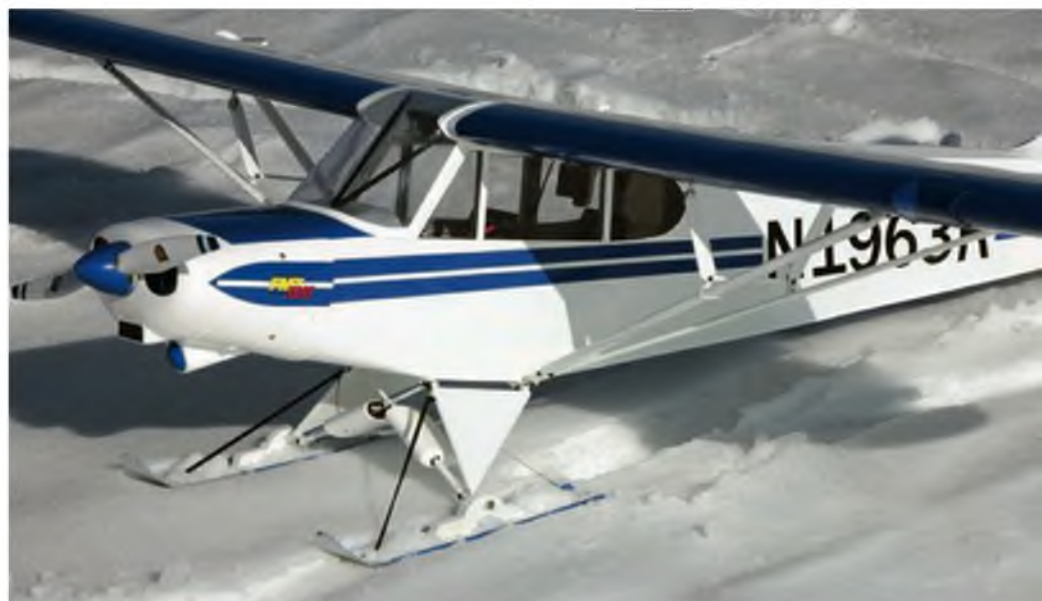
Die Verspannung hält die Spitze der Skier immer unter Zug, so dass sie nicht in den Schnee eintauchen.
