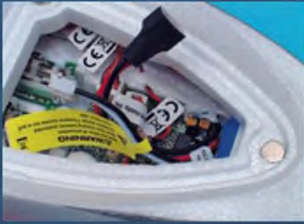
Unter der Kabinenhaube steckt geballte Technik. Vor dem Elektronikbaustein findet der Akku seinen Platz in der Rumpfschnauze.
