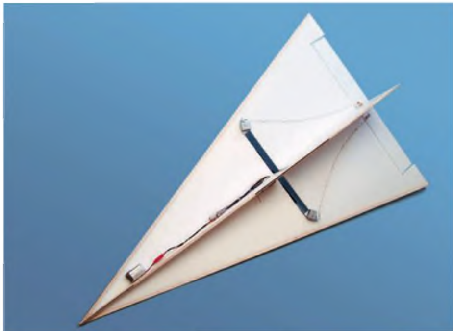
Foto 8: Das fertige Modell von unten. Es hat nur ca. 7 \text{ g/dm}^2 Flächenbelastung und ist mit dem Dymond-Außenläufer kräftig motorisiert.
