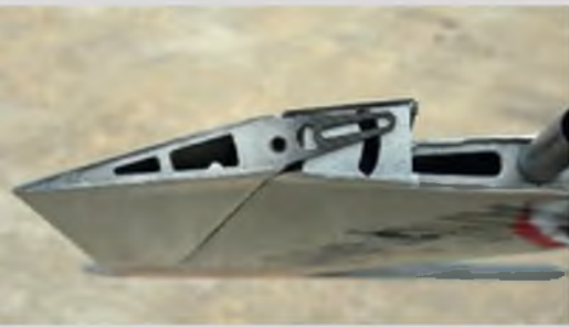
Die Flaps sind mit einem Handgriff demontierbar
