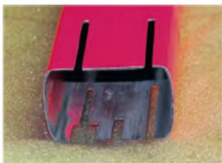
Der Heckvierkant sollte mit Schmirgel etwas geglättet werden, das vereinfacht das Montieren des Heckgetriebes.
