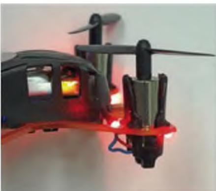
Die Mikroelektronik macht's möglich: insgesamt acht helle SMD-LEDs haben auch noch Platz gefunden.
