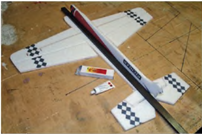
Beim Aufbau des Modells ist auf Verzugsfreiheit zu achten. Durch das Anlegen einer Metallschiene wird der Rumpf hundertprozentig gerade.
