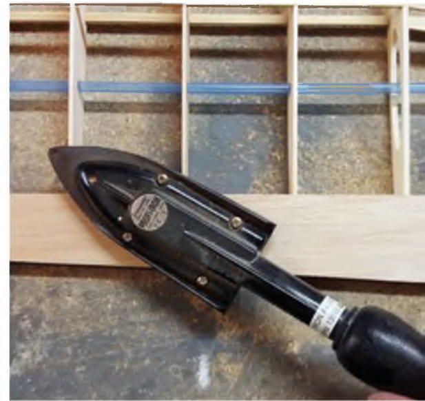
Zum Aufbügeln der Beplankung wird Weißleim auf die Holme und Rippen aufgetragen, auf die Beplankung übertragen und verteilt. Nach dem Ablüften des Leims kann gebügelt werden.
