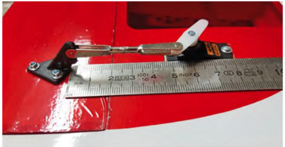
Die Klappenanlenkung ist gerademal so lang, dass zwei Gabelköpfe mit einer Gewindestange verbunden werden.
