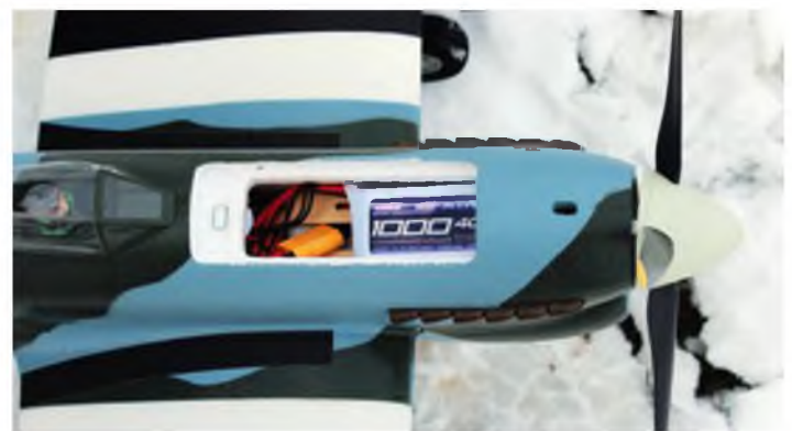
... und so ist mit dem 3s-LiPo der Schwerpunkt der Tempest gut eingestellt.
