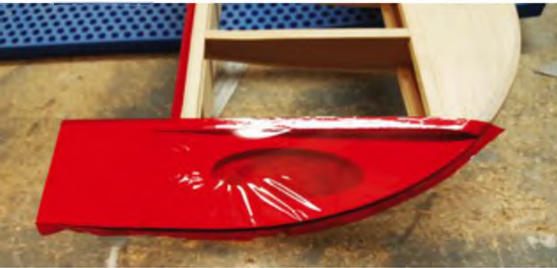
Zuerst werden die Randbögen gebügelt – ich habe Oralight verwendet.
