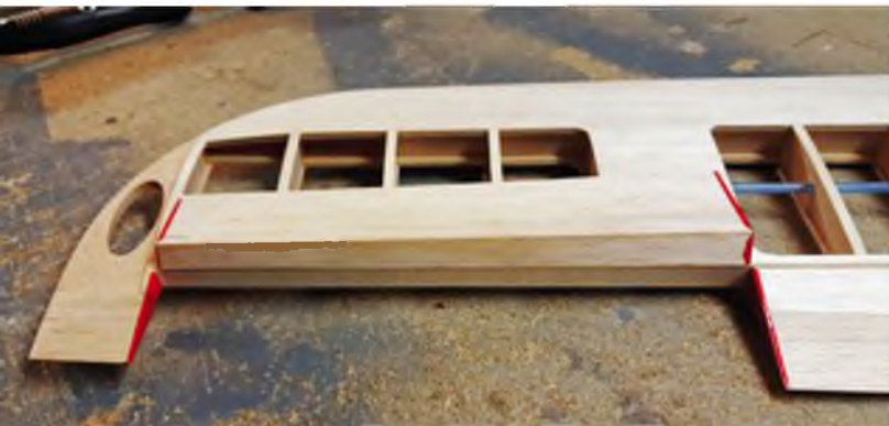
Ruder oder Klappe werden mit Kreppband positioniert und umgelegt,...
