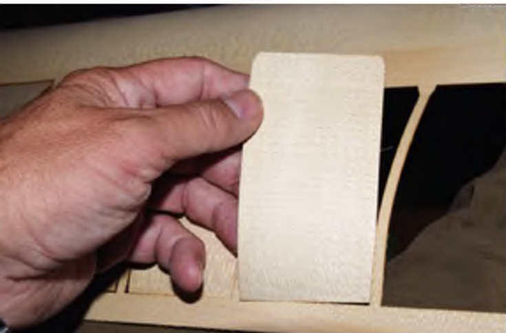
Die Rückseite der Beplankung ist mit einem Gewebe versehen. Es gibt damit kein Brechen des Furniers beim Beplanken mehr!
