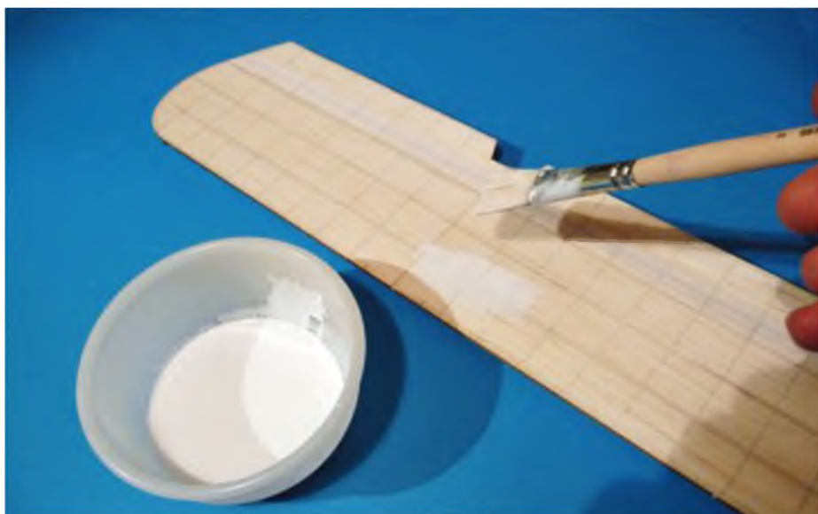
Abschließend bekamen die Flächen und Leitwerke einen Anstrich mit weißer Farbe, um die originale Stoffbespannung zu imitieren.
