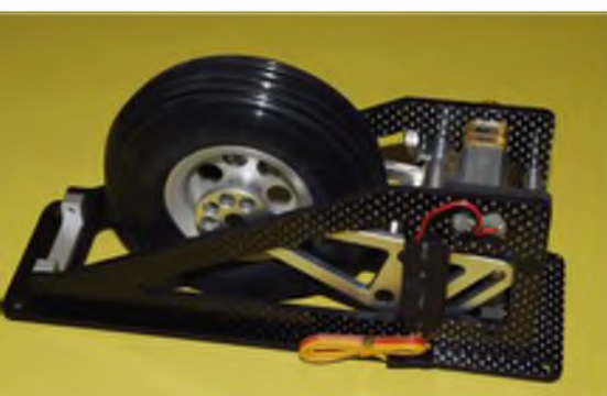
Das optionale elektrische Einziehfahrwerk lässt sich problemlos und einfach einbauen.
