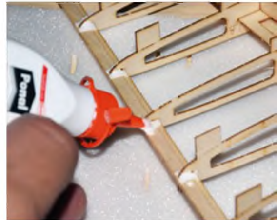
Die Flächenrippen: Klebstoff anbringen und überschüssigen Leim abstreifen. Weißleim ist unbedenklich – trotzdem immer wieder die Hände reinigen.
