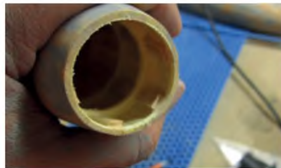
Die fertig beplankten Tiptanks werden mit dem Kreisschneidaufsatz einer Dremel am Kopfspant wieder geöffnet, um dort je einen Landescheinwerfer einsetzen zu können.
