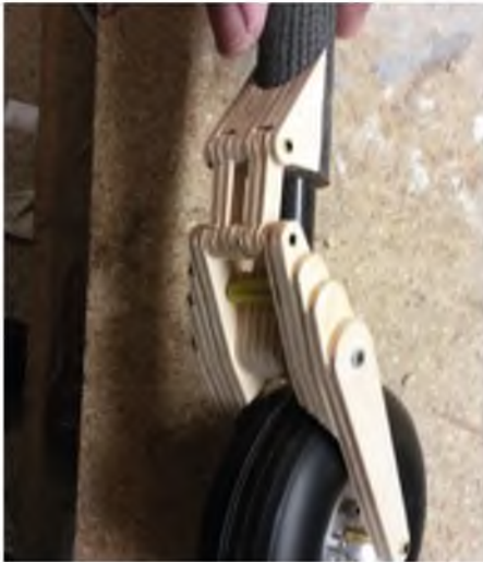
Die Fahrwerke wurden in GFK/CFK aufgebaut. Mit Holz-Dummys – hier das Bugfahrwerk – wurden die richtigen Winkel- und Hebelverhältnisse überprüft.
