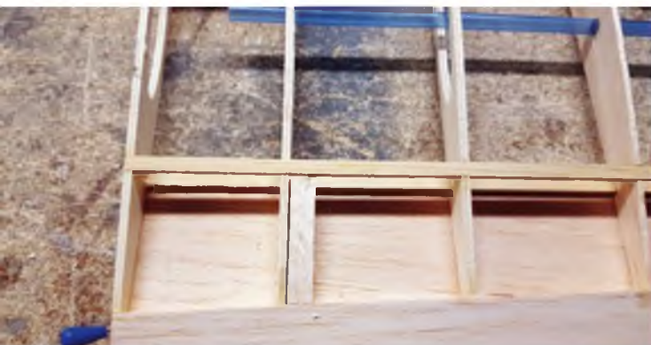
Füllklötze sorgen für geschlossene Schnittkanten an den Ruder-Trennstellen.
