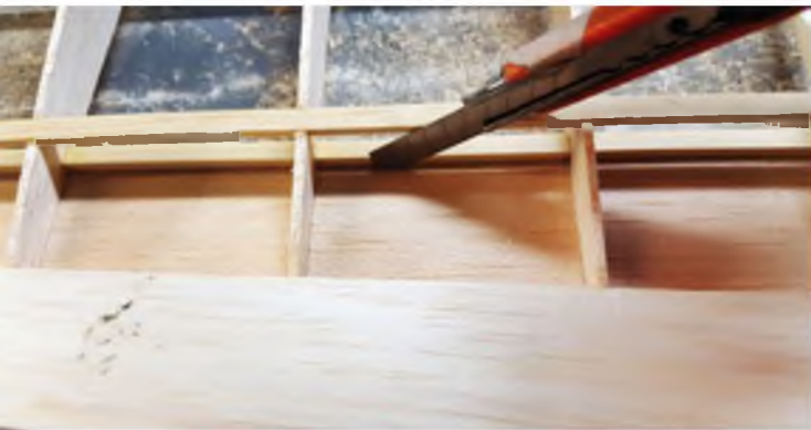
Die untere Beplankung wird an der Trennstelle zwischen Fläche und Ruder schon vor dem Aufkleben der oberen Beplankung eingeschnitten.
