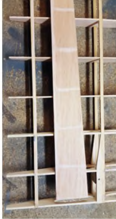
Zum Aufbügeln der Beplankung wird Weißleim auf die Holme und Rippen aufgetragen, auf die Beplankung übertragen und verteilt. Nach dem Ablüften des Leims kann gebügelt werden.
