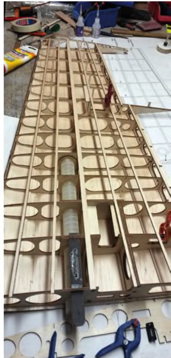
Der Aufbau der Tragfläche erfolgt klassisch – auch hier sind Vorbereitung und Passgenauigkeit kaum zu überbieten.
