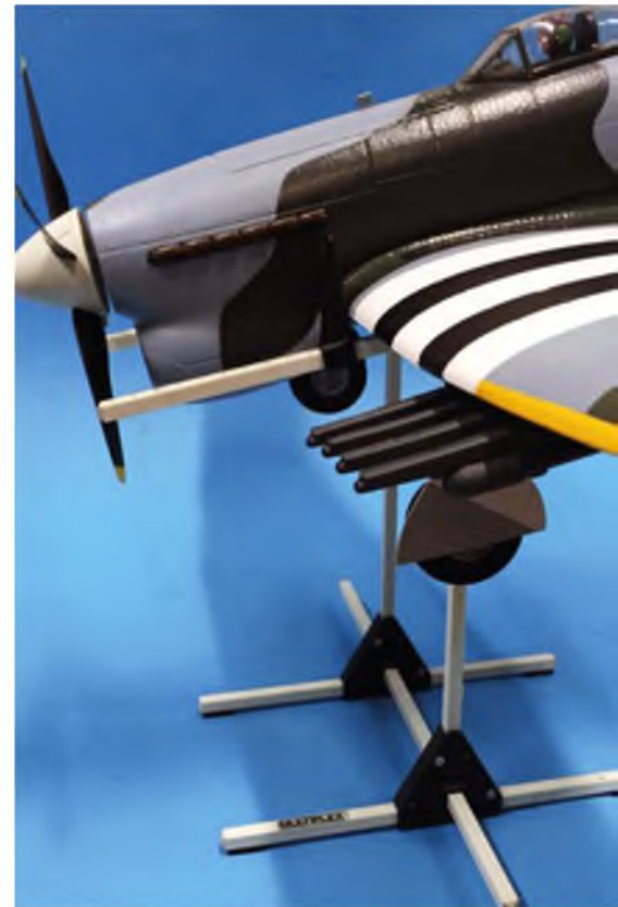
Mit einer Schwerpunktwaage ist das Auswiegen einfacher. Bei der Tempest wählte ich zunächst die mittlere Position, wechselte dann aber zur vorderen.
