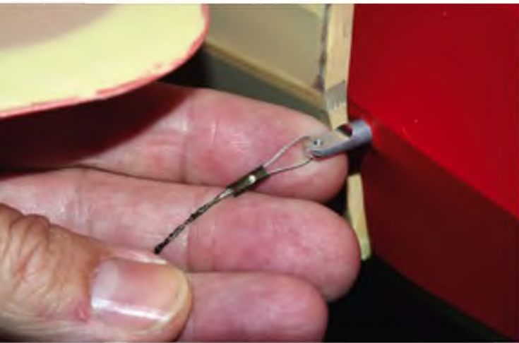
So wird der Bowdenzug für die Seitenrudieranlenkung verklebmt.
