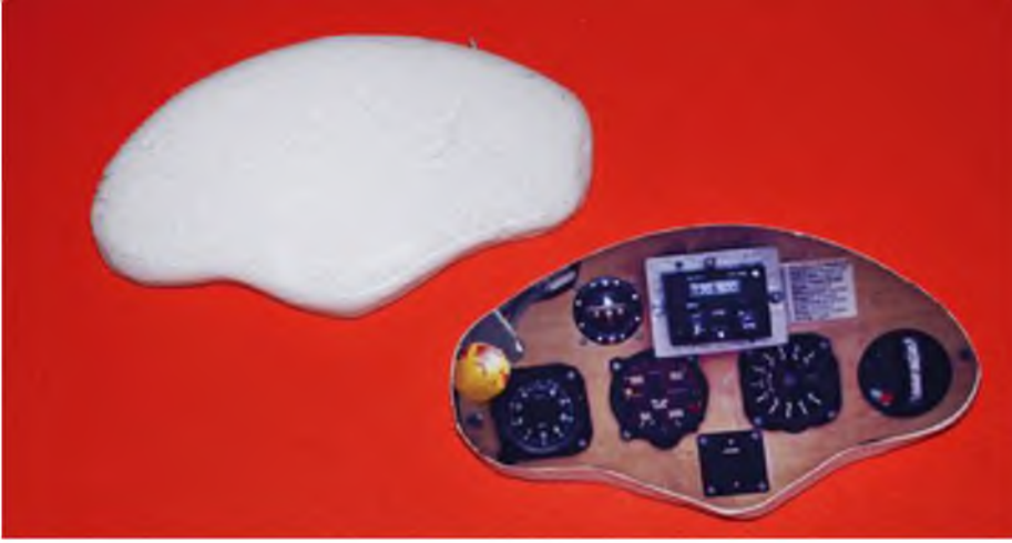
Meine Armaturen entstammen dem Drucker. Zur Verstärkung habe ich etwas Depron dahinter geklebt.
