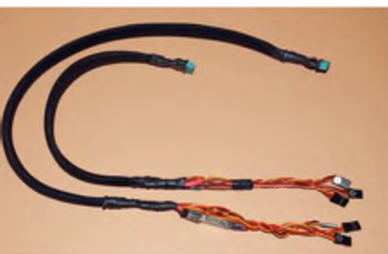
So sehen rumpfseitig die fertig konfektionierten Kabelbäume aus. Die kleinen Zwischenstücke sind Servostromlimiter für die Störklappen.
