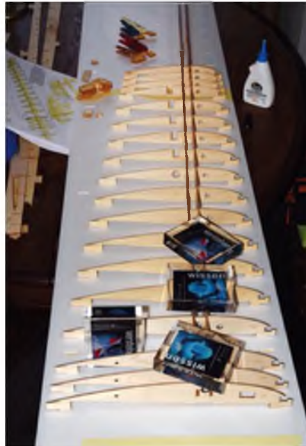
Wichtig für einen geraden, verzugsfreien Flächenbau: Beim Austrocknen immer alles fixieren.
