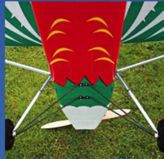
Das Hauptfahrwerk besteht aus jeweils zwei Stahldrähten und einer gefederten Stütze, die zur Rumpfsseitenwand führt.
