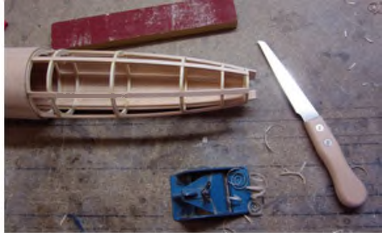
Das Spantgerüst der neuen Tiptanks. Die Holzbauweise spart einiges an Gewicht gegenüber den GFK-Teilen.
