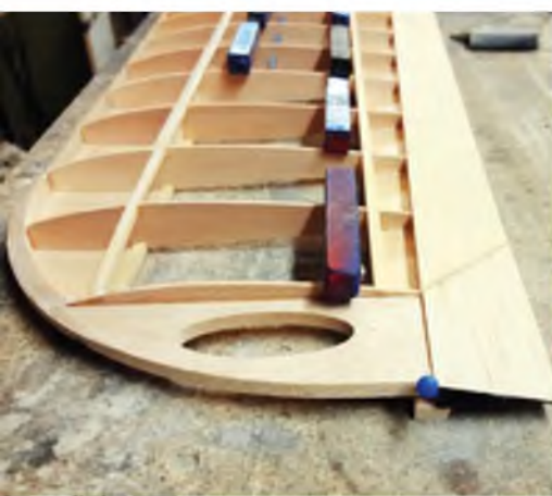
Die Holmverkastung erfolgt mit stehender Maserung – eingesetzt und verklebt wird sie nach dem Schließen der unteren Beplankung.
