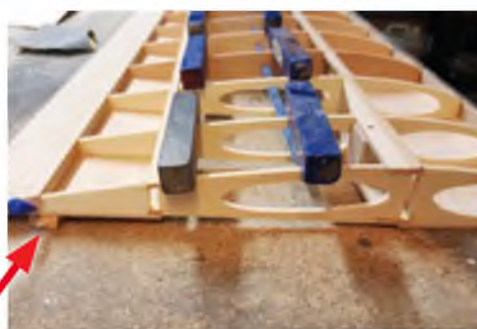
Um die richtige Flächenverwindung (Schränkung) zu erreichen, wird beim Aufkleben der oberen Beplankung eine 6-mm-Leiste unter die Endleiste gelegt.
