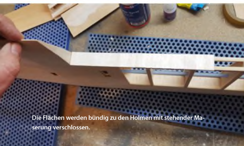
Ist die obere Beplankung aufgebracht, können die Ruder getrennt werden – den Schnitten in der unteren Beplankung folgend, direkt hinter den Hilfsholmen.
