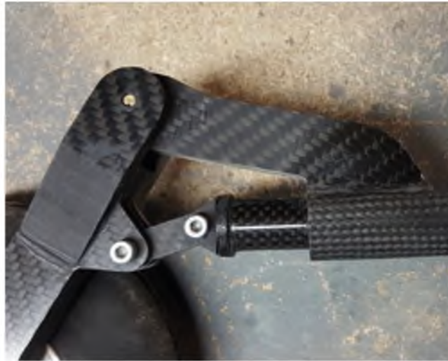
Das Führungsrohr wurde aus GFK-CFK-Gewebe gewickelt, das Tauchrohr ist ein käufliches CFK-Rohr und die Schwingenteile sind mehrschichtig aus GFK- und CFK-Platten aufgebaut.
