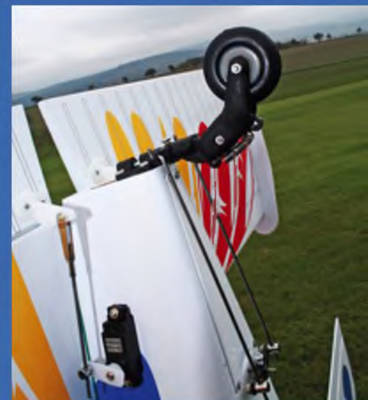
Das Heckfahrwerk ist lenkbar und mit einer Federung ausgestattet. Die Feder erwies sich als zu schwach, sodass mit einer zusätzlichen Feder nachgebessert wurde. Das Höhenruder ist beidseitig durch jeweils ein Servo angesteuert.
