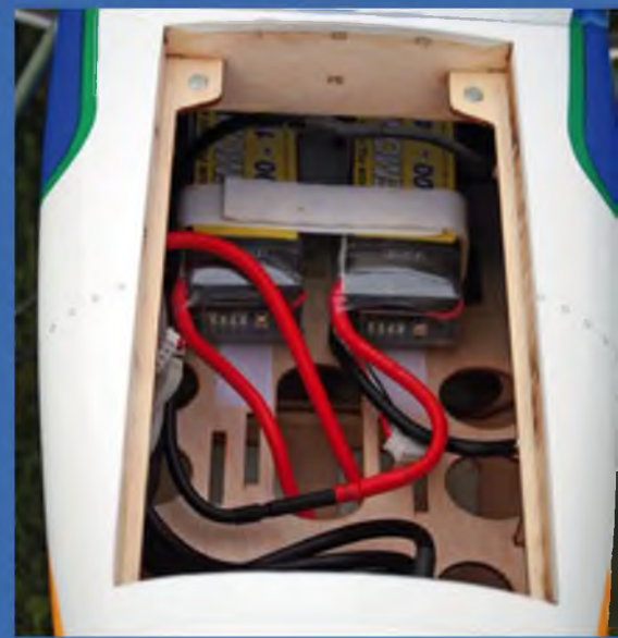
Antriebsakku und Regler sind dank des vorderen Deckels leicht zugänglich. Es ist ausreichend Platz auch für mehr als acht Zellen vorhanden.
