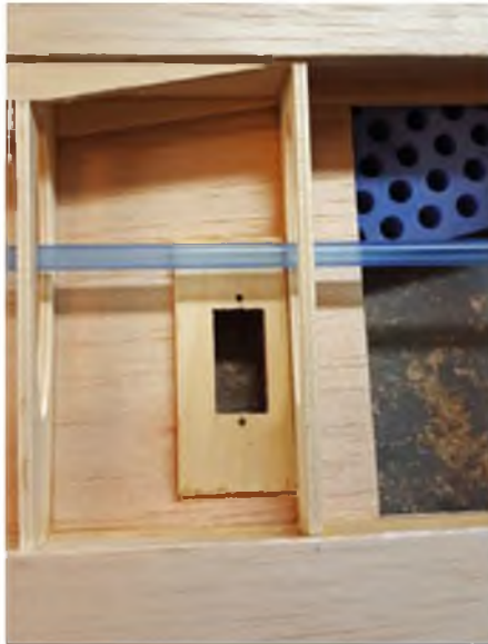
Die Servohalterungen sitzen direkt innen auf der Beplankung.
