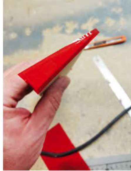
Dann werden die Stirnflächen der Ruder und Klappen mit Folie bezogen.
