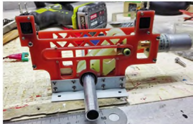
Die neuen Einziehfahrwerke für unsere Zlins verlangen präzise Lagerpassungen der Frästeile.
