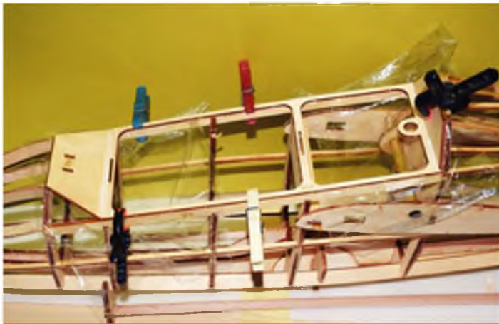
Das Anpassen des Haubenrahmens an den Rumpf. Die Haushaltsfolie dient als Verklebschutz.
