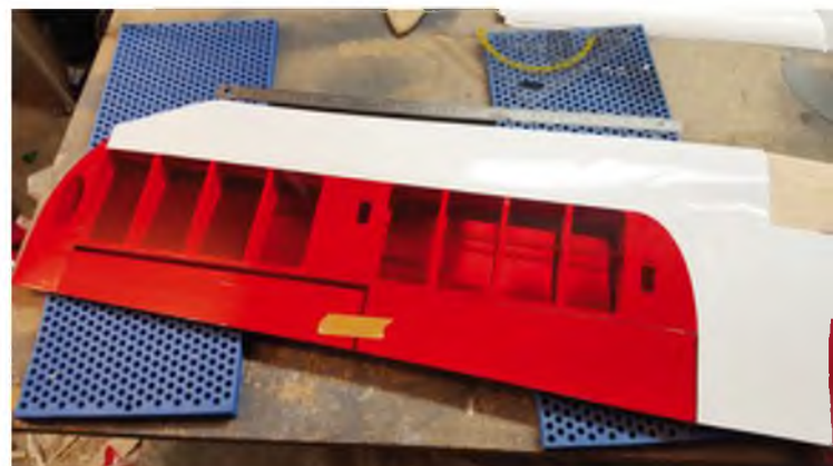
Abschließend noch den weiß abgesetzten Nasenbereich mit einem geringen Folienüberstand bebügeln und die Fläche ist fertig.
