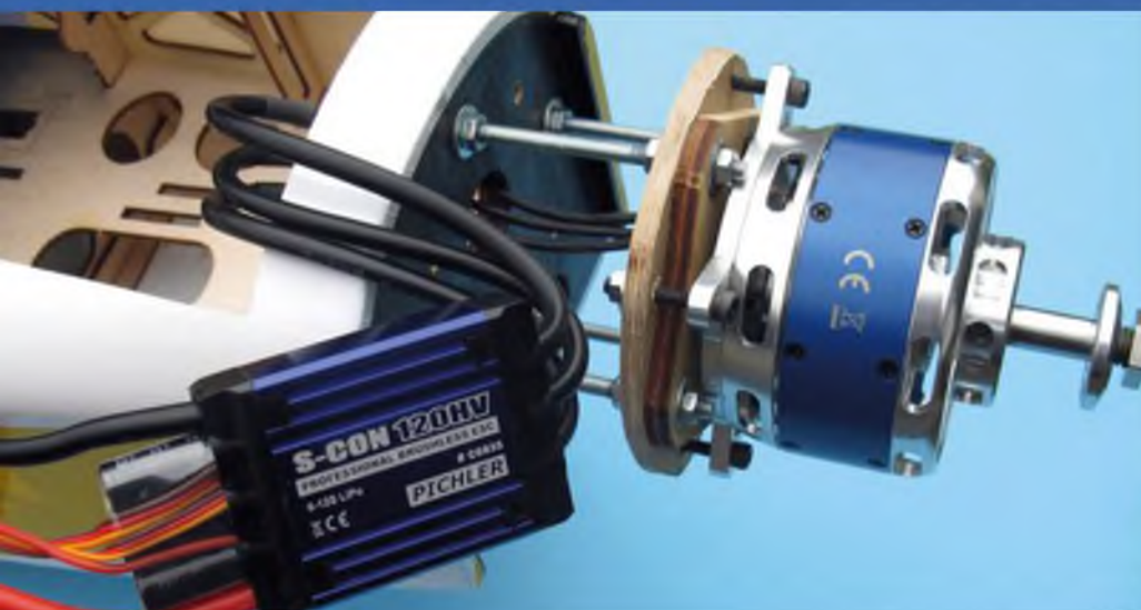
Die Pichler-Combo aus dem Boost 120 und dem Regler S-CON 120 HV stellt zum Schleppen genügend Leistung zur Verfügung.
