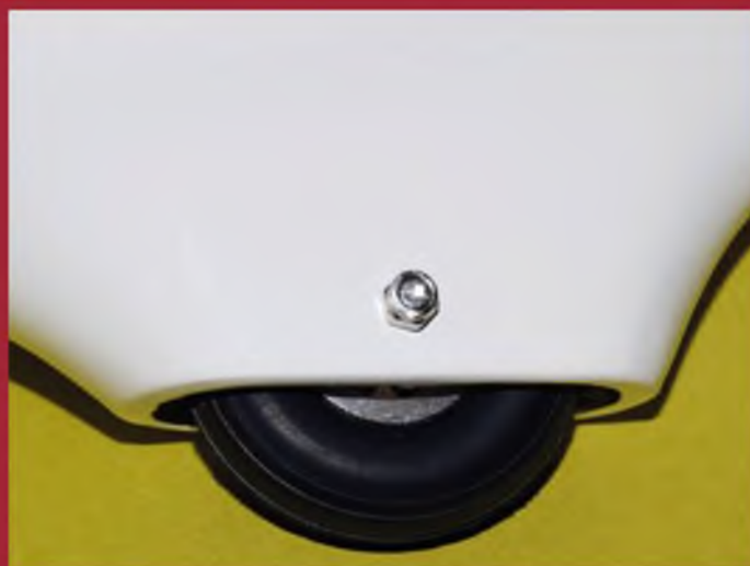
Die Lagerbuchse des Heckrades muss noch etwas abgeschliffen werden. Dann kann man's einbauen – und es sitzt sauber.
