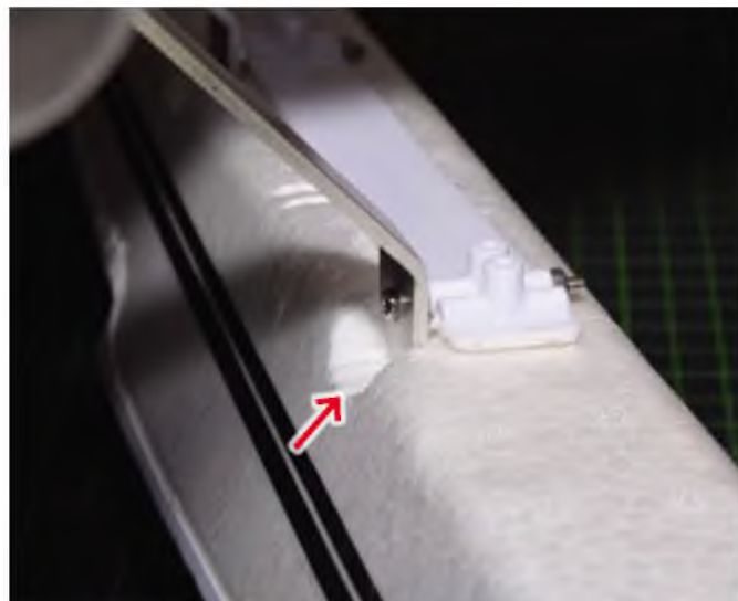
Damit der Schwimmer auf die Schrauben der Fahrwerksbeine gesteckt werden kann, muss er mit einem halbkreisförmigen Ausschnitt angepasst werden.
