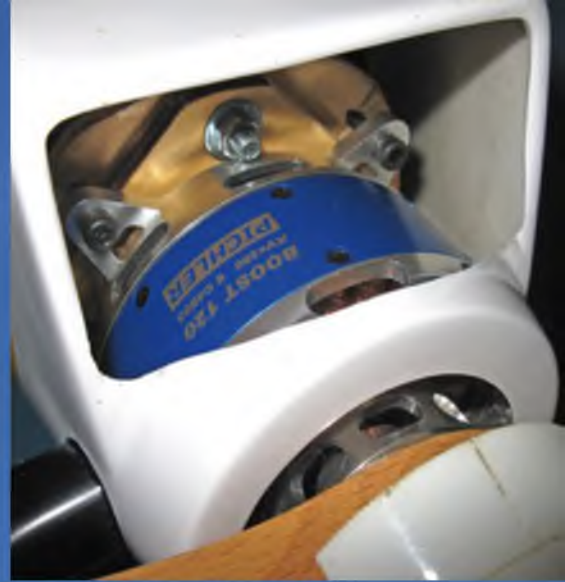
Für den großen Boost 120 muss an der Motorhaube etwas Material abgenommen werden.
