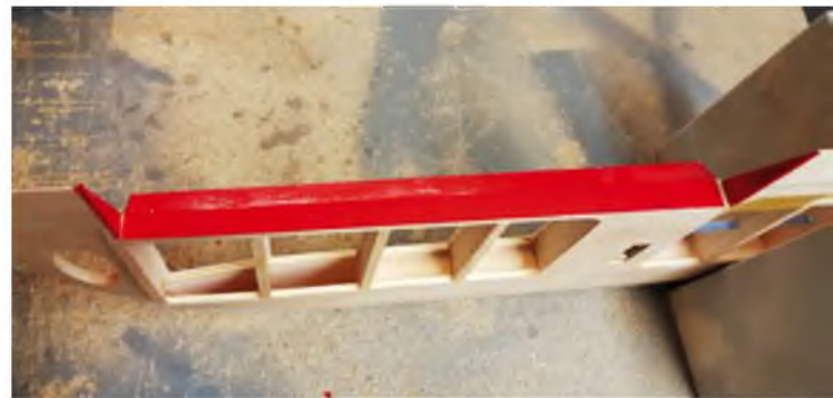
... um danach die Folie als Scharnierlinie über Fläche und Ruder oder Klappe zu bügeln.
