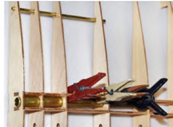
Die Rohre für die Flächenverbinder werden eingebaut. Das hat ohne jegliches Vorjustieren gepasst!
