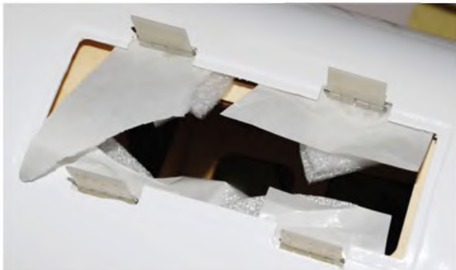
Die Scharniere für die Einziehfahrwerks-Klappen werden auf diese Weise in Position gehalten, bis der Klebstoff aushärtet.
