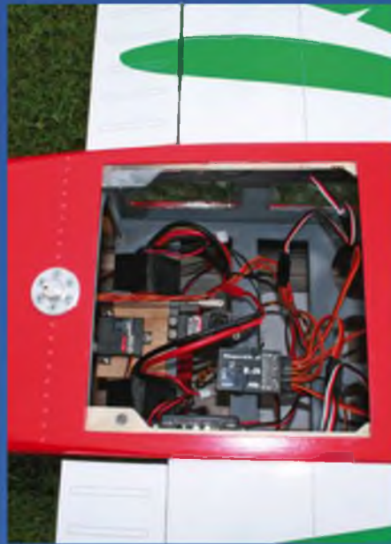
Für den Einsatz als Schleppmaschine können die notwendige Kupplung (z.B. von Simprop) und das Servo schnell nachgerüstet werden.
