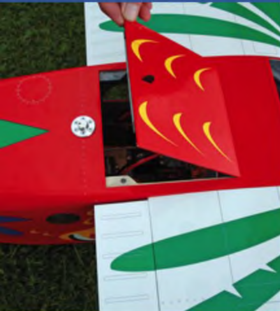
Ein bequemer Zugang von oben ist durch die Klappe auf der Rumpfoberseite gewährleistet. Die Verriegelung erfolgt durch Magnete.
