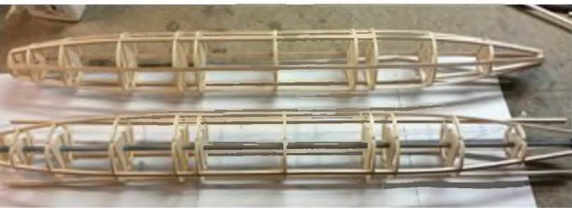
Das Spantgerüst der neuen Tiptanks. Die Holzbauweise spart einiges an Gewicht gegenüber den GFK-Teilen.
