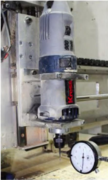
Der Rundlauffehler der Kress-Spindel beträgt unter Last 0,1 mm.
