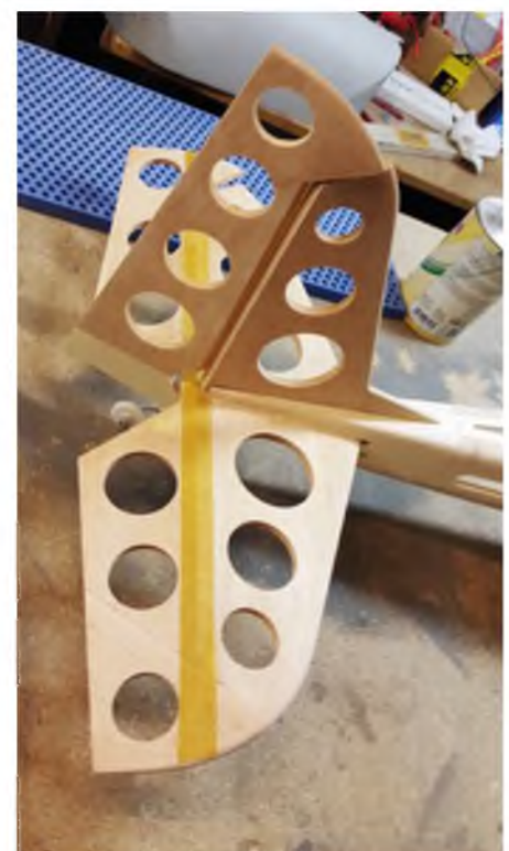
Probieren des Leitwerks – die Ruder sind mit Krepband provisorisch befestigt.
