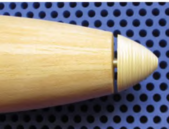
Die Nase wurde separat gefertigt und als Tiefziehstempel für die Klarsichtabdeckung verwendet.
