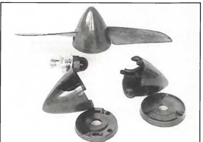
Zwei Spinner, die sich gut eignen: Du-Bro und Goldberg. Der Mitnehmer zentriert automatisch.
