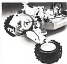
geschmiertes, gekapseltes Getriebe und Vari Lok-Differential
