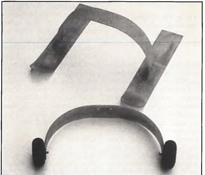
Als GfK-Teile für Ganzjahresflugbetrieb, das Fahrwerk mit Rädern und Kufen
