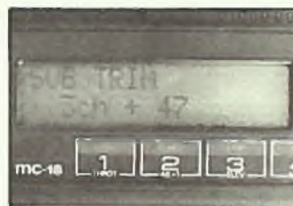
Links: Servoweg-Mittenverstellung, hier für Servo 3 auf + 47 % programmiert. Rechts: Querruder differenzierung ausgeschaltet.
