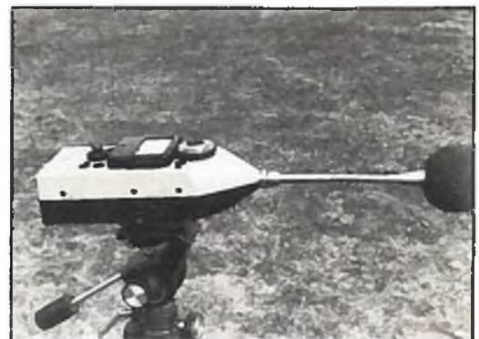
6c) Eines der vier verwendeten Schallpegelmeßgeräte. Hier ein häufig verwendetes Fabrikat Brüel & Kjaer, außerdem steht ein in dem VW-Bus fest installiertes Rohde-&-Schwarz-Gerät sowie ein neues Brüel-&-Kjaer-Gerät mit Schreiber sowie ein Einfachmeßgerät des unterstützenden Modellflugvereins zur Verfügung.
