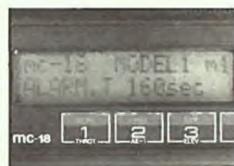
Links: Alarmtimer auf 160 s gesetzt, Alarm durch akustisches Signal. Rechts: Sender-Betriebsstundenzähler, hier wird eine bisherige Gesamtbetriebszeit von 54 min und 18 s angezeigt.
