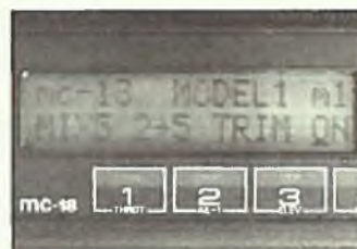
Links: Mischer 5 wurde auf Kanal 2 nach 5 programmiert, Trimm-Mixer eingeschaltet. Rechts: Aus neun fertigen Betriebsprogrammen ausgewähltes Menü für Motor- und Segelflugmodelle.
