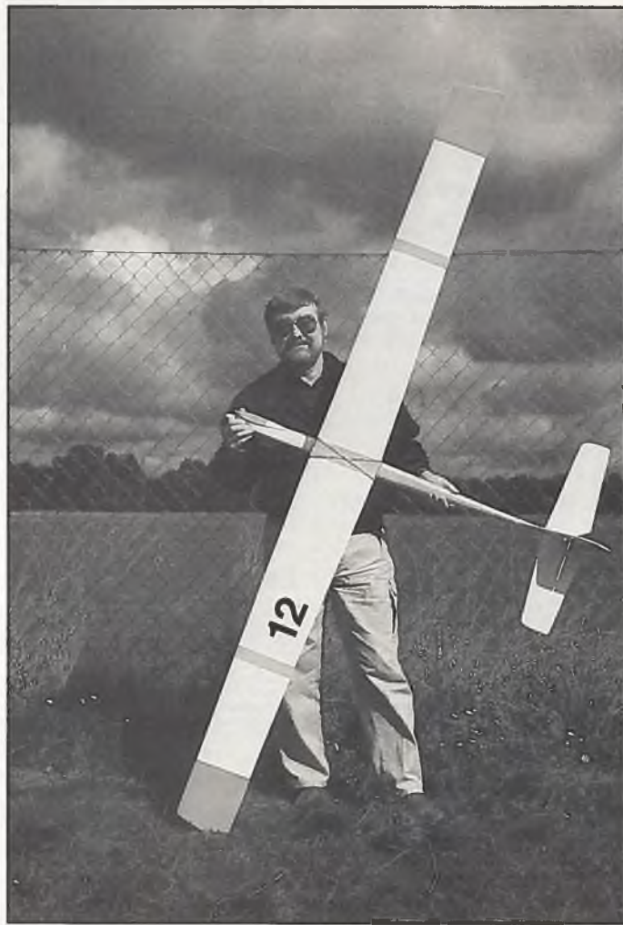
Dem Hersteller hat es nicht gefallen, der Autor findet es besser: Der Flügel anstatt mit Schrauben mit Gummiringen befestigt. Schön ist es in der Tat nicht, doch ein Ringelpietz wird so eher schadlos überstanden
