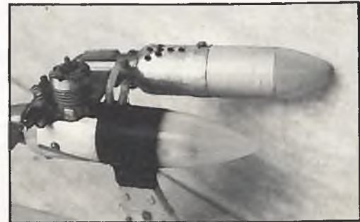
Der Ölabscheider an einem Segler-Hilfsmotor; entsprechend größer ausgelegt, kann diese Vorrichtung auch an hubraumstärkere Motoren montiert werden
