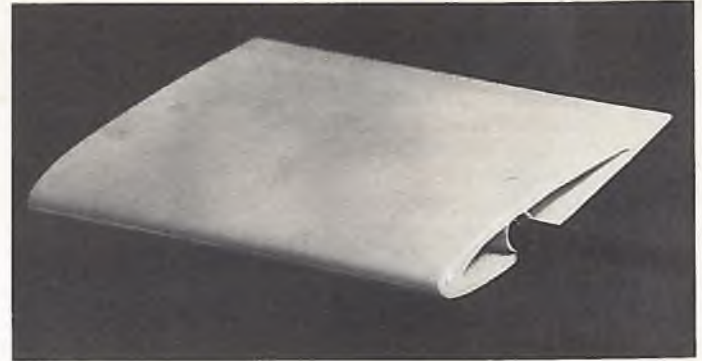
Die neuen Hillerpaddel, 18 g leicht, sauber gearbeitet und innen hohl
