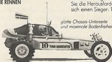
Die rennerprobte hintere Federung enthält gehärtete Halbachsen und Gelenkwellen mit zweiteiligen Felgen. Schnellwechsel-Befestigungen für schnelle Boxenstops und zur Abstimmung.
