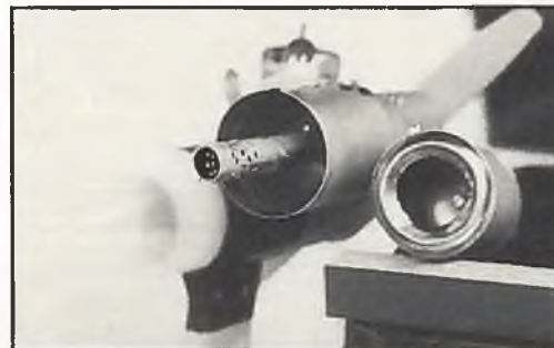
Geöffnet: Gut zu sehen ist der Ölfangring, der es verhindert, daß das gesammelte Öl in den Schalldämpfer überschwappt, wo es vom Abgasstrom nach außen befördert würde
