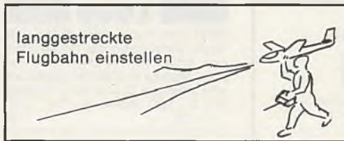
Bild 3: Handstarts dienen hauptsächlich der Ruderausschlags-Kontrolle und dem Eintrimmen des Leitwerkswinkels (EWD) auf eine langgestreckte Flugbahn. Sind aus dem Bild der Flugbahn Tendenzen entsprechend Bild 4 ersichtlich, kann auch mit Verschiebungen des Schwerpunktes begonnen werden.
