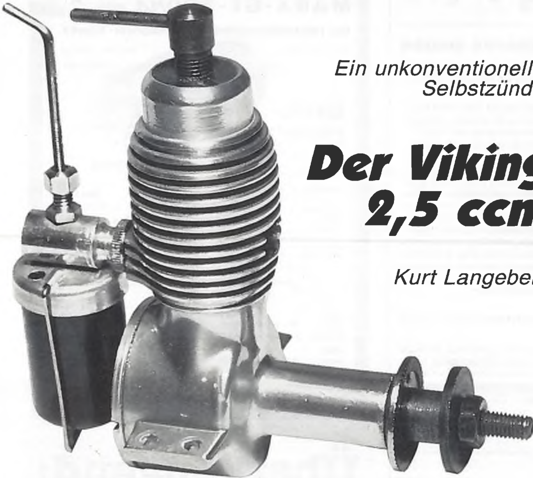
Ansicht des Viking 2,5 ccm Selbstzünders: beachtenswert der vorn liegende Auspuff
