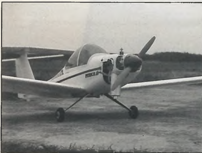
Die Umwelt geht vor Schönheit: Der nach unten ragende zusätzlich montierte Schalldämpfer aus einer Sylvesterrakete wirkt an dem kleinen Modell nicht gerade elegant. Damit schafft aber die Patricia unter 70 dB/A in 7 m Entfernung, bei Vollgas. Bei diesen Werten akzeptiert man jeden „Topf“ am Modell!
