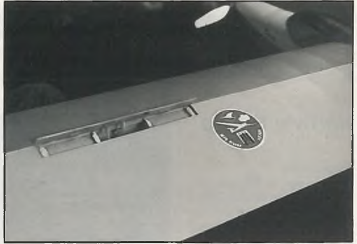
Die Bremsklappen: Vom Konstrukteur nicht vorgesehen, aber nützlich
