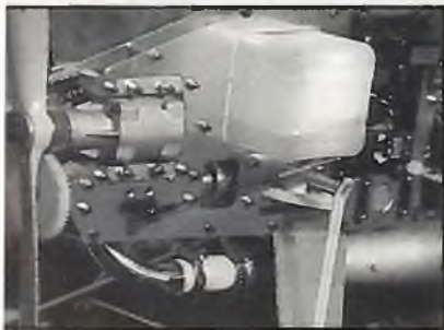
Der technische Aufbau ähnelt stark dem Hubschrauber. In der Mitte ist die Trennkupplung für den Rotorantrieb zu sehen.
