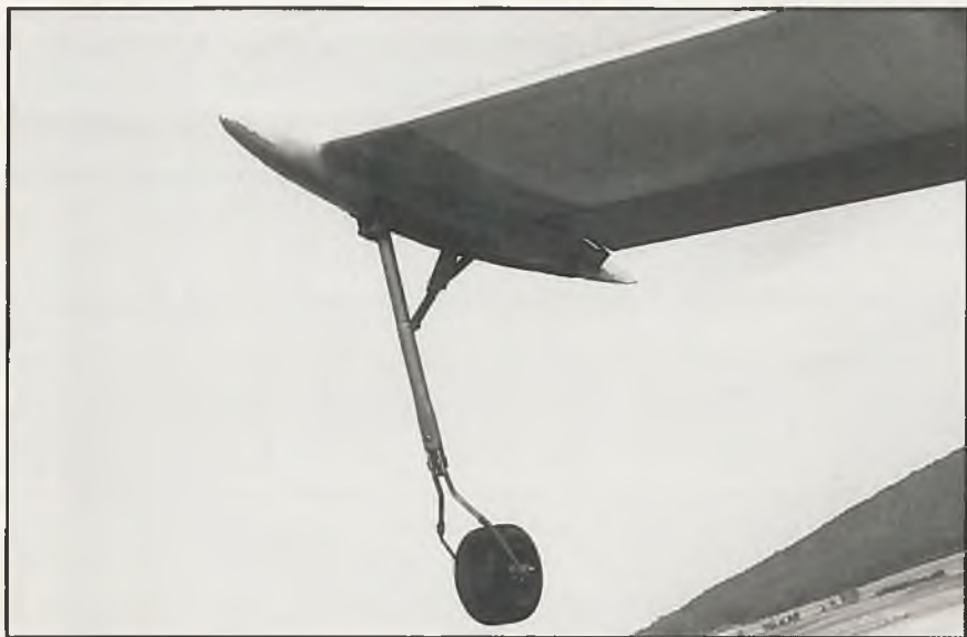
Das Flügel-Stützfahrwerk ist, wie das Hauptfahrwerk, einziehbar
