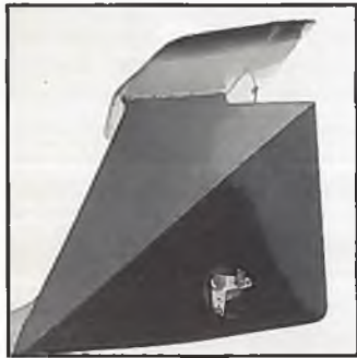
Das Leitwerk kommt mit nur einem Ruder, dem für die Höhe, aus. In der Seitenleitwerksflosse wird entweder das Höhenruderservo oder der Umlenkhebel untergebracht.
