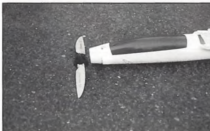
Das Rumpfvorderteil des Kalifs mit der angeformten Hutze um im Inneren für die nötige Kühlung zu sorgen
