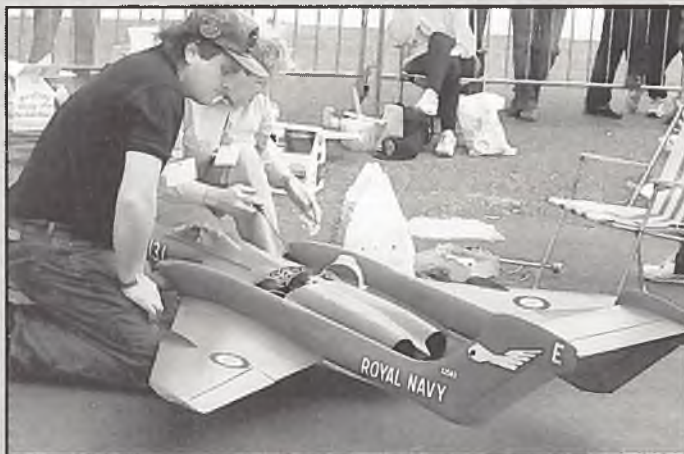
Gleich zwei zweimotorige Modelle hatte Alec Cornish Trestrial aus England mitgebracht: Eine MiG 29 mit zwei OS 25 und diese DH Sea Vixen mit zwei Rossi 65.
