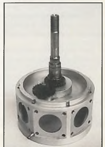
▶ Teilmontiertes Kurbelgehäuse mit Kurbelwelle und Zahnrädern
